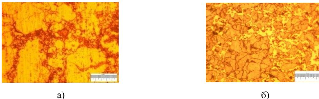
Рис. 1 – Структуры образцов до (а) и после (б) инфильтрации
