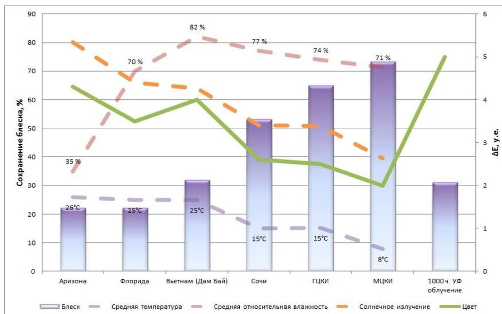
Рис. 3 – Степень сохранения блеска и цвета (ΔE) эмали АС-1115 в климатических зонах: Аризона, Флорида, Москва, Геленджик, Сочи, Якутск в течение 1 года и при воздействии УФ-излучения (1000 ч)
