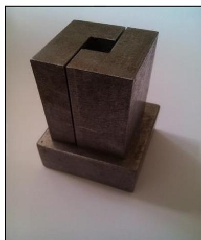
Рис. 4 – Оснастка для измерения предела прочности на сдвиг нахлесточного соединения образцов из SiC
