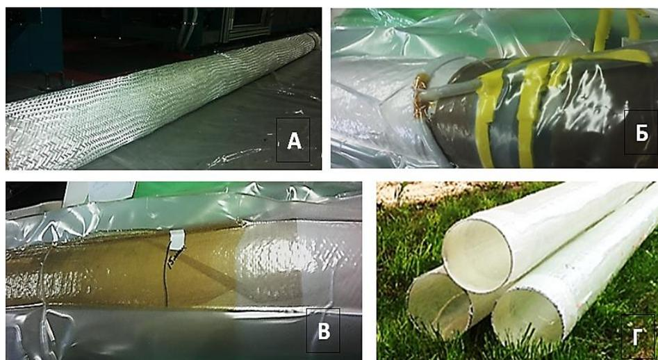
Рис. 3 – Процесс изготовления образцов шпунтовых ограждений круглого сечения
