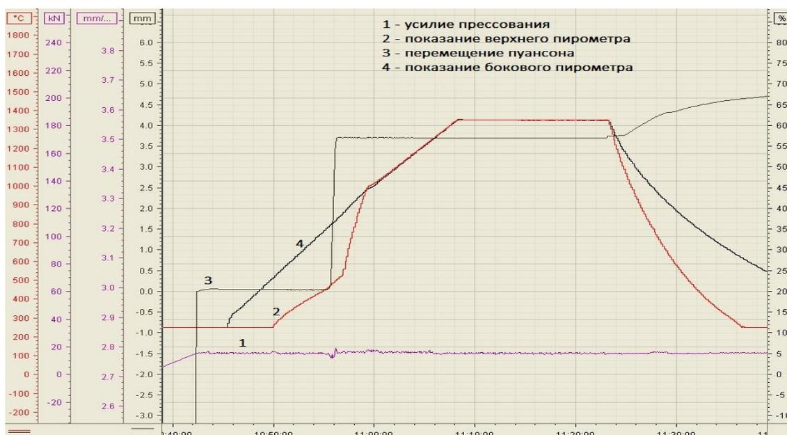
Рис. 11 – Соединение SiC образцов в режиме искрового плазменного спекания (SPS/FAST) с одновременным индукционным нагревом
