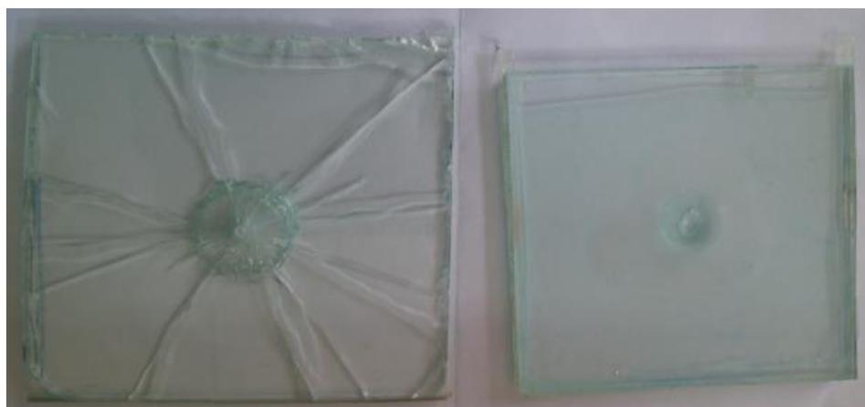
Рисунок 5 – Результаты испытания на удар:
