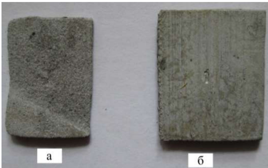
Рис. 4 – Образцы из АМгб после 5 суток выдержки в 40% водном растворе HCl а – без обработки, б – газоимпульсная обработка
