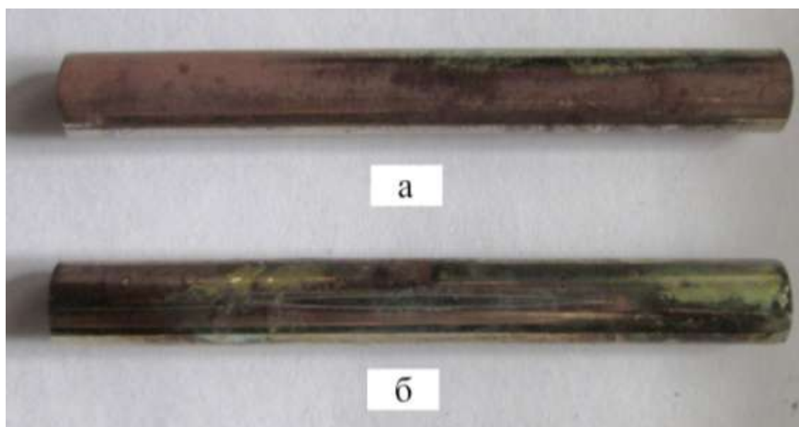
Рис. 5 – Хромированная трубка из латуни Л70 после воздействия агрессивной среды. а – без обработки, б – газоимпульсная обработка
