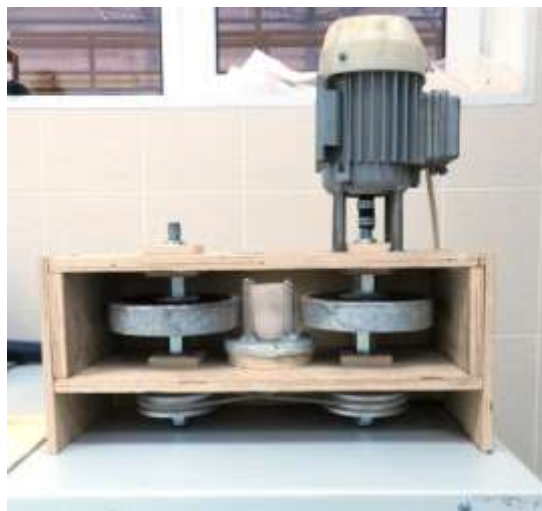
Рис. 1 – Внешний вид установки МГДО расплава алюминиевых сплавов
