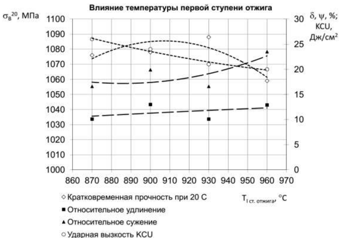
Рис. 5 – Влияние температуры первой ступени послесварочного отжига на характеристики механических свойств при 20°C материала поковки типа «блиск» из сплава ВТ41
