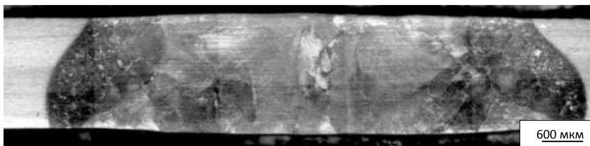
Рис. 1 – Структура сварного соединения ВТ23, электронно-лучевая сварка
