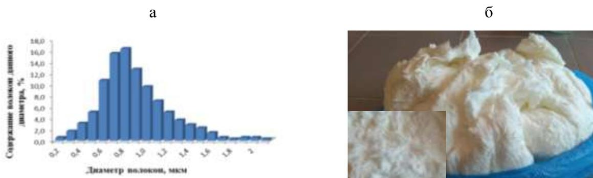
Рис. 1 – Волокна оксида циркония: (а) – гистограмма распределения волокон по диаметру; (б) – внешний вид волокон
