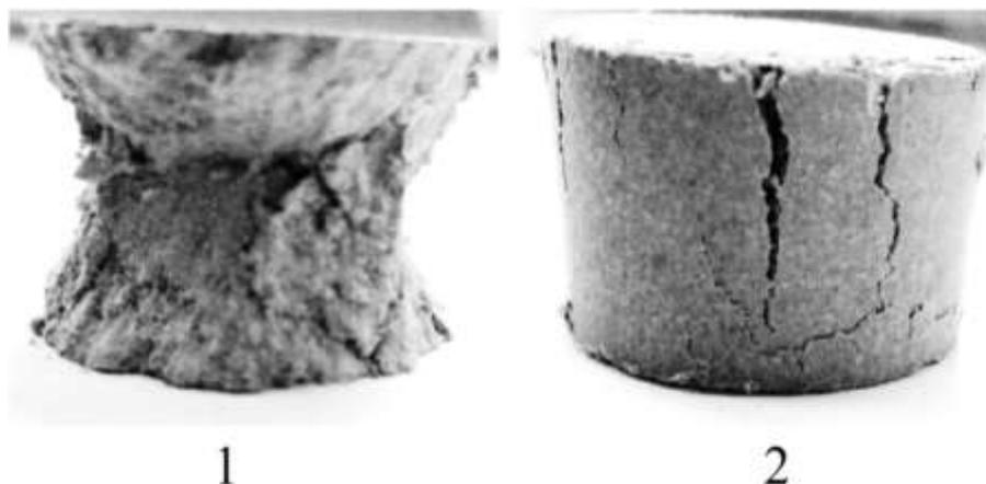
Рис. 5 – Образцы композиций с 16 % жидкого стекла из асбеста А 7 после испытаний на сжатие, полученных спеканием в печи: 1. Муфельной при 300°C; 2. СВЧ
