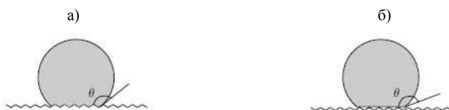
Рис. 1 – Гомогенный (а) и гетерогенный (б) режимы смачивания на шероховатой подложке
