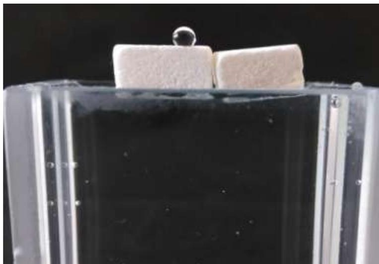
Рис. 8 – Изображение образцов гидрофобного композиционного материала в кювете с водой
