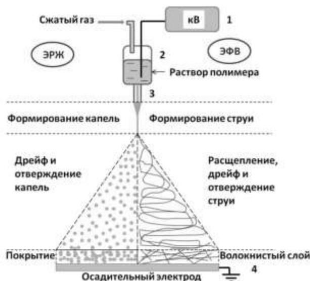
Рис. 1 – Схема установки электроформования:
