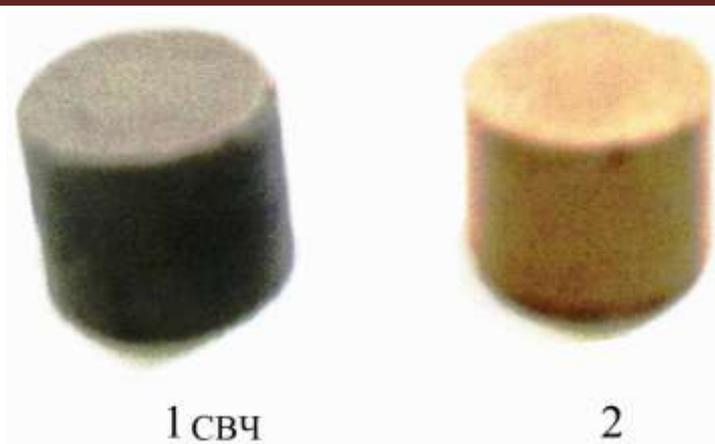
Рис. 6 – Образцы из композиции с 16 % жидкого стекла из золы Ново-Иркутской ТЭЦ после термообработки в печи: 1. СВЧ; 2. Муфельной.
