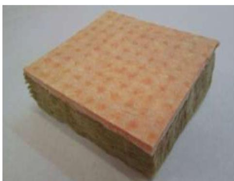
Рис. 2 – Двухслойный гибкий пожаро-безопасный материал ВТИ-25 на основе кремнеземного волокна
