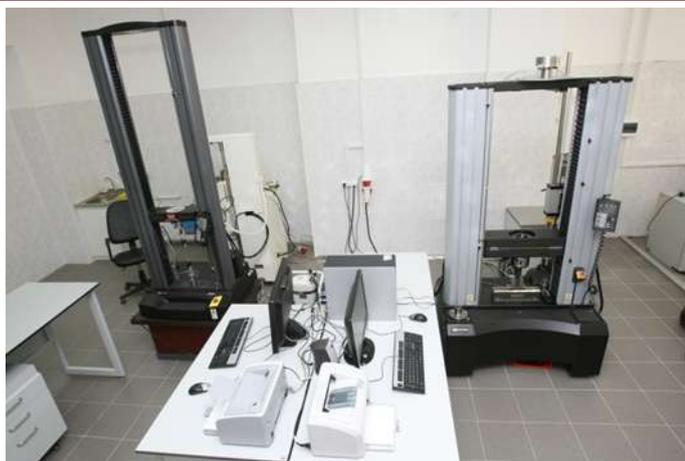
Рис. 1 – Оборудование для проведения механических испытаний
