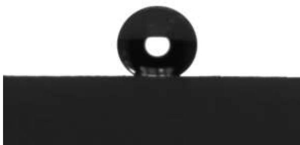
Рис. 7 – Изображение капли воды на поверхности гидрофобного композиционного материала
