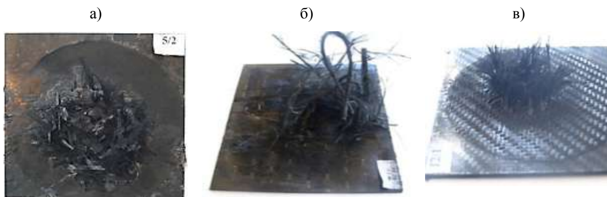
Рис. 3 – Углепластики после воздействия токов молнии с параметрами I=200 кА, Q=20 Кл: а) на основе углеродного наполнителя фирмы Porcher арт. 2009 и связующего ЭНФБ-2м; б) на основе углеродного наполнителя фирмы Porcher арт.4510 и связующего ЭНФБ-2м; в) на основе углеродного наполнителя фирмы Porcher арт.3692 и связующего ЭНФБ-2м
