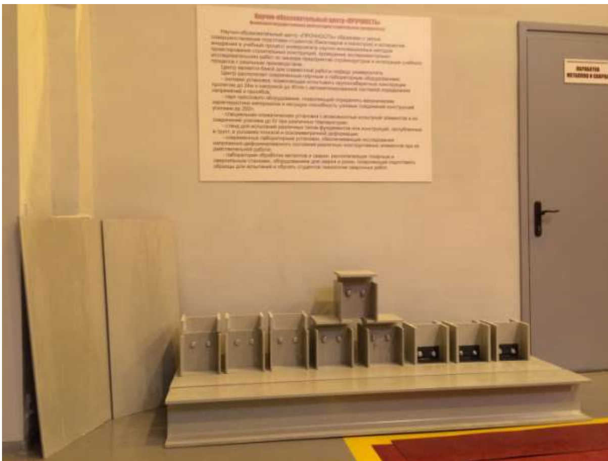
Рис. 6. - Образцы для испытаний балки, листа и узловых соединений из пултрузионных стеклопластиковых профилей
