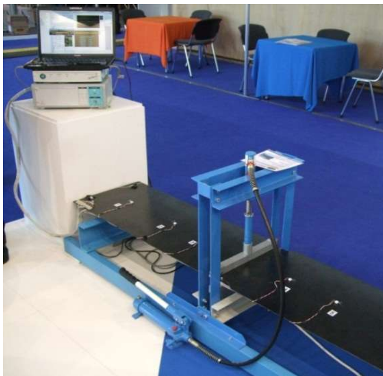
Рис. 4 – Демонстратор системы определения деформации материала конструкции из ПКМ с использованием интегрированных ВБР (на примере фрагмента верхней панели из углепластика ВКУ-47И центроплана самолета Ту-204СМ)
