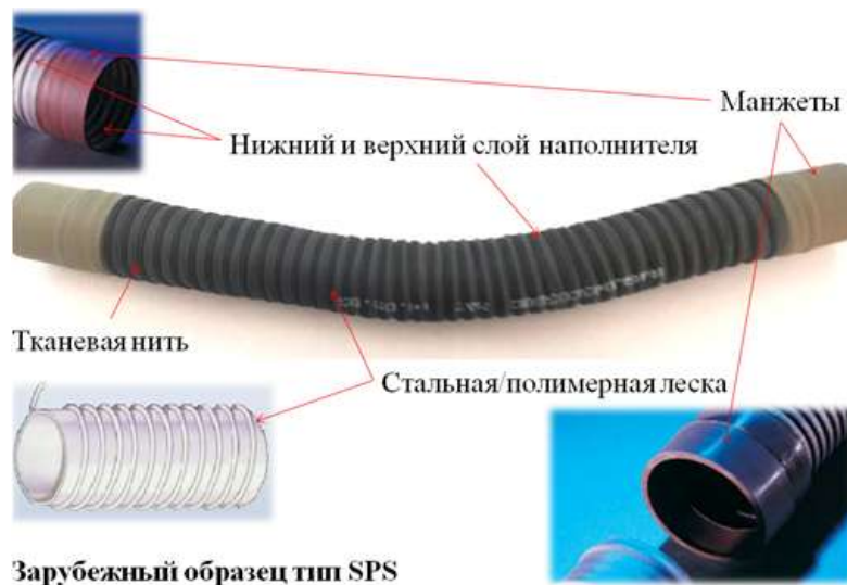
Рис. 6 – Типовая конструкция гибкого элемента СКВ
