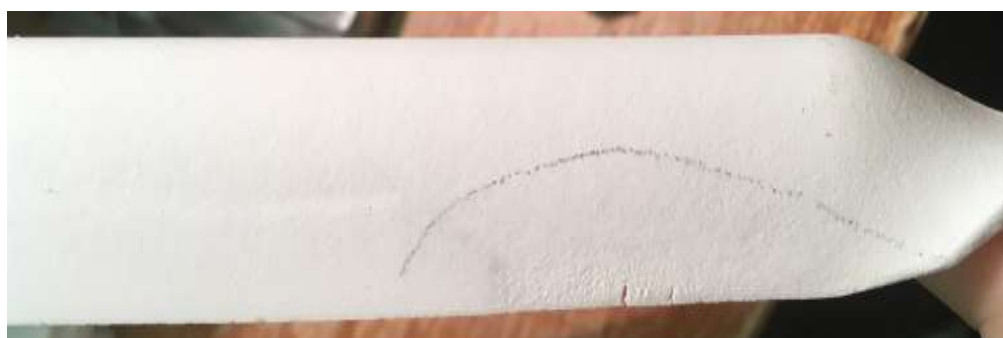
Рис. 3 – Образование повышенной шероховатости после обжига
