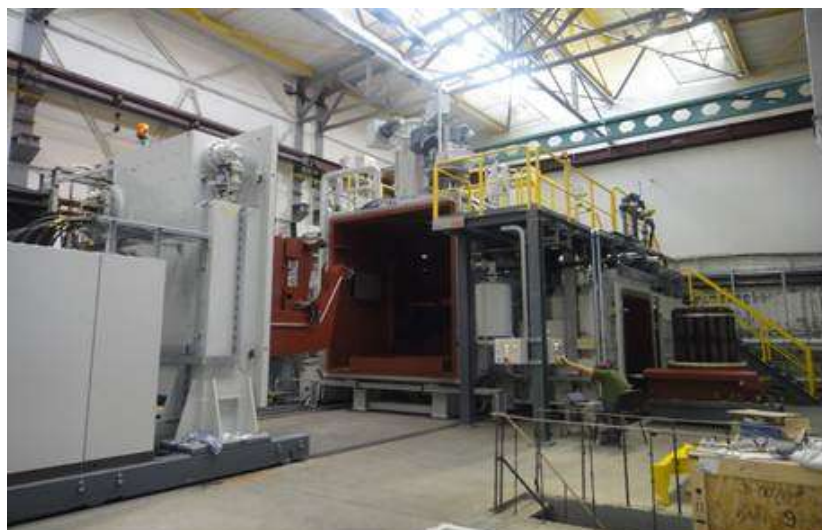
Рис. 9 – Вакуумная индукционная печь VIM-150 с емкостью тиглей 650–1000 кг
