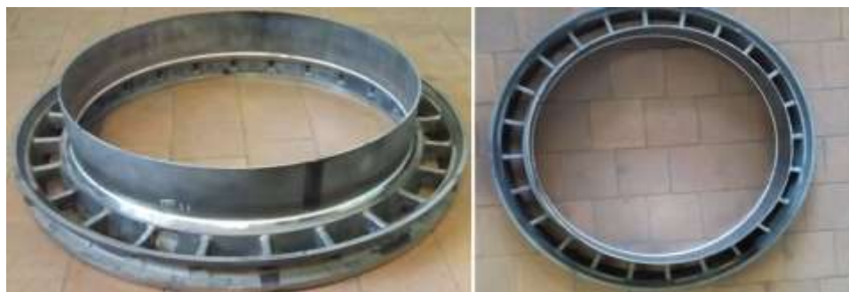
Рис. 15 - Внешний вид сварного соединения отливки детали диффузор из сплава ВЖ172Л и листовой обечайки из сплава ВЖ172, выполненного ЭЛС
