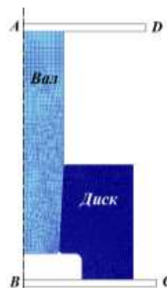
Рис. 2. Конечно-элементная модель детали «диск-вал». Линия АВ является осью симметрии. Перемещение задается через траверсу, обозначенную как АД. Траверса ВС неподвижна
