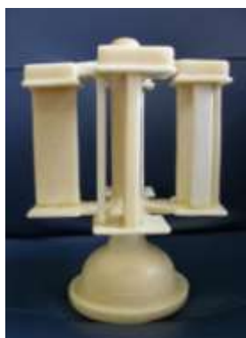
Рис. 6 - Форма для исследования склонности к горячим трещинам, полученная отливка и исследуемые критические зоны
