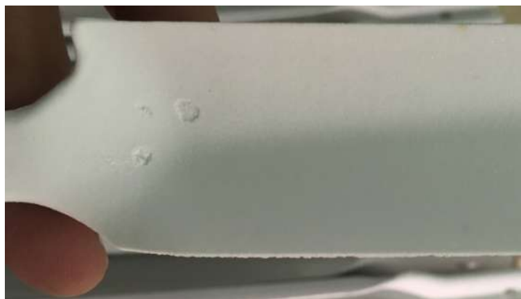
Рис. 4 – Вспучивание участков стержня после обжига
