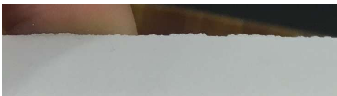
Рис. 5 – Некачественная выходная кромка стержня после обжига
