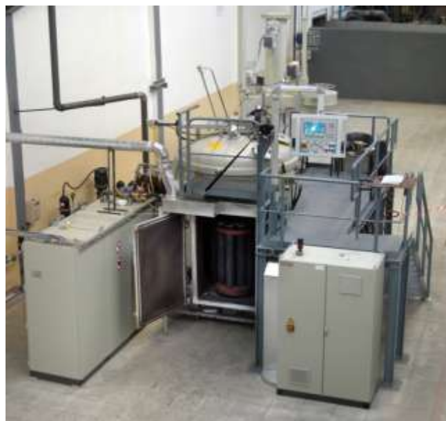
Рис. 8 – Вакуумная индукционная печь VIM-50 с емкостью тигля 350 кг
