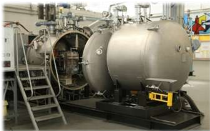
Рисунок 1 – УВНС-6 – промышленная высокоградиентная установка (градиент до 200 °С/см) для литья деталей длиной до 300 мм с монокристаллической структурой
