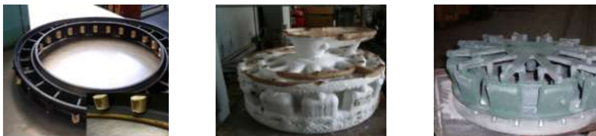
Рис. 10 - Внешний вид модели, керамической формы и отливки детали «диффузор» диаметром 480 мм из сплава ВЖ172Л
