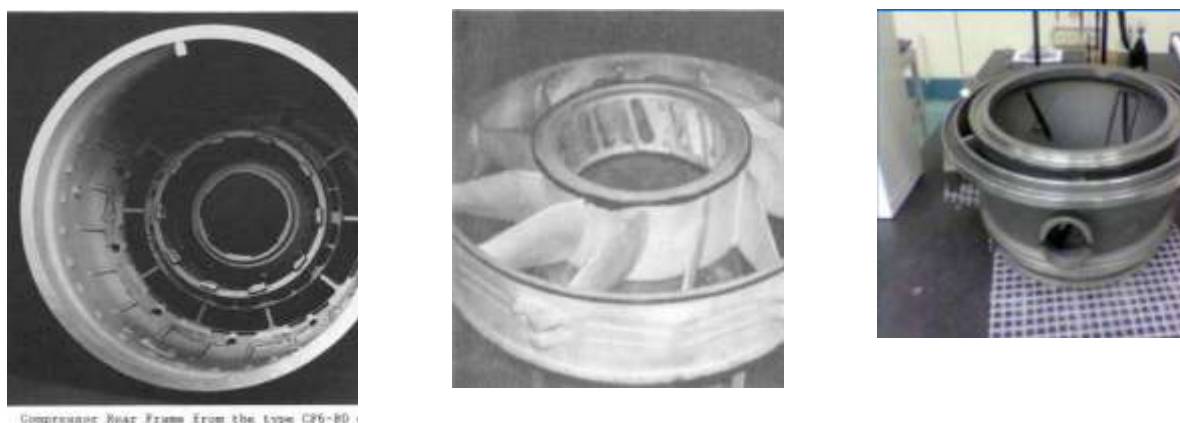
Рис. 2 – Крупногабаритные отливки деталей статора: задний корпус КВД, опоры турбин
