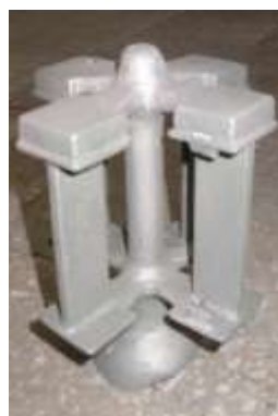
Рис. 6 - Форма для исследования склонности к горячим трещинам, полученная отливка и исследуемые критические зоны
