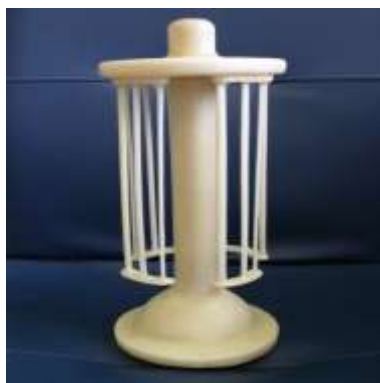
Рис. 5 – Вертикальная проба Чикеля-Нехендзи для исследования жидкотекучести
