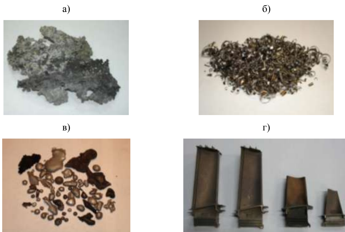
Рис. 2 – Некондиционные отходы литейных жаропрочных сплавов: а) гарнисаж с тигля после плавки; б) стружка после механической обработки; в) сплесы и корольки после разливки; г) лопатки, отработавшие свой ресурс
