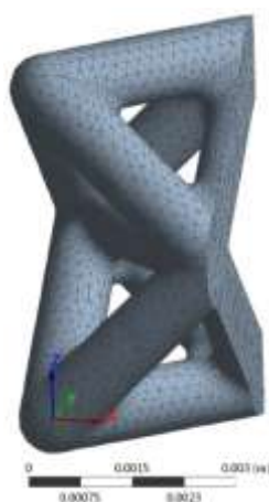
Рис. 4 – КЭ объемная модель одной четверти элементарной ячейки периодичности
