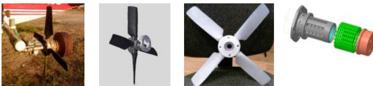
Рис. 4 – Изготовленные детали ВРЖ методом FDM
