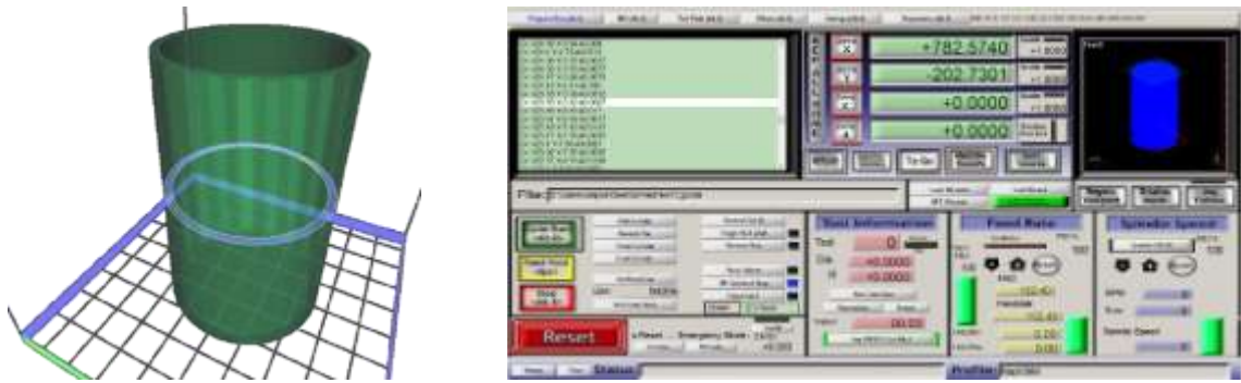
Рис. 3 – Трехмерная модель патрубка в программе KISSlicer и загрузка G- Code в программу Mach3
