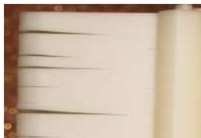
Рис. 2 – Расслоение (деламинация) материала
