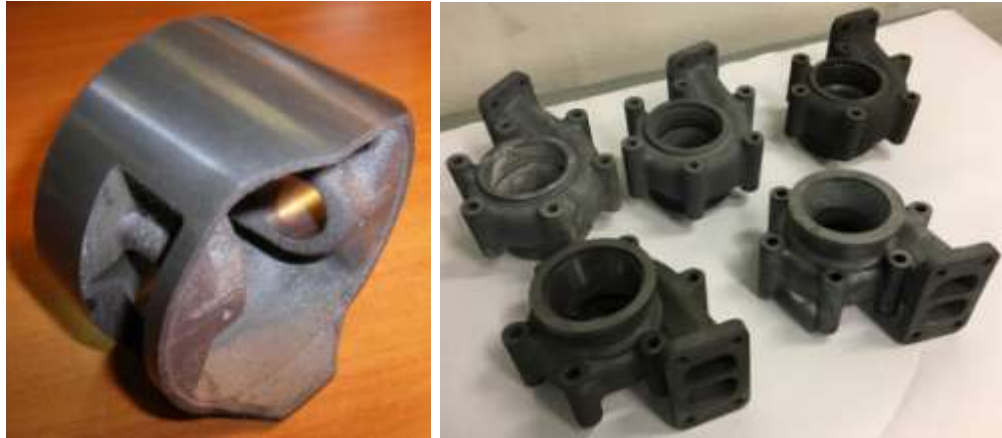
Рис. 3 – Кероматричный поршень и крупноразмерные корпуса турбин системы турбонаддува со сложной формой внутренней поверхности
