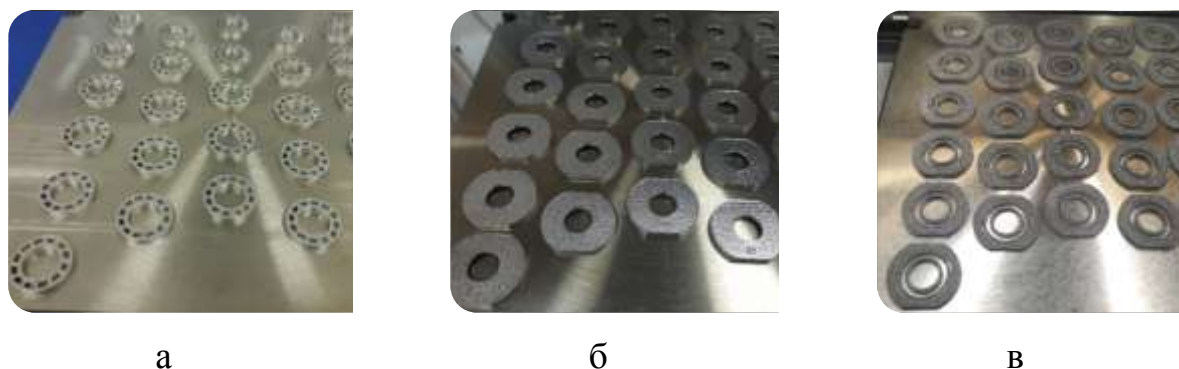
Рис. 2 – Фрагменты лопаток (а), основного материала с простой геометрией и постоянного сечения (б) и поддержек (в), выращенные на платформе построения
