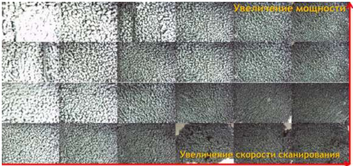
Рис. 2 – Изображения микроструктуры материала в зависимости от изменения мощности и скорости сканирования лазерным лучом
