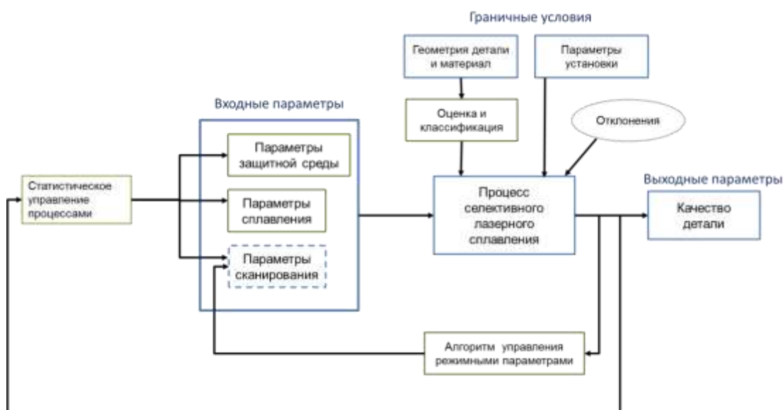
Рис. 2 – Система управления качеством СЛС
