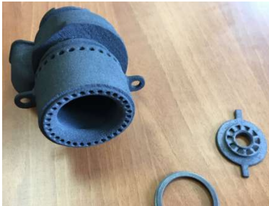
Рис. 2 – Тонкостенное изделие сложной формы с внутренними полостями, выполненное методом аддитивной технологии, как одна деталь (форсунка камеры сгорания)
