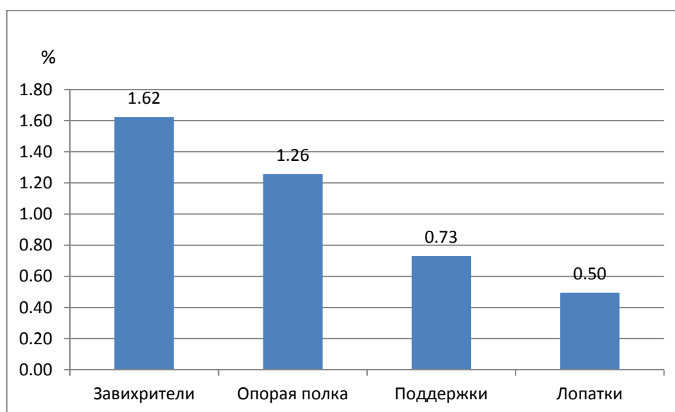
Рис. 5 – Количество отсевов оборотного порошка ВЖ159, значения даны в процентах
