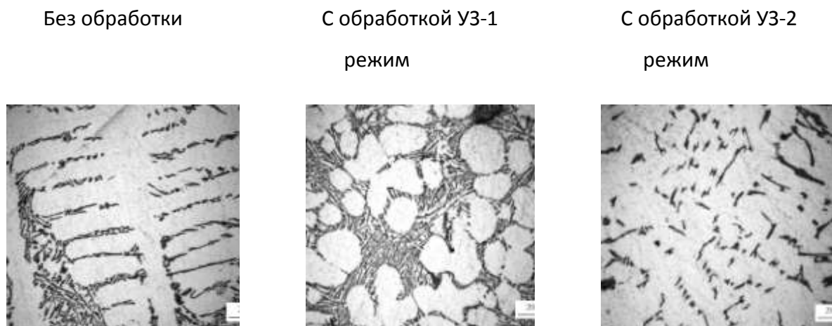
Рис. 5 – Характерные структуры алюминия, обработанные по различным режимам
