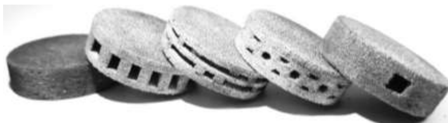
Рис. 6 – Фотография образцов с различными внутренними структурами
