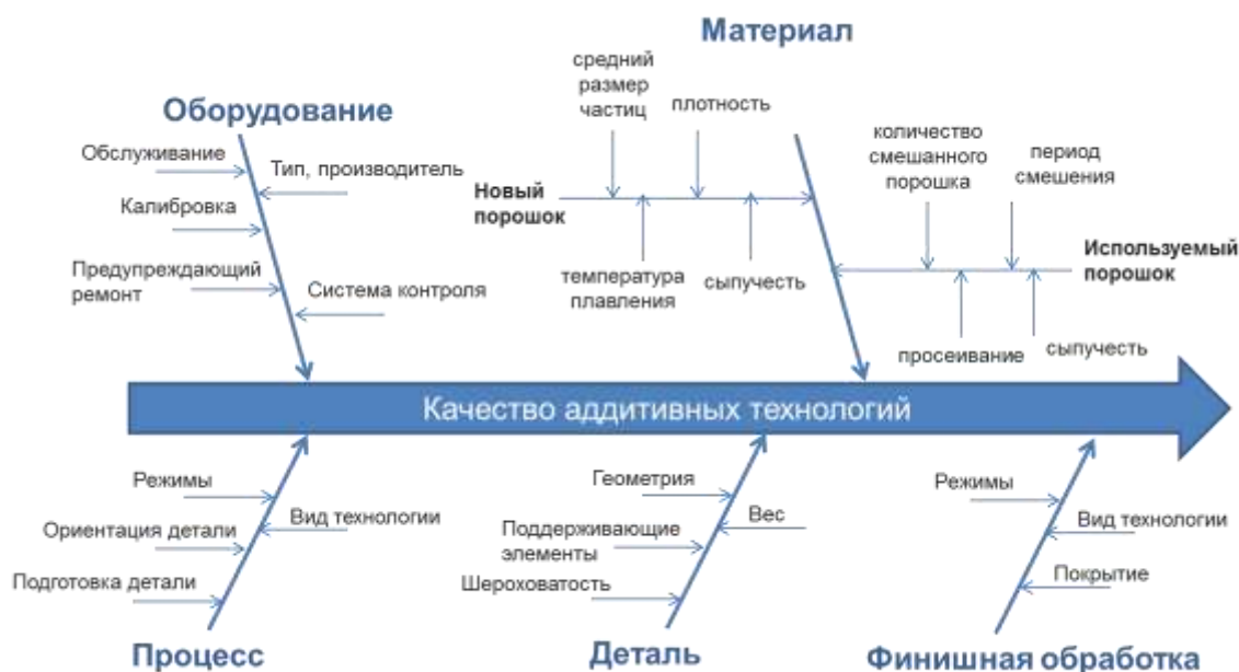
Рис. 1 – Влияние параметров производственного процесса на качество, диаграмма Исикавы
