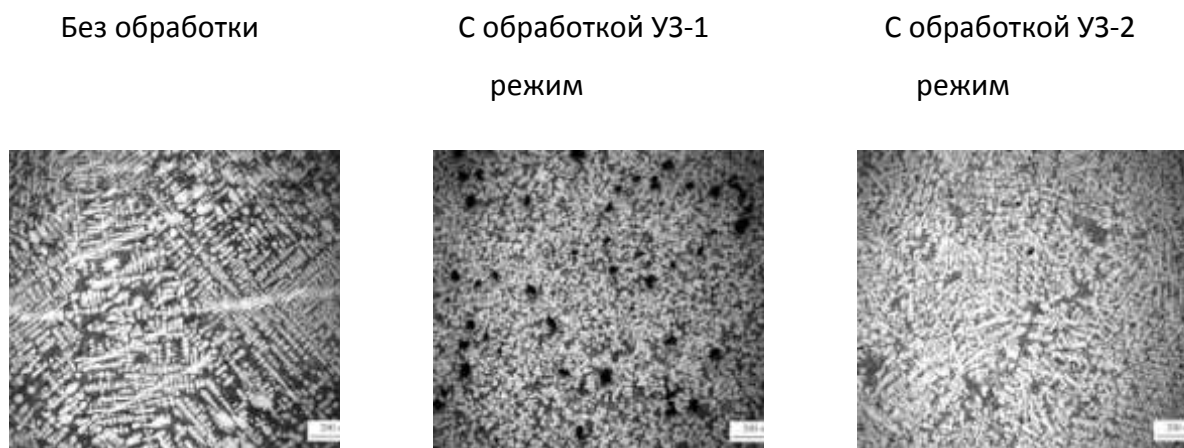
Рис. 4 – Структура подприбыльной части отливки
