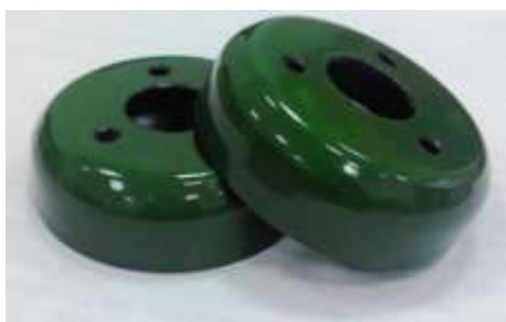
Рис. 4 – Изделие типа «чашка» из стали 12Х18Н10Т со стеклокерамическим покрытием
