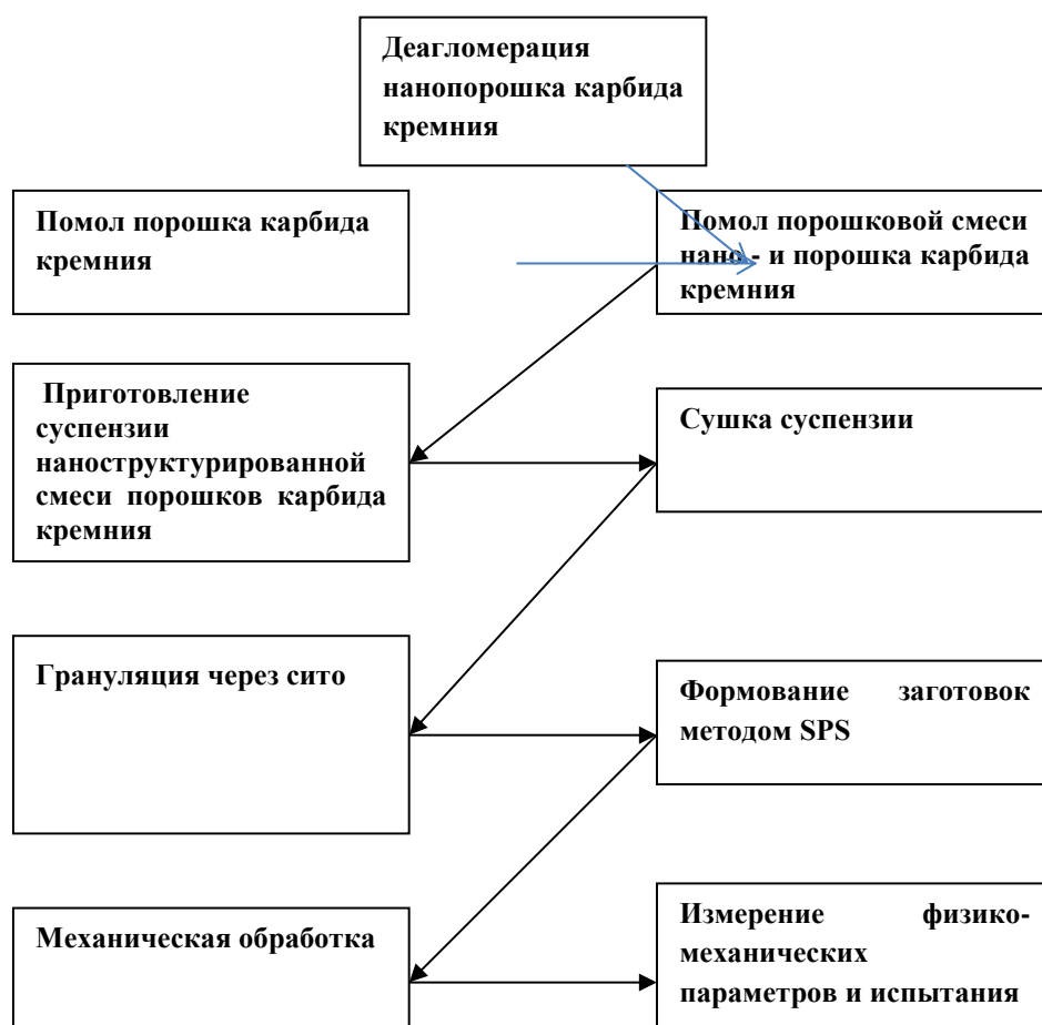
Рис. 1 – Технологическая схема изготовления образцов SiC из смеси порошка и нанопорошка SiC
