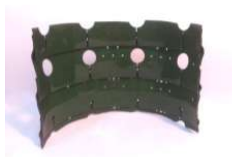
Рис. 5 – Фрагмент детали из сплава ВЖ 171 со стеклокерамическим покрытием
