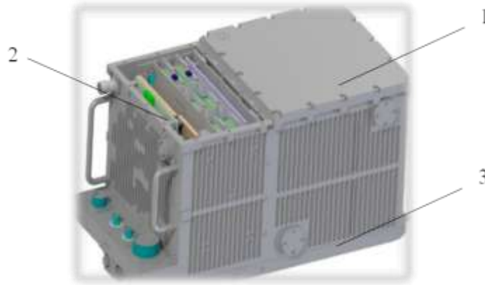
Рис. 1 – Пример БИНС: 1 – блок чувствительных элементов; 2 – блок электроники; 3 – корпус
