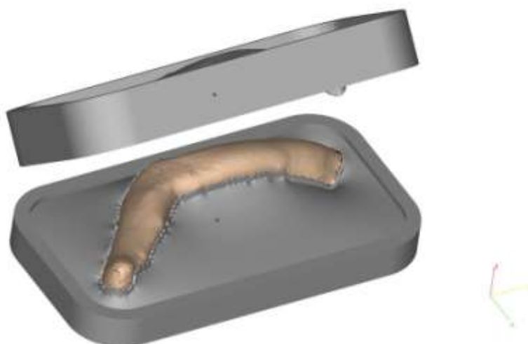
Рис. 3 – 3D модели формообразующих пресс-форм применяющиеся для изготовления биоимплантата
