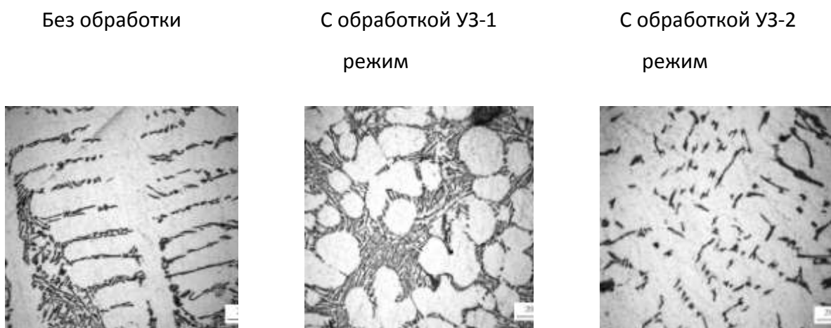
Рис. 5 – Характерные структуры алюминия, обработанные по различным режимам
