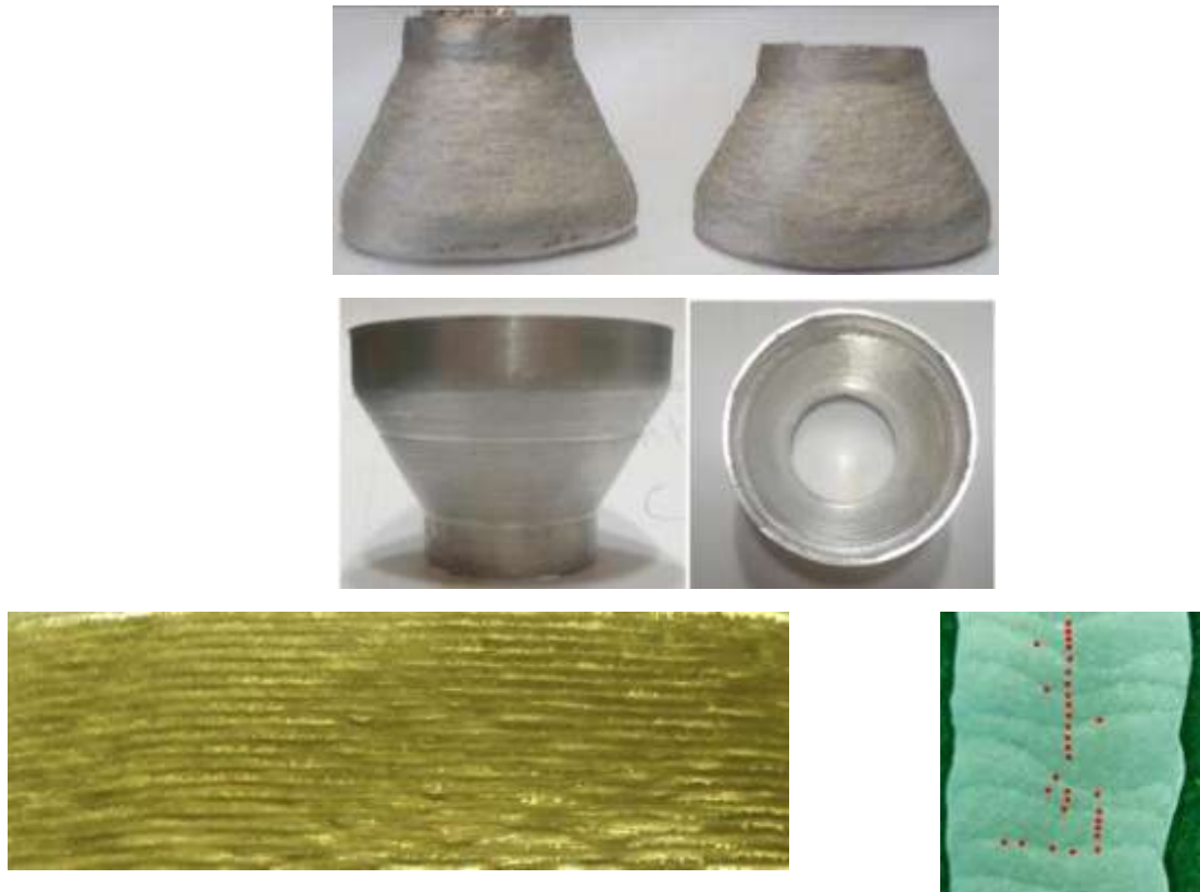
Рис. 7 – Патрубки из сплава АМг5 полученные по аддитивной технологии дуговой наплавкой до и после мехобработки. Диаметр 35–60 мм, толщина стенки 5 мм.
