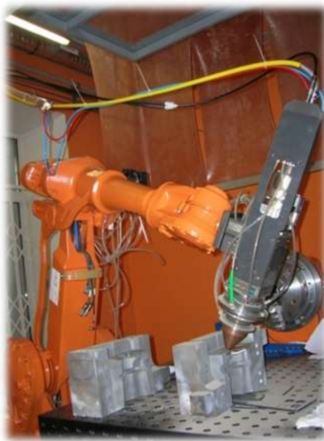
Рисунок 2 – Робот-манипулятор с технологической головкой для коаксиальной лазерной наплавки
