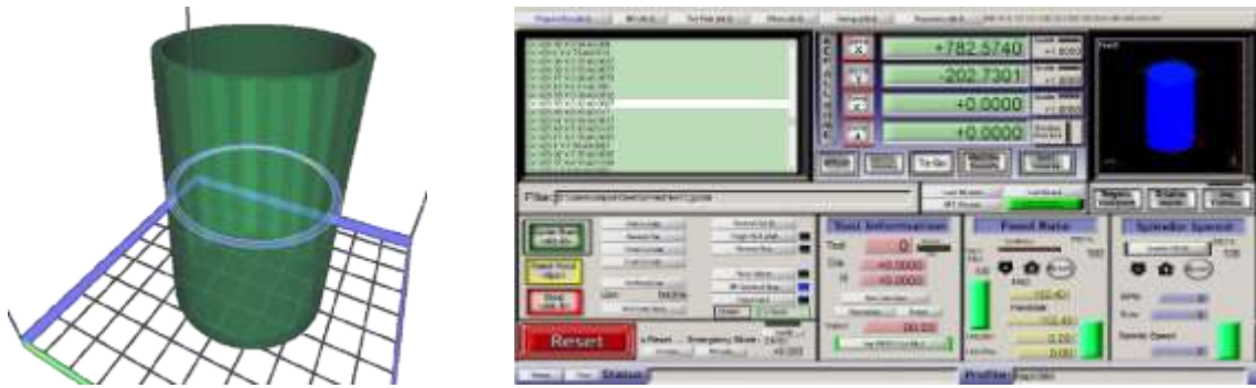
Рис. 3 – Трехмерная модель патрубка в программе KISSlicer и загрузка G- Code в программу Mach3
