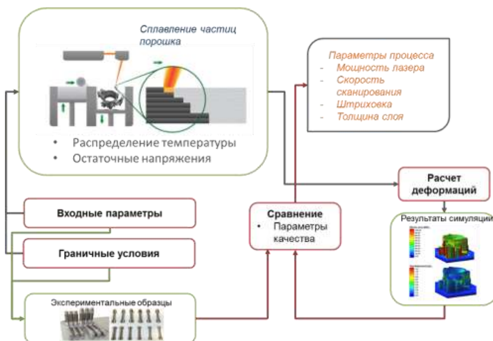
Рис.3 – Механизм взаимодействия параметров производственной системы и качества
