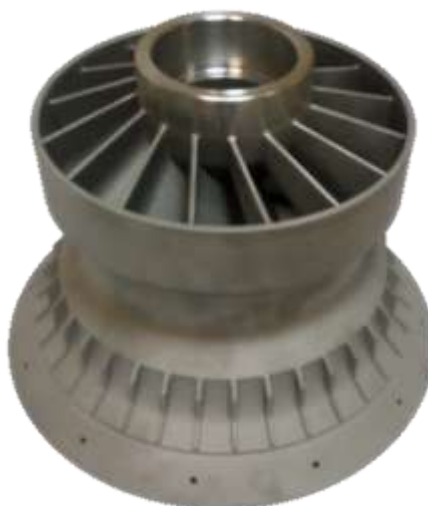
Рис. 6 – Центральный завихритель, изготовленный с применением АТ
