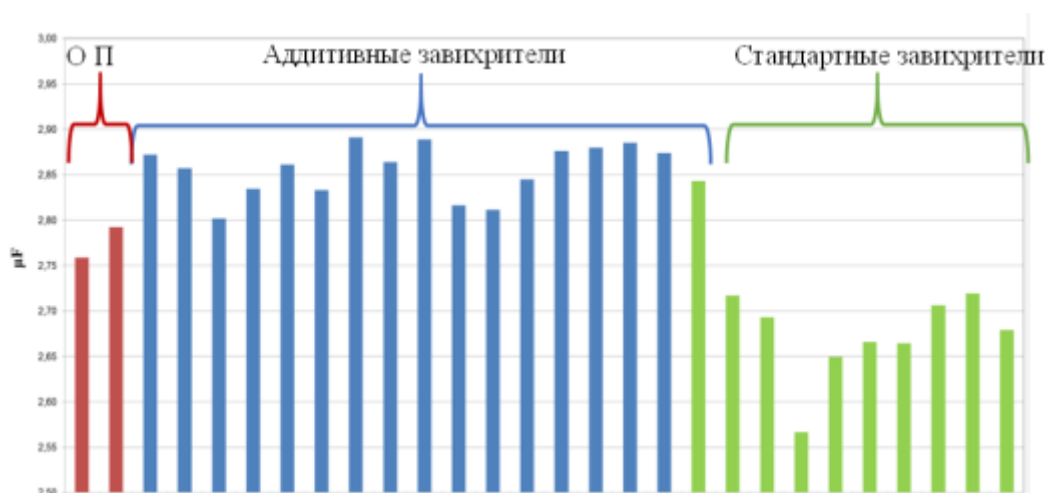
Рис. 3 – Результаты определения расходных характеристик завихрителей
