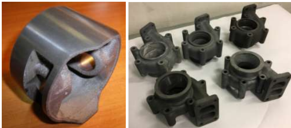
Рис. 3 – Кероматричный поршень и крупноразмерные корпуса турбин системы турбонаддува со сложной формой внутренней поверхности
