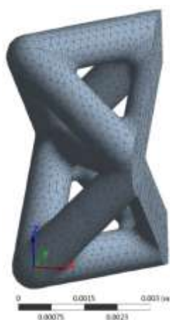
Рис. 4 – КЭ объемная модель одной четверти элементарной ячейки периодичности
