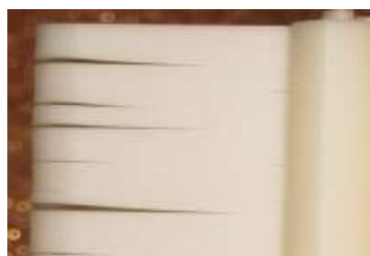
Рис. 2 – Расслоение (деламинация) материала
