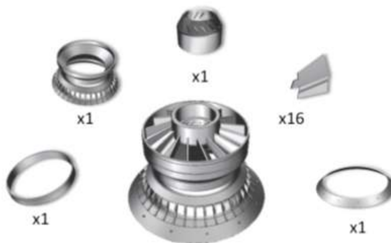
Рис. 5 – Центральный завихритель и входящие в его состав ДСЕ
