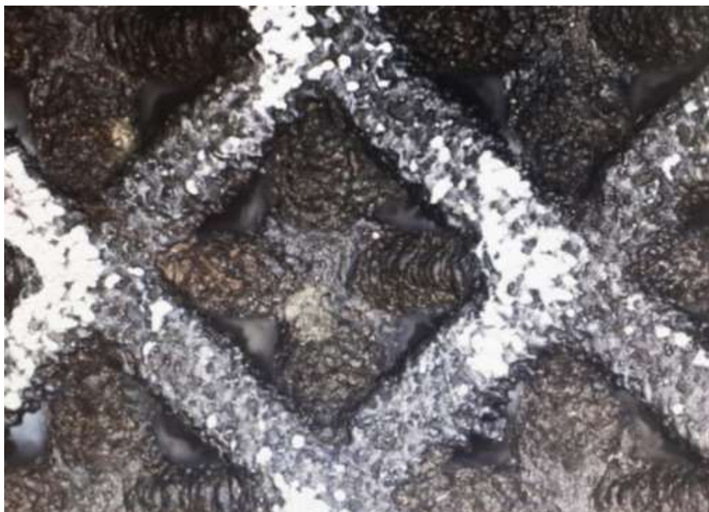
Рис. 3 – Элементарная ячейка периодичности образца сетчатой конструкции
