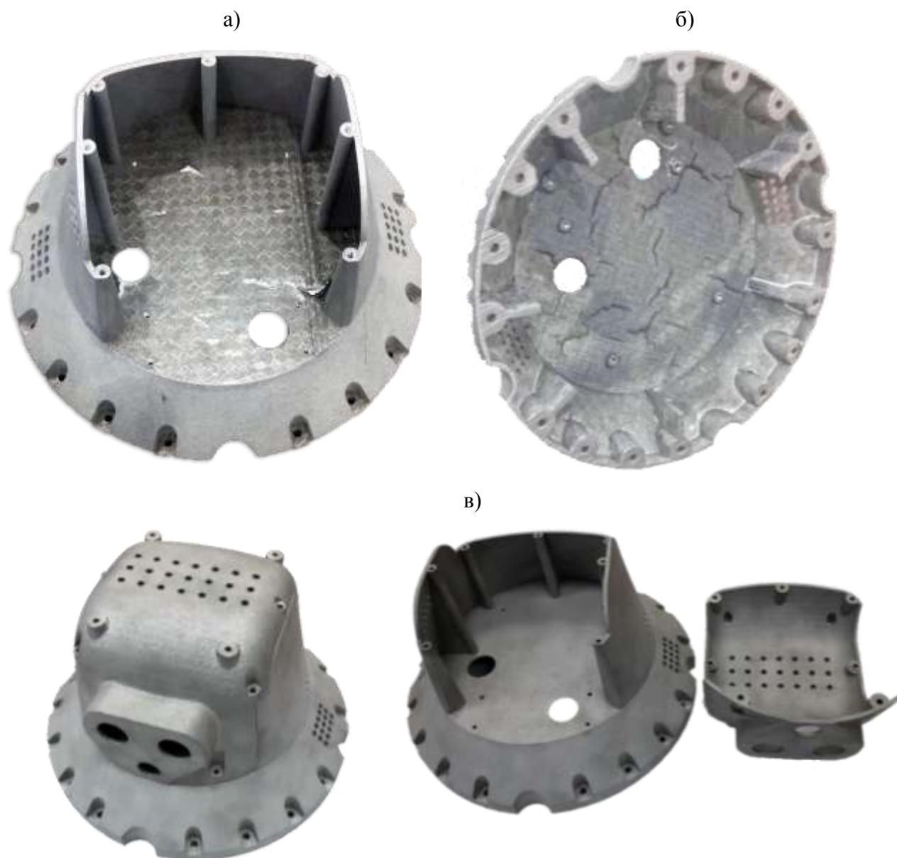
Рис. 6 – Детали корпуса электроники V2 из алюминиевого сплава; а) – дефектная деталь, вид сверху; б) – дефектная деталь, вид снизу; в) – годные детали
