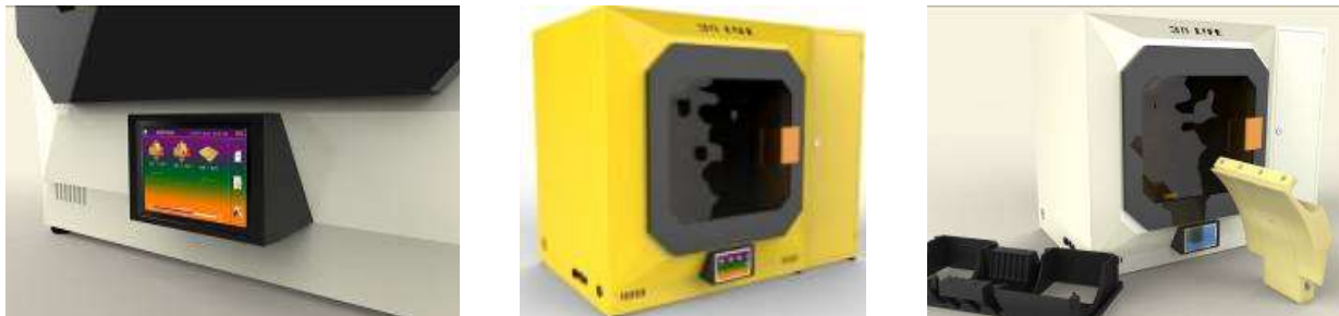
Рис. 5 – 3D-принтер 3D LIFE с термостатичной камерой (концепт)
