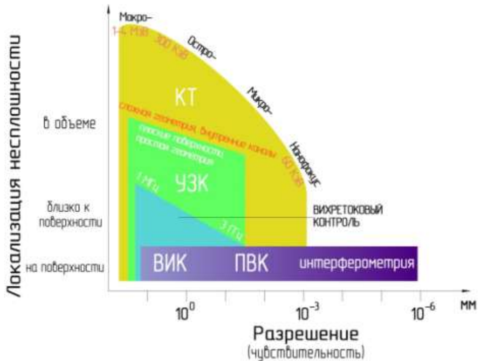
Рис. 1 – Сравнение возможностей методов НК по критерию разрешающей способности в зависимости от местоположения дефекта [7]
