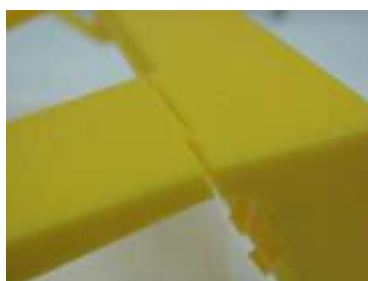
Рис. 1 – Трещины и разрушение
