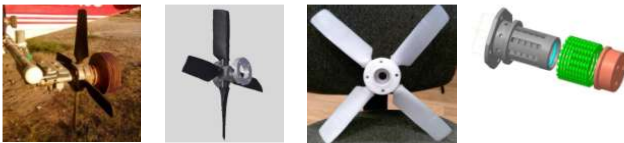
Рис. 4 – Изготовленные детали ВРЖ методом FDM
