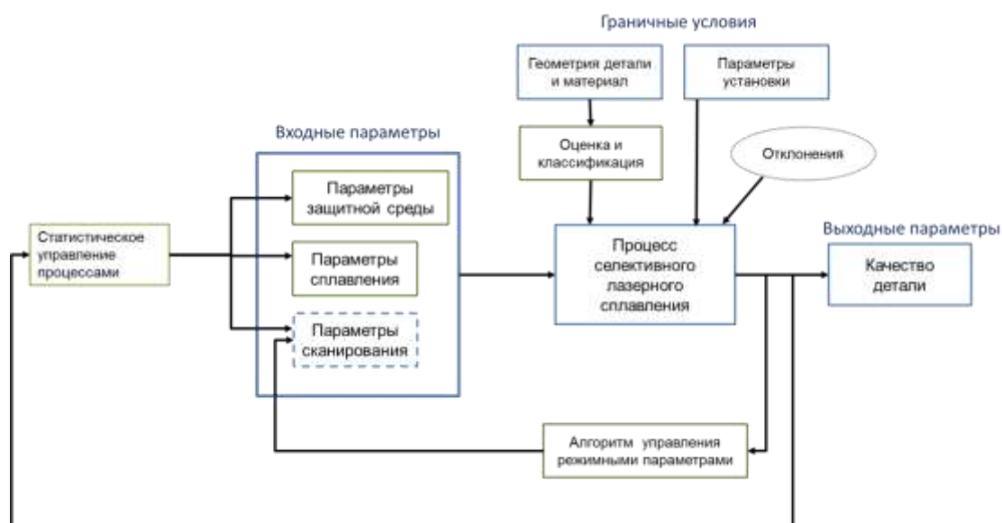
Рис. 2 – Система управления качеством СЛС
