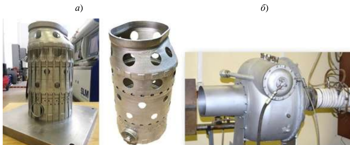
Рис. 1 – Жаровая труба камеры сгорания малоразмерного ГТД: а – результат изготовления методом СЛС, б – стендовые испытания жаровой трубы
