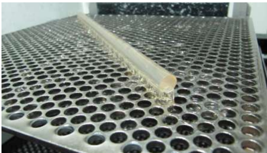
Рис. 1 – Тест объект из новой смолы, цилиндр 250×8 мм
