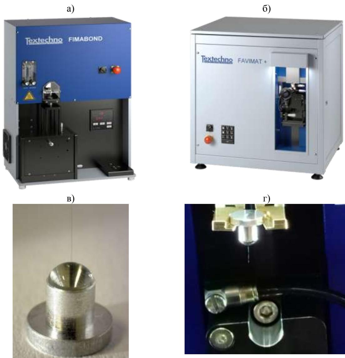
Рис. 1 – Общий вид машины для изготовления образцов Textechno Fimabond (а), машины для проведения испытаний Textechno Favimat + (б), фото образца для испытаний методом pull-out после его изготовления (в) и после его установки в разрывную машину Textechno Fimabond (г)
