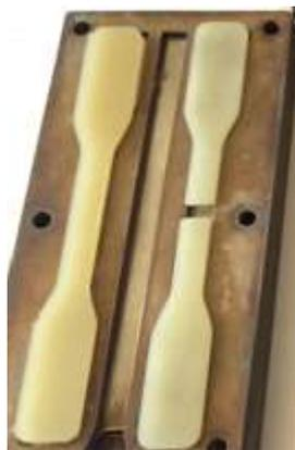
Рис. 2 – Фотография открытой формы для изготовления образцов из полимерных связующих
