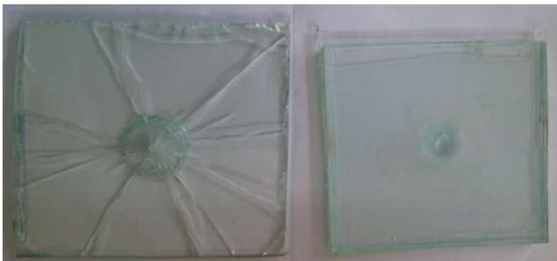
Рис. 5 – Результаты испытания на удар.
