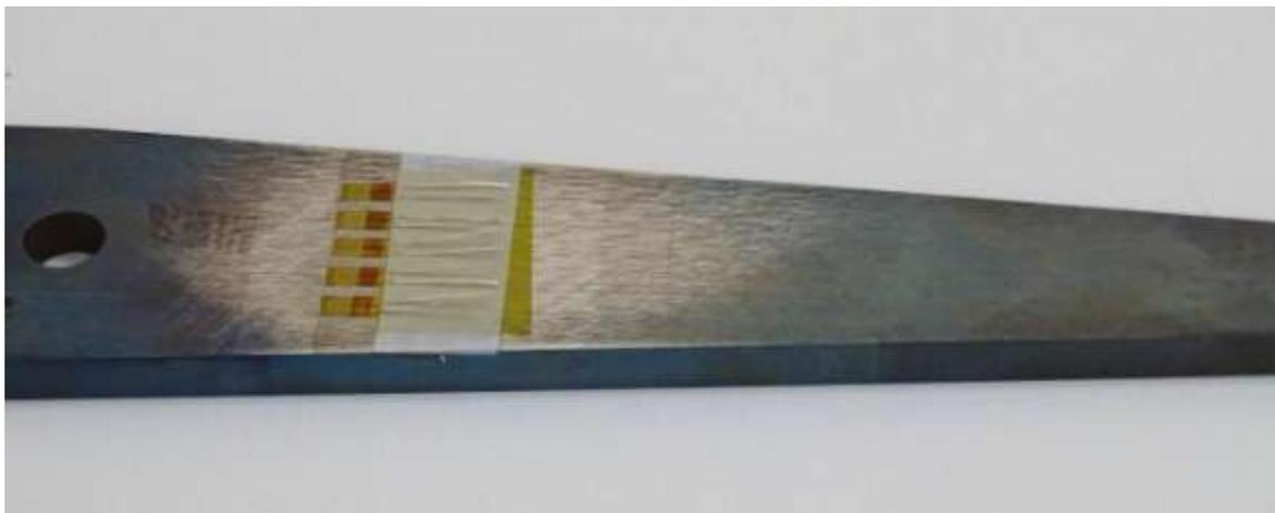
Рисунок 1 - Измерительная балка с установленными на нее тензорезисторами для проверки характеристик
