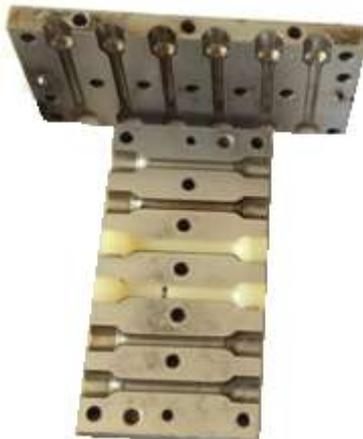
Рис. 3 – Фотография закрытой формы для изготовления образцов из полимерных связующих
