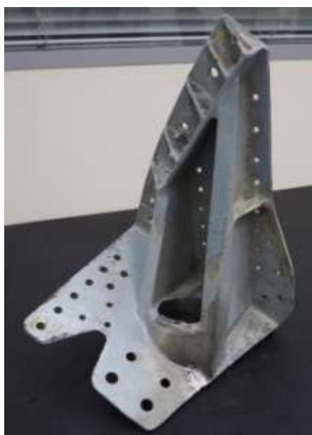
Рис. 12 – Внешний вид кронштейна № 81.0318.1001.900 навески ООШ
