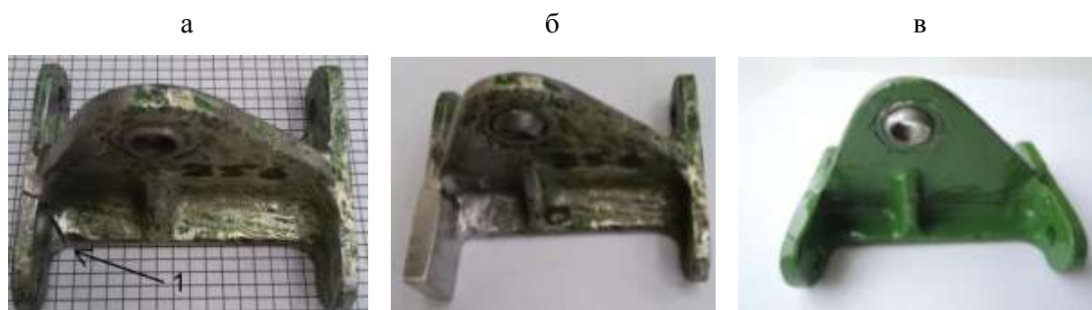
Рис. 5 – Внешний вид кронштейна самолета СУ-25 81.5102.0385.001 до и после ремонтного восстановления методом лазерной сварки: а – при поступлении в ремонт (1 – место излома проушины), б – после лазерной сварки, в – после механической обработки и последующей покраски
