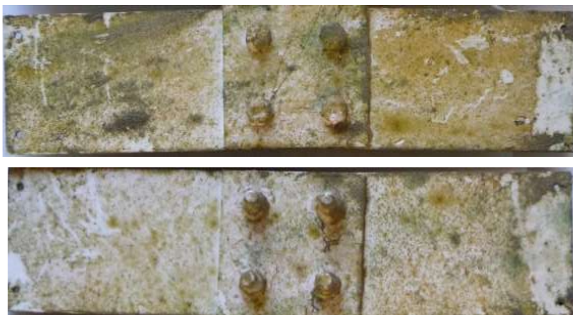
Рис. 2 – КПО «АМг6+ОТ4» после 1 года испытаний в морской воде
