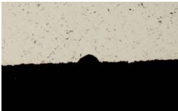
Рис. 9 – Местная коррозия сплава АМг6 глубиной 0,05 мм в зоне, свободной от сопряжения
