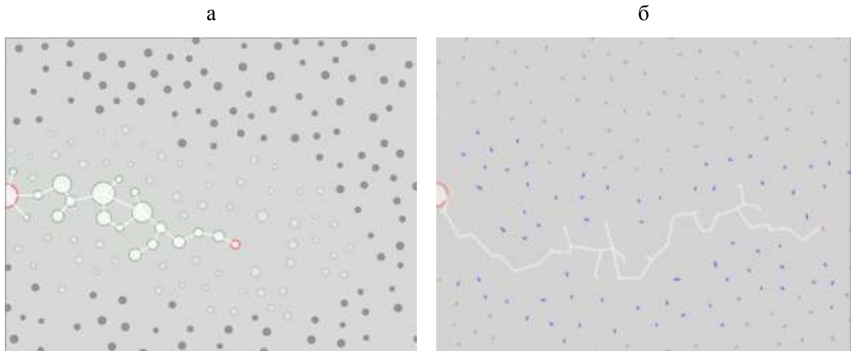
Рис. 6 – Примеры визуализации роста трещин с различной конфигурацией начальных дефектов, реализованные на Java script
