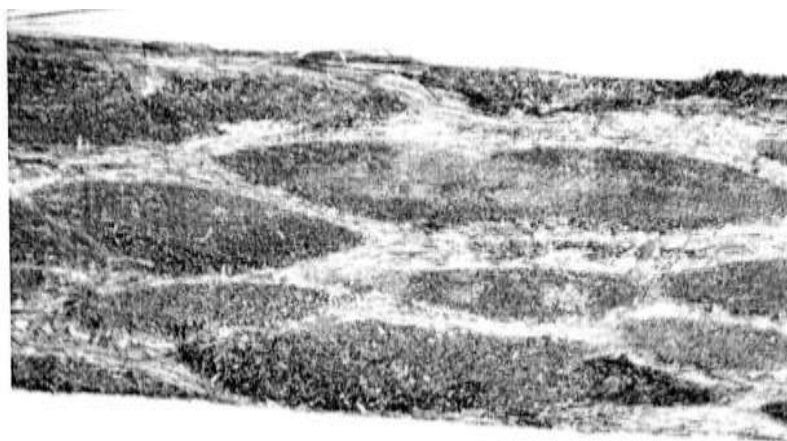
Рис. 7 – Углеродный композит на срезе после прессования с предварительной модификацией волокнистого наполнителя.
