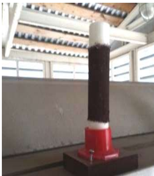
Рис. 4 – Экспозиция сульфатного цилиндра под навесом МЦКИ для определения количества диоксида серы в атмосфере
