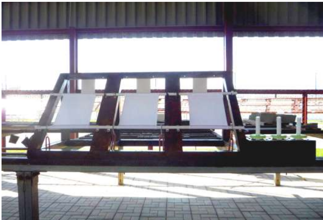
Рис. 1 – Экспозиция пробоотборников под навесом ГЦКИ для определения количества хлоридов и диоксида серы в атмосфере
