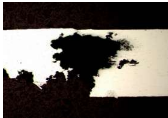
Рис. 10 – Межкристаллитная коррозия сплава Д16Т (сквозная) в зоне сопряжения поверхностей
