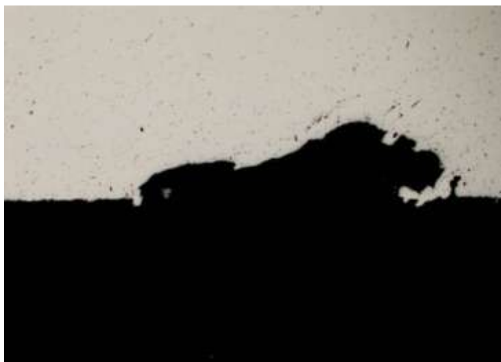
Рис. 11 – Местная коррозия стали 08X17 глубиной 0,4 мм в зоне сопряжения поверхностей
