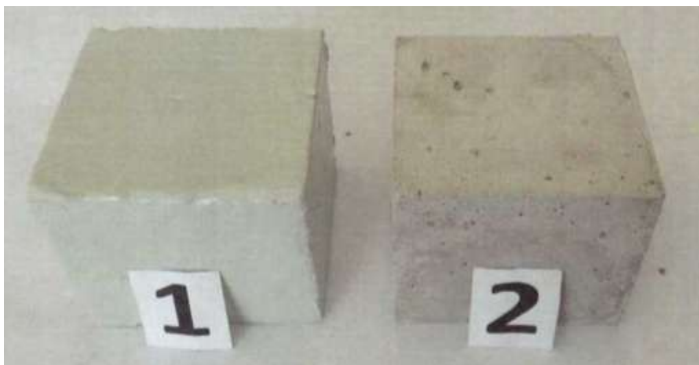
Рис. 1 – Вид бетонных образцов-кубов, перед испытанием на морозостойкость: 1. С покрытием системы ЭКО; 2. Без покрытия
