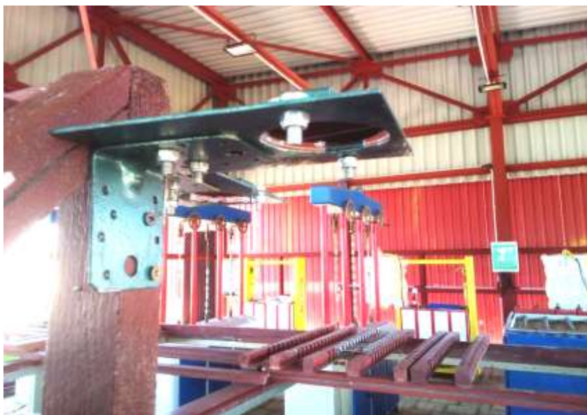
Рис. 3 – Экспозиция сульфатной чашки для определения количества диоксида серы в атмосфере
