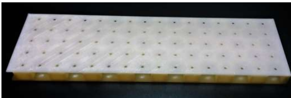
Рис. 4 – Модельный образец складчатой ЗПК, изготовленный методом 3D печати из ABS пластика
