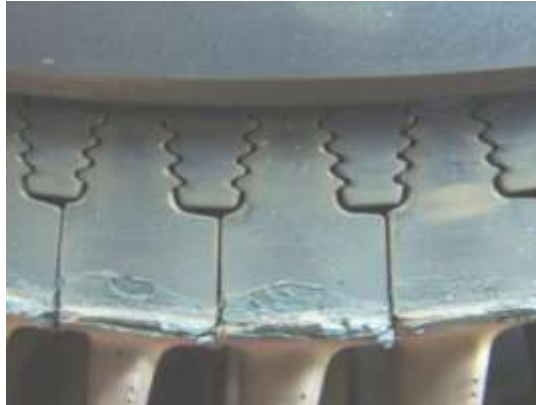
Рис. 1 – Коррозионные отложения на торцах лопаток
