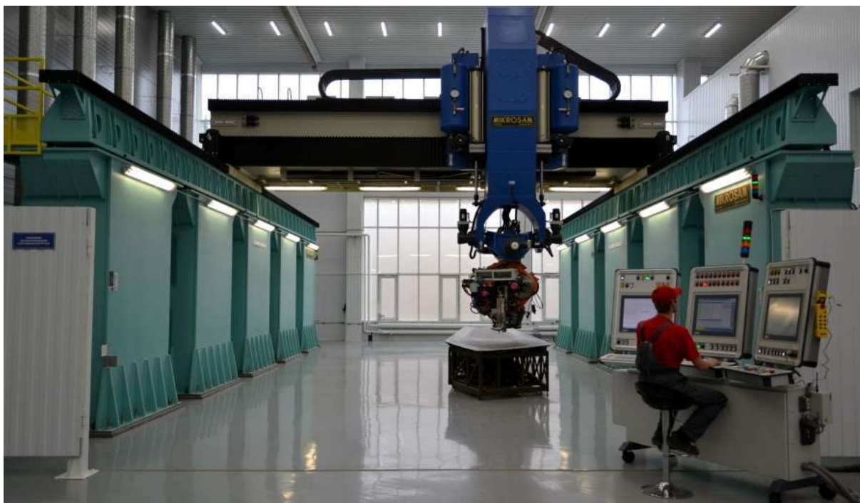
Рис. 1 – Установка высокоскоростной автоматизированной выкладки слоев препрега для изготовления панелей и лонжеронов
