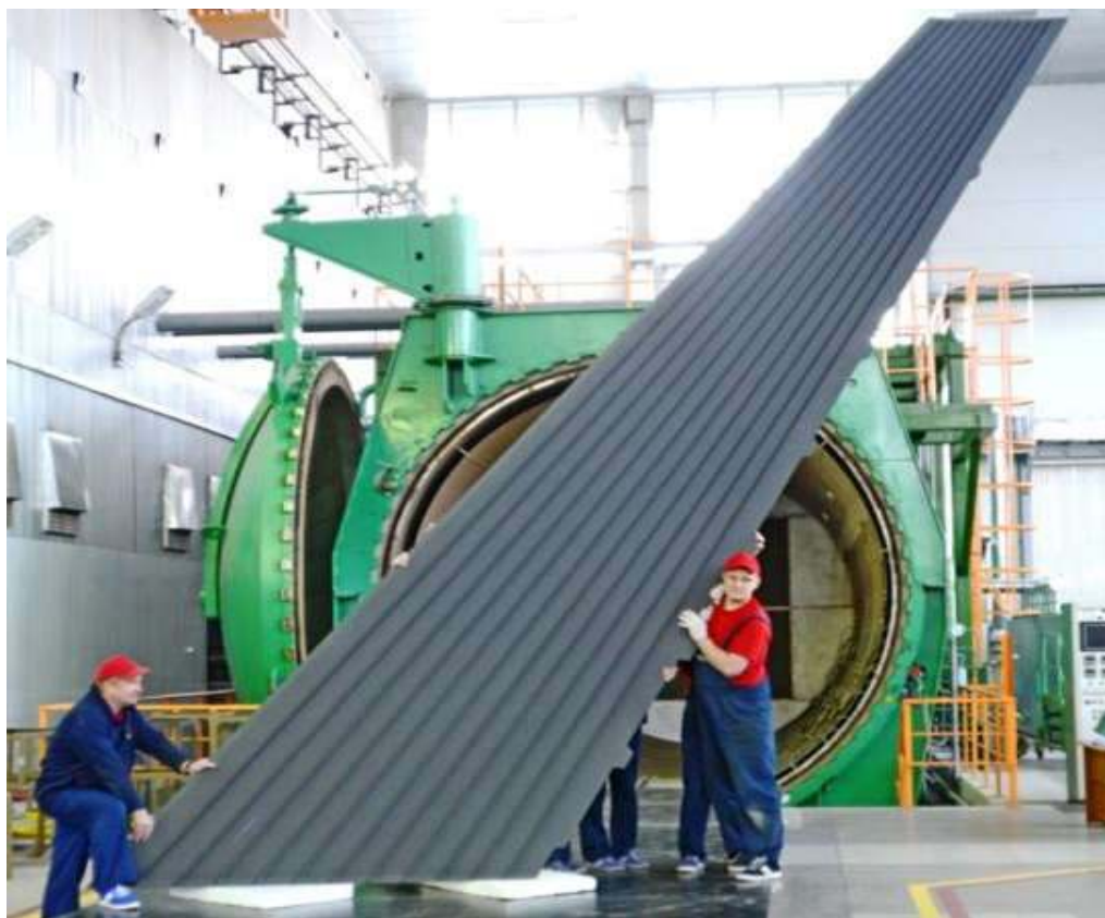
Рис. 4 – Стрингерная панель киля самолета МС-21
