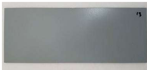
Рис. 2-Б – Натурная экспозиция ВЭ-69 на ВНИИГ БМ лес 12 мес.
