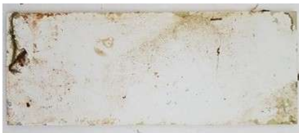
Рис. 1-В – Натурная экспозиция АС-1115 на ВНИИГ БМ литораль 12 мес. Сторона 1
