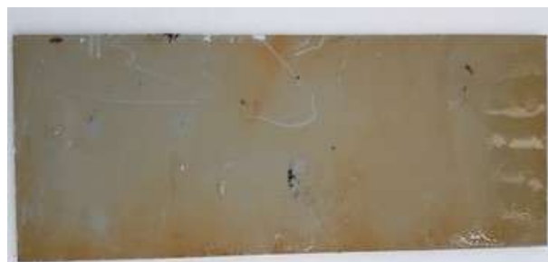
Рис. 2-Г – Натурная экспозиция ВЭ-69 на ВНИИГ БМ море 12 мес. Сторона 1
