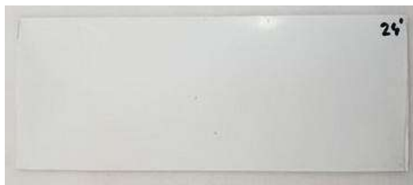
Рис. 1-Б – Натурная экспозиция АС-1115 на ВНИИГ БМ лес 12 мес.
