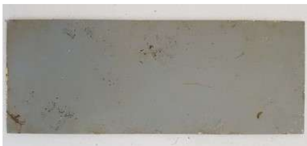
Рис. 2-В – Натурная экспозиция ВЭ-69 на ВНИИГ БМ литораль 12 мес.
