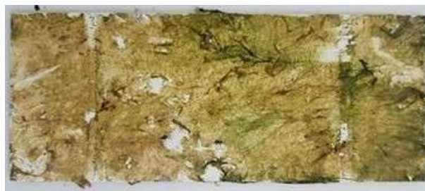
Рис. 1-Г – Натурная экспозиция АС-1115 на ВНИИГ БМ литораль 12 мес. Сторона 2
