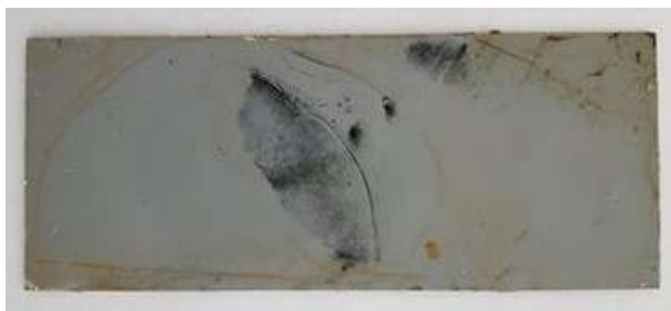
Рис. 2-Д. Натурная экспозиция ВЭ-69 на ВНИИГ БМ море 12 мес. Сторона 2
