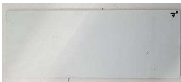
Рис. 1-Е – Натурная экспозиция АС-1115 на ВНИИГ БМ эпиликтораль 12 мес.
