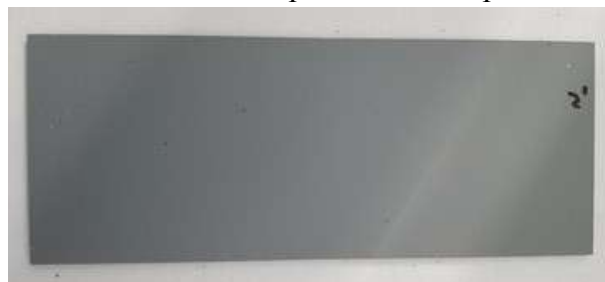
Рис. 2-Е. Натурная экспозиция ВЭ-69 на ВНИИГ БМ эпиликтораль 12 мес.
