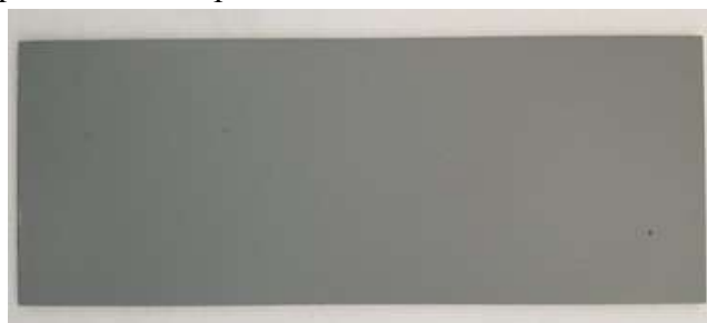
Рис. 2-Ж – Натурная экспозиция ВЭ-69 на ЗКС ИФХЭ лес 12 мес.
