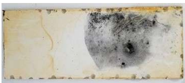
Рис. 1-Д – Натурная экспозиция АС-1115 на ВНИИГ БМ море 12 мес.
