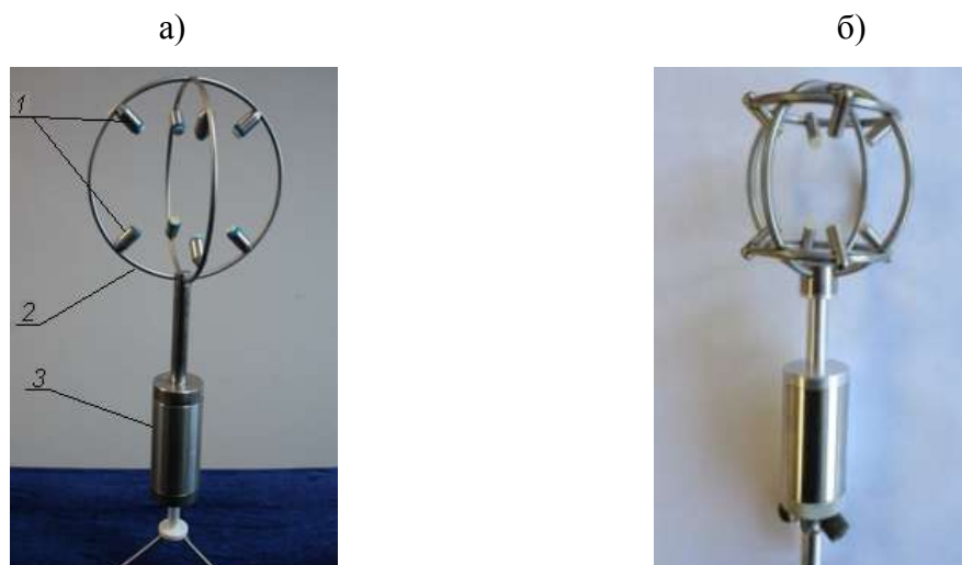
Рис. 1 – Внешний вид ультразвуковых термоанемометров: а – ДСВ-15: 1 – электроакустические преобразователи (излучатели и приемники); 2 – поддерживающая арматура; 3 – цилиндр с электронными элементами; б – новая конструкция ДСВ-75
