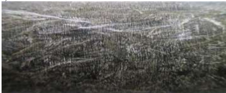
Рис. 2 – Макроструктура заготовок образцов интерметаллидных сплавов после травления, \times 2 : а – сплав 1; б – сплав 2; в – сплав 3
