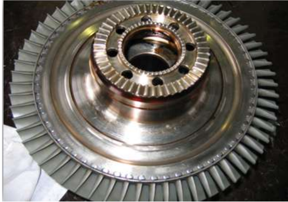
Рис. 4 – Внешний вид образца демонстратора рабочего колеса турбины вертолетного двигателя конструкции типа «блиск», выполненный с применением технологии пайки
