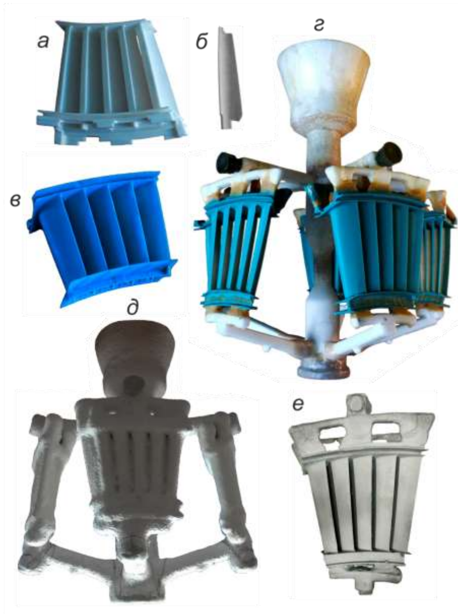
Рис. 2 – Технологическая цепочка изготовления отливки: промодель полученная по SLA технологии (а); керамический стержень (б); восковая модель отливки со стержнями (в); восковая модель отливок с литниково-питающей системой (г); керамическая форма (д); отливка соплового блока (е).
