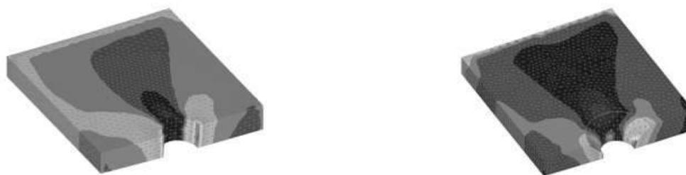
Рис. 7 – Распределение эквивалентных напряжений в образцах без дефектов с цилиндрическим и зенкованным отверстиями [7]
