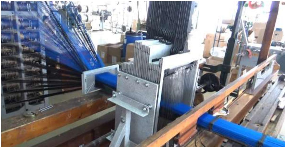
Рис. 3 – Пример заправки станка, для изготовления цельнотканой 3D-преформы сложной структуры и геометрии
