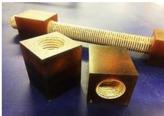
Рис. 10 – Стеклопластиковые шпилька и гайка
