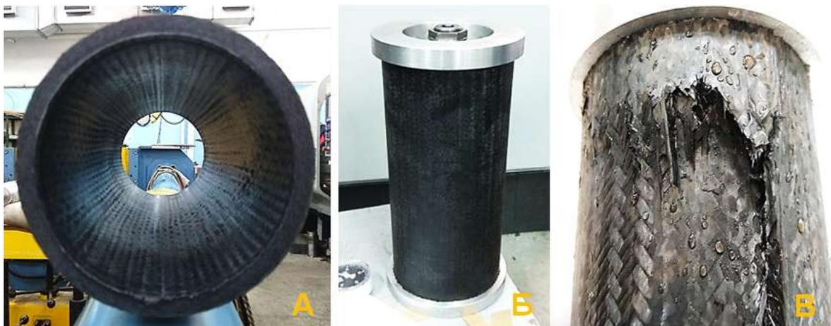
Рис. 3 – А – образец углепластика на основе плетеной преформы; Б – образец перед гидростатическими испытаниями; В – образец после гидростатических испытаний
