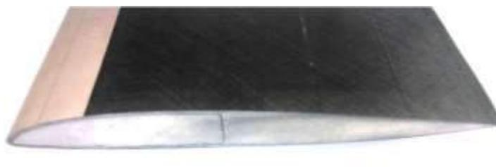
Рис. 3 – Фрагмент лопасти трехслойной конструкции с пенопластом
