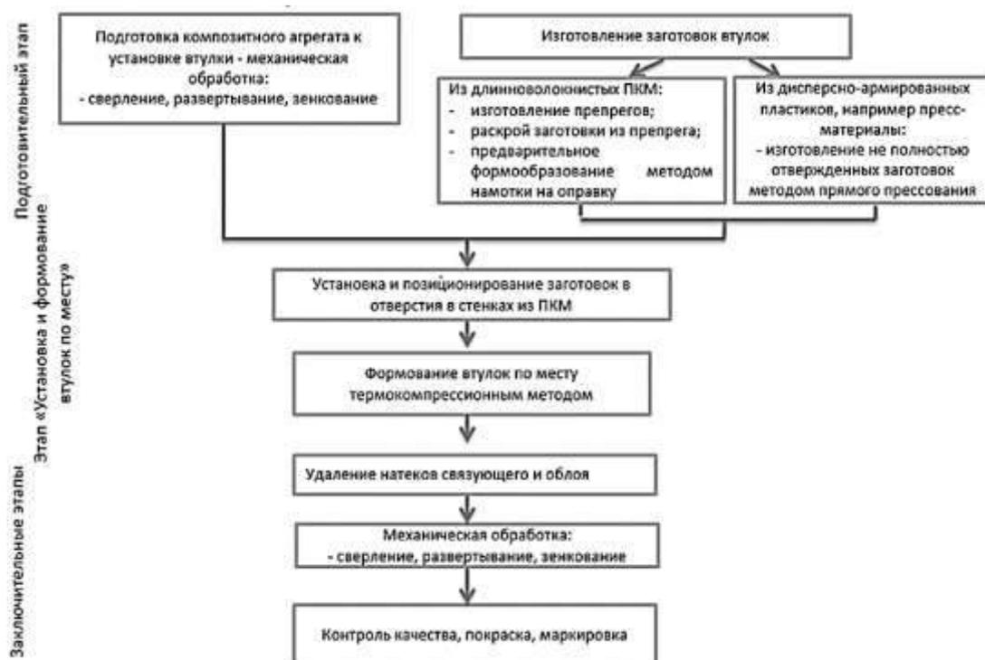
Рис. 2 – Блок-схема [7], укрупненно отражающая технологический процесс установки композитной втулки термокомпрессионным методом
