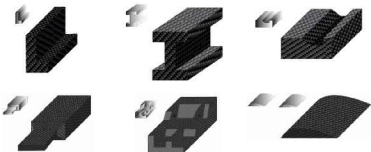
Рис.3 – Схемы объемных трехмерных структур получаемых методом 3D-ткачества [1]
