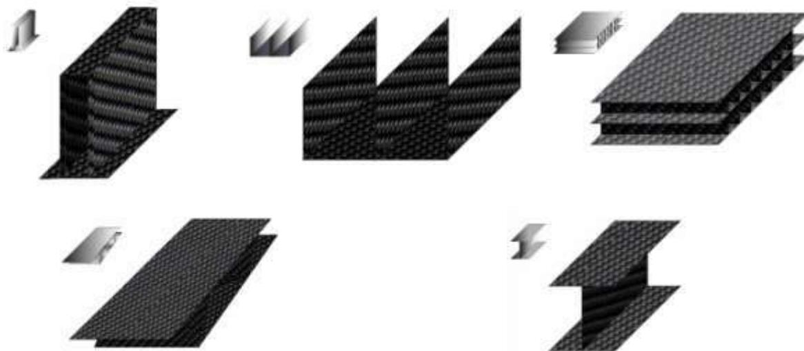
Рис. 2 – Некоторые варианты тонкостенных трехмерных профилей, получаемых методом 3D-ткачества [1]
