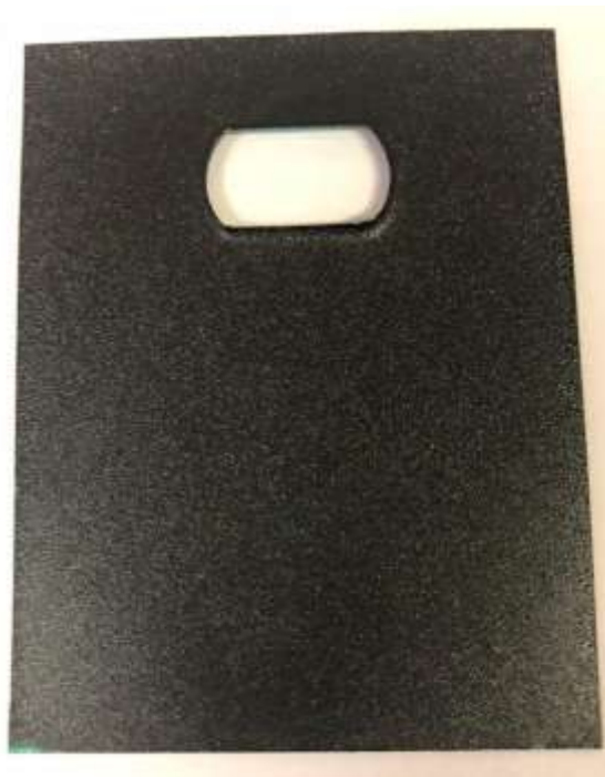
Рисунок 1 - Цинк-полимерное покрытие, полученное методом катодного электроосаждения
