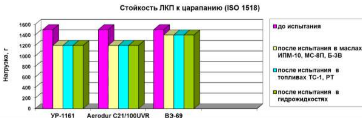
Рисунок 4 – Стойкость систем покрытий на основе эмали ВЭ-69 к действию минеральных и синтетических масел, гидрожидкостей и топлива
