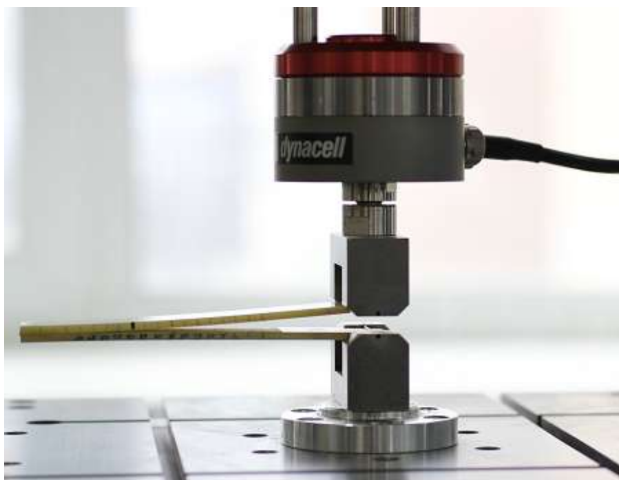
Рис. 2 – Образец стеклопластика ВПС-47/7781 при испытании на трещиностойкость
