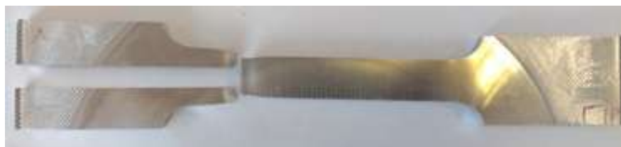
Рис. 1 – Внешний вид образца после испытаний (с продольным разрезом)
