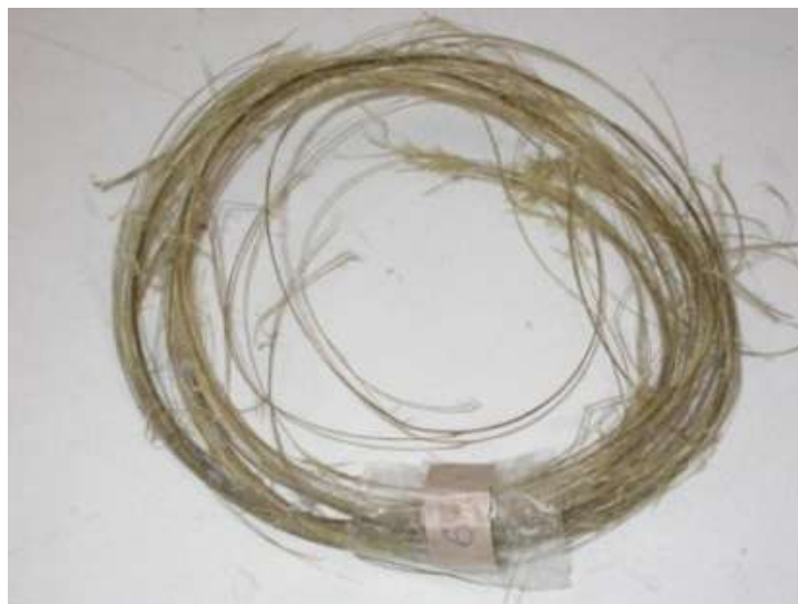
Рис. 6 – Вид разрушенного кольцевого образца
