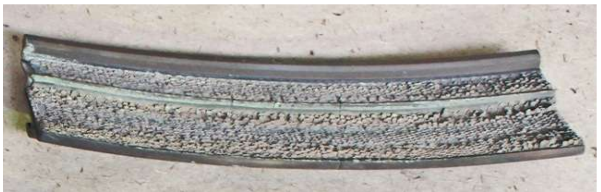
Рисунок 5 – Эрозия сотовых уплотнителей
