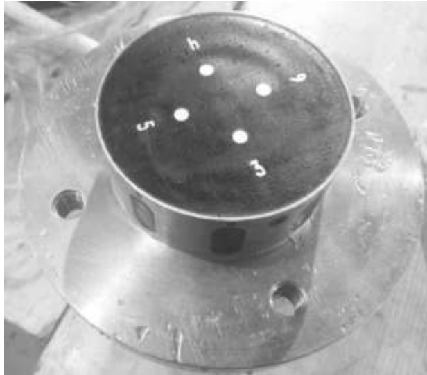
Рис. 8 – Внешний вид опытного образца с АЭ после испытаний
