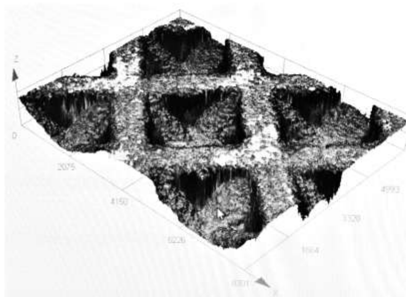
Рис. 3 – Поверхность элементарной ячейки периодичности образца сетчатой конструкции
