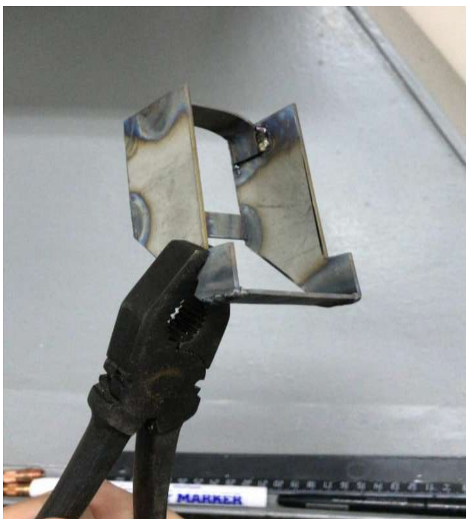
Рис. 3 – Поворотная рамка (ГОСТ Р 50045-92) после сварки
