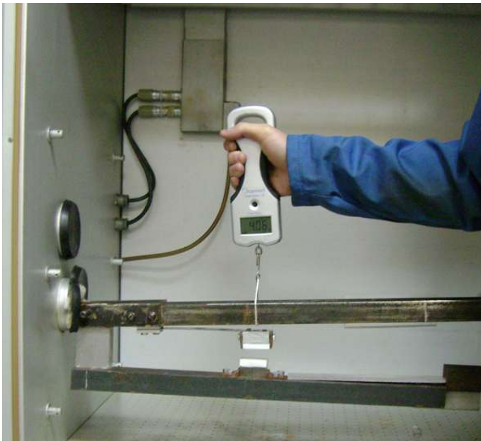
Рис. 3 – Контроль нормальной нагрузки на образцы
