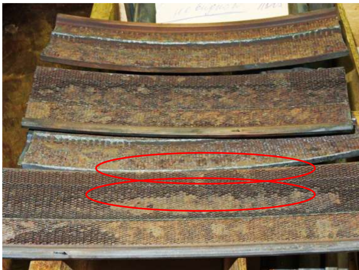
Рисунок 6 – Эрозия сотовых уплотнителей
