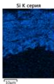
Рис. 9 – Структура образца после термообработки вблизи границы «металл-покрытие», увеличение \times 1500 (а); карты распределения некоторых элементов:
