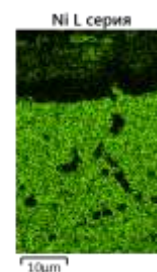
Рис. 8 – Структура образца без покрытия после термообработки вблизи поверхности, увеличение \times 1500 (а); карты распределения некоторых элементов: б – O, в - Si, г - Al, д - Ni
