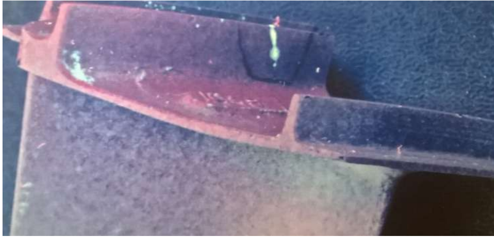
Рисунок 3 – Растрескивание трещин на гребешках бандажной полки лопатки N-ступени
