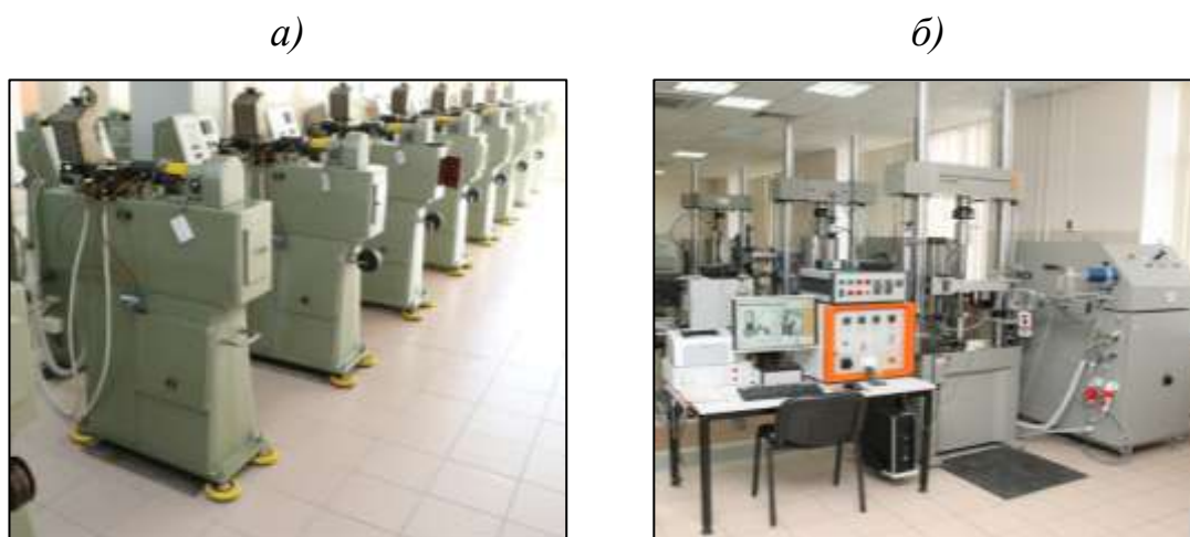
Рис. 1 – Испытательные машины: а – односекционная испытательная машина МВИ611-М; б – испытательная машина фирмы «Walter+ Bai AG» LFV 100-НН
