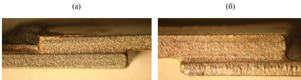
а – образец без покрытия, б – с никелевым покрытием
