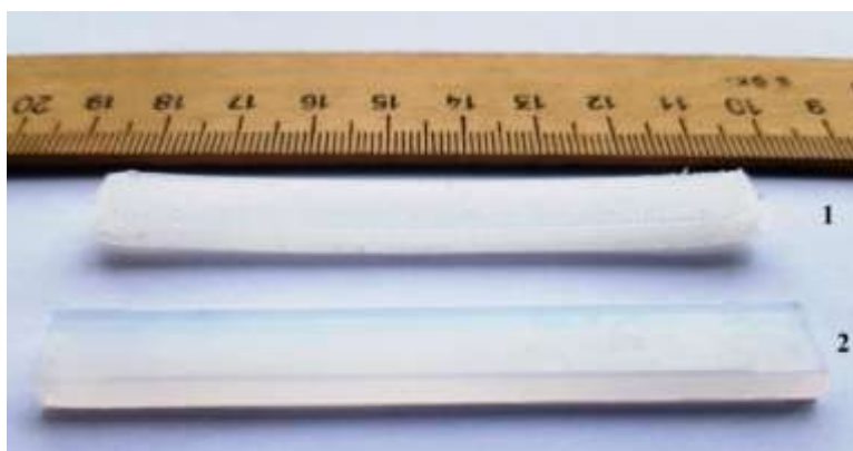
Рис. 1 – Внешний вид прямоугольных образцов полиэтилена, полученных способами FDM печати (1) и литья под давлением (2)
