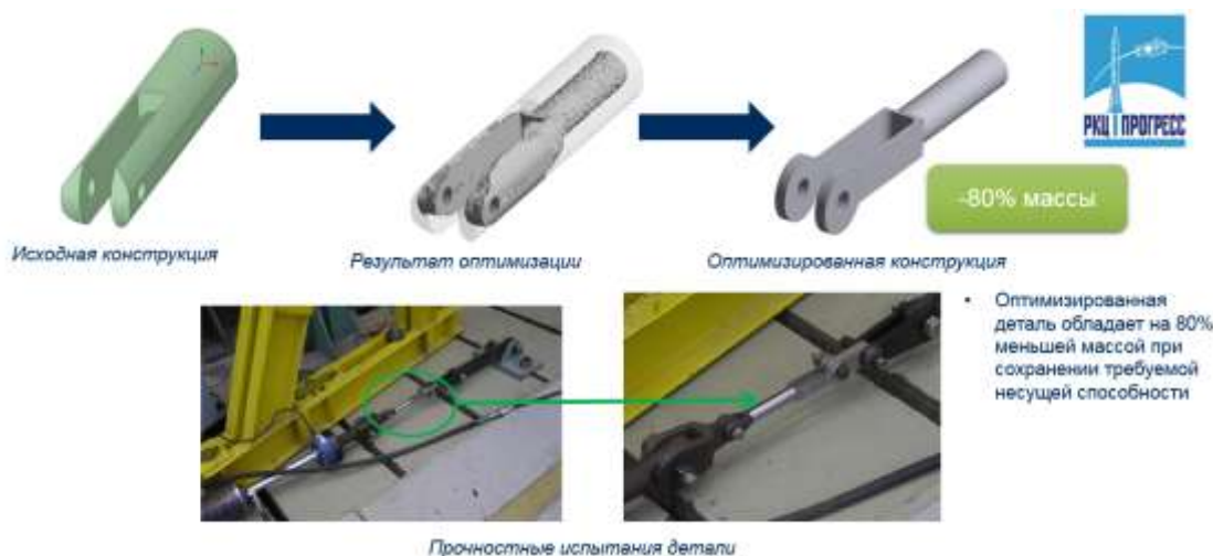
Рис. 4 – Оптимизация тяги в Simulabs Topology Design
