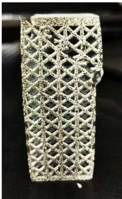
Рис. 13 – Продеформированный образец ВЖ159(а), полиамид(б)
