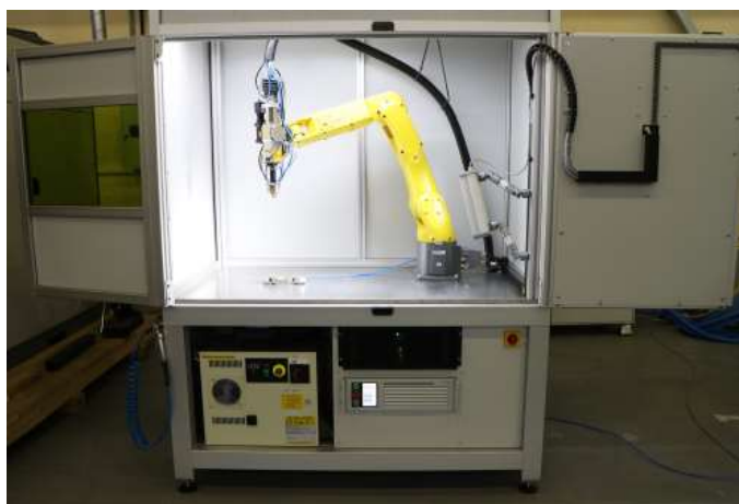
Рис. 3 – Общий вид установки прямого лазерного выращивания
