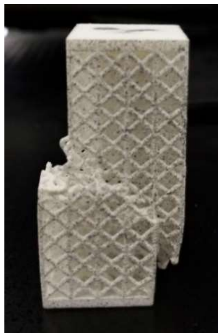
Рис. 13 – Продеформированный образец ВЖ159(а), полиамид(б)
