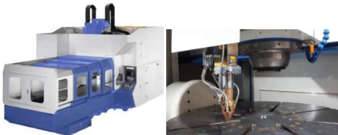
Рис. 1 – Гибридный комплекс прямого лазерного выращивания и механической обработки
