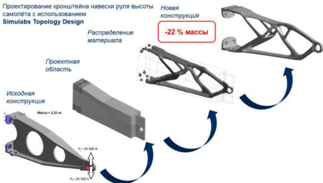
Рис. 3 – Проектирование кронштейна навески руля высоты самолёта с использованием Simulabs Topology Design
