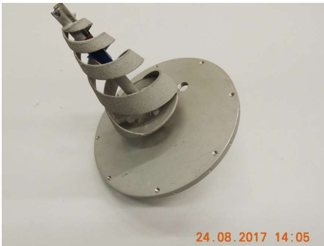
Рис. 2 – Антенна, изготовленная методом 3Д-печати
