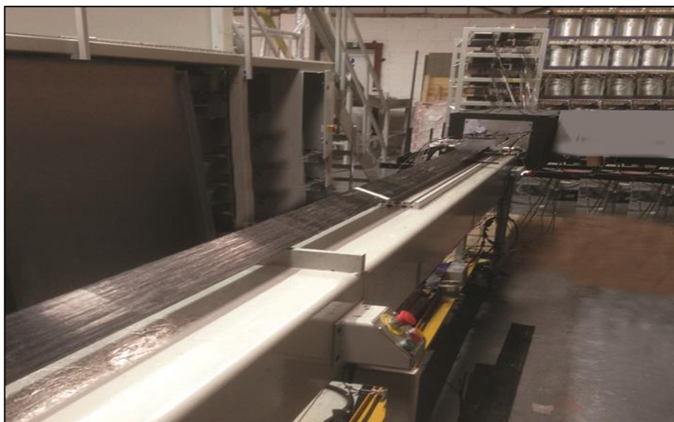
Рис. 6 – Фото пултрузионной установки для изготовления термопластичных профилей
