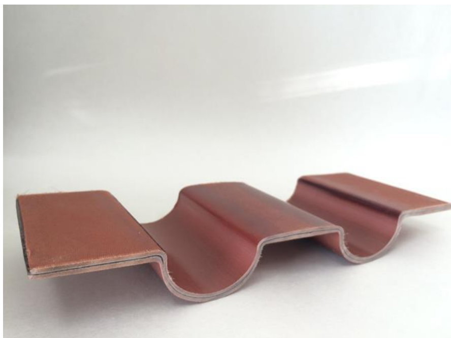
Рис. 1 – Элемент конструкции, выполненный из ПКМ с внутренним вибропоглощающим слоем
