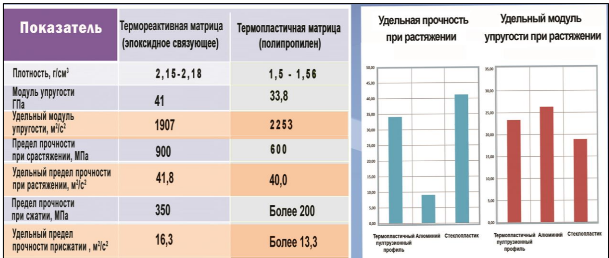
Рис. 7 – Физико-механические характеристики пултрузионных профилей на основе эпоксидного связующего и полипропилена, армированных стеклянным волокном
