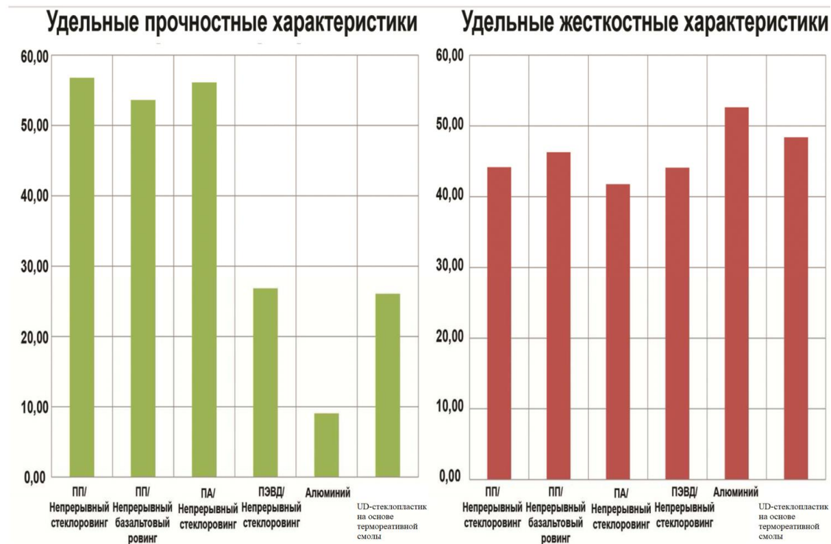
Рис. 4 – Сравнение удельных упруго – прочностных характеристик ТП-лент с упруго – прочностными характеристиками традиционных материалов
