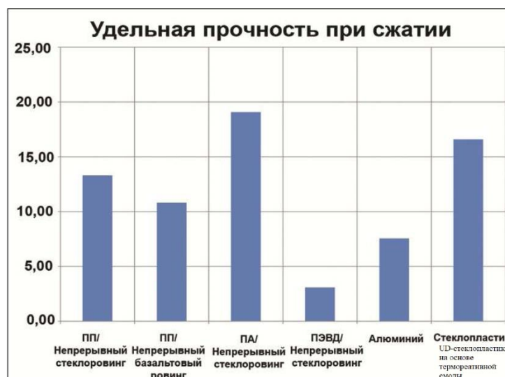
Рис. 5 – Сравнительные упруго – прочностные характеристики при растяжении (а), при сжатии (б) композитов на основе ТП – лент в сравнении с упруго – прочностными характеристиками традиционных материалов
