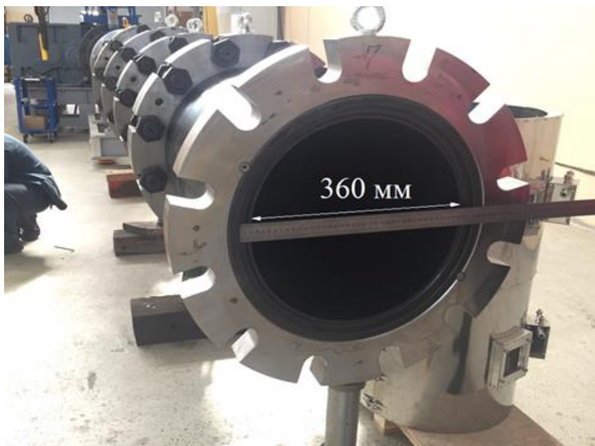
Рис. 9 – Шнековый пресс АДТ 300 и оснастка для формования крупногабаритных заготовок
