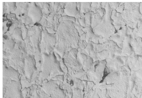
Рис. 3 – Прессование керамических и металлических порошков с наложением дополнительных сдвиговых деформаций на прессовку: а – керамический порошок высокотемпературной сверхпроводящей керамики; б – порошок железа
