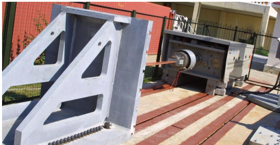
Рис. 3 – Горизонтальный стенд для испытаний крупногабаритных конструкций с образцом лопасти вертолета
