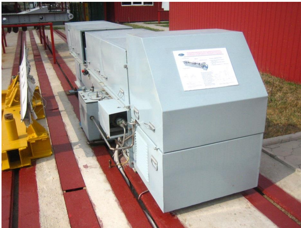
Рис. 1 – Испытательный стенд для усталостных испытаний
