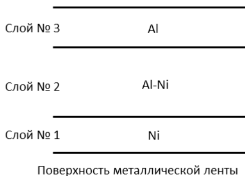
Рис. 1 – Схема напыления функционально-градиентного покрытия методом ХГДНН
