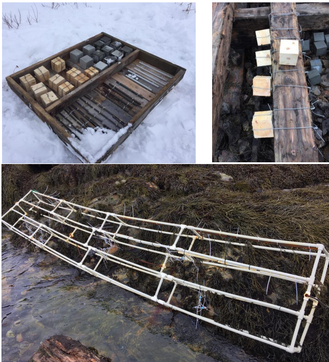
Рис. 5 – Изготовление и размещение образцов материалов, используемых в гидротехническом строительстве, на берегу Баренцева моря
