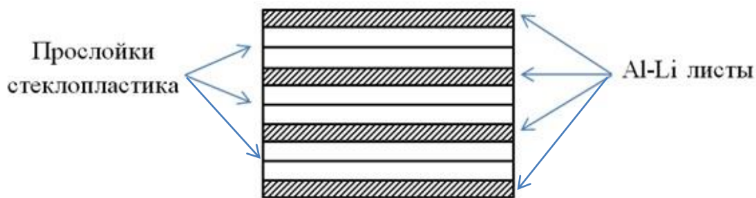
Рис. 1 – Схема укладки слоев в СИАЛ-3-1
