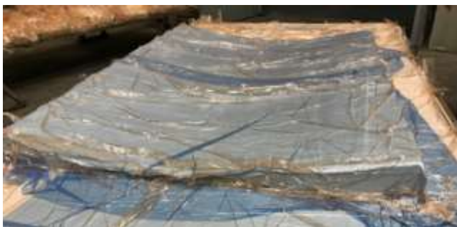
Рис. 6 – «Вакуумный мешок» с подготовленной к загрузке в автоклав заготовки из листа В95оч, размещенной на матрице
