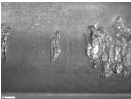
Рис. 4 – Наружное кольцо подшипника № 2. а – следы абразивного изнашивания на внешнем диаметре наружного кольца; б – выкрашивания на дорожке качения; в, г – трещины и выкрашивания на дорожке качения
