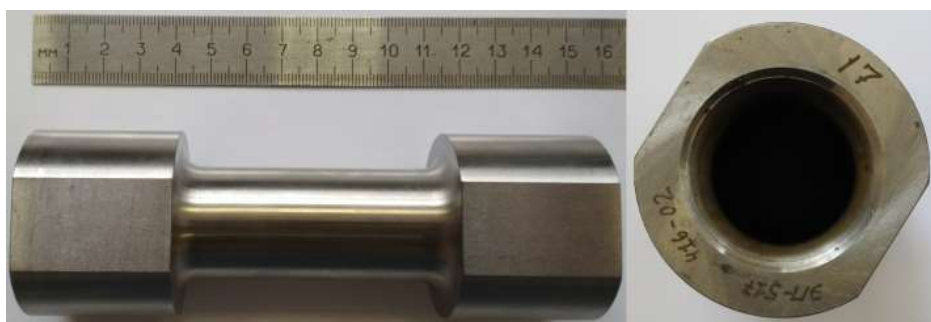
Рис. 1 – Цилиндрический тонкостенный образец ( l_{общ} = 137 мм, D_{раб} = 28 мм, d_{раб} = 26 мм, \delta = 1 мм)
