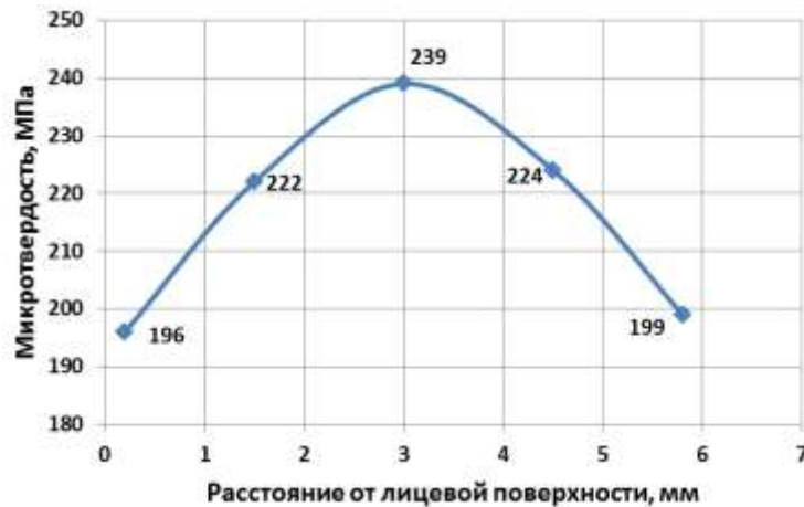
Рис. 7 –Изменение микротвердости матрицы по толщине образца из углепластика ( V = 0,18 )
