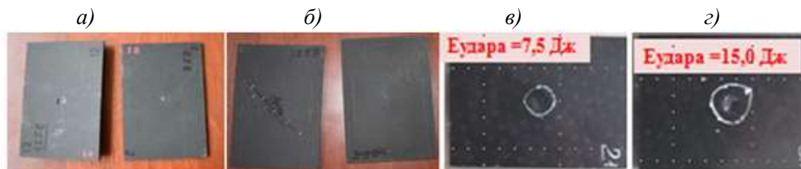
Рис. 2 – Вид образцов с ударным повреждением а – лицевая сторона монолитных образцов (слева направо: пробоина, вмятина); б – тыльная сторона монолитных образцов (слева направо: пробоина, вмятина); в – трехслойный сотовый образец (вмятина); г – трехслойный сотовый образец (пробоина)
