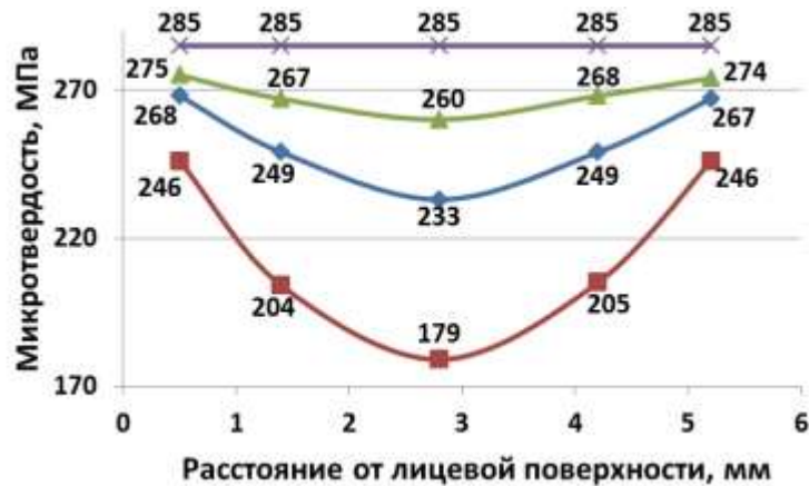
Рис. 5 – Изменение микротвердости по толщине образцов из фенольного связующего РС-Н в зависимости от температуры формования: ♦ – 135 °С, ■ – 145 °С, ▲ – 165 °С, × – 210 °С
