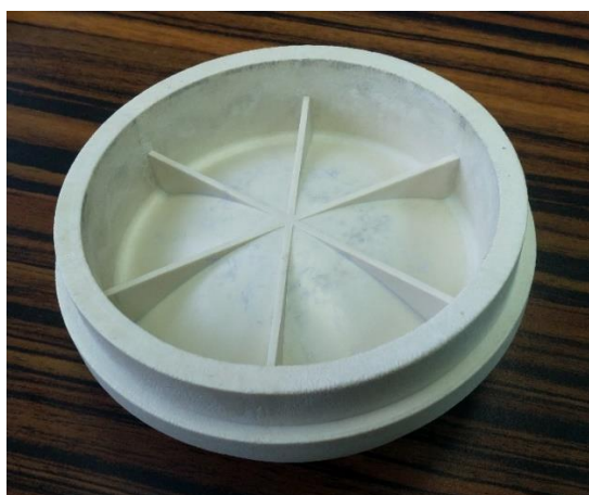
Рис. 4 – Высокоточные (а), корпусные (б), крепежные (в) и толстостенные (г) детали из материала ТЕРМОРАН ПФС СВ-40.
