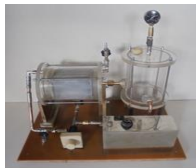
1 – корпус газогенератора, 2 – ресивер, 3 – кран слива воды, 4 – насос, 5 – пластины активированного А1
