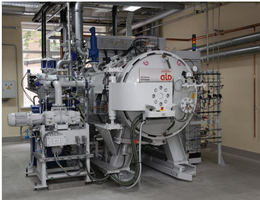
Рис. 1 – Установка для вакуумной химико-термической и термической обработки
