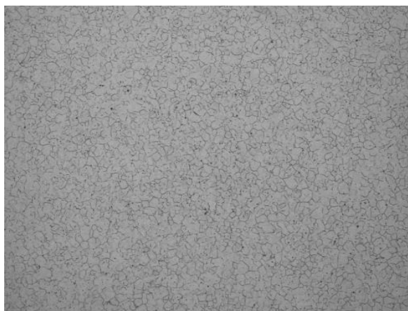
Рис. 3 – Микроструктура стали ВКС-180ИД после окончательной термообработки, 6 – 7 балл зерна
