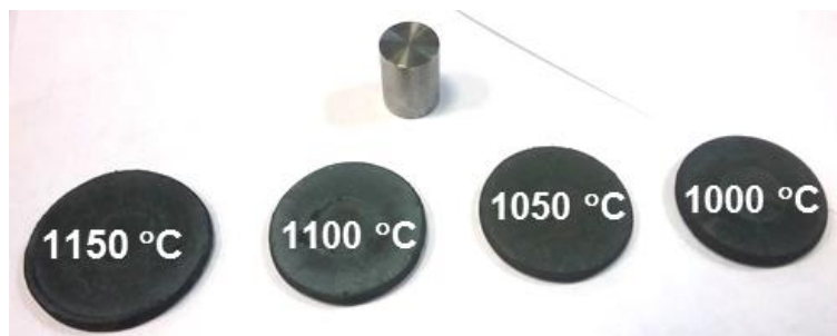
Рис. 1 – Образцы из стали ВКС-9 после испытаний на осадку в диапазоне температур от 1000 до 1150°C
