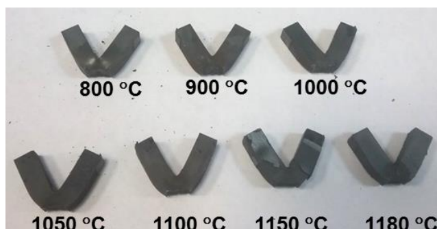
Рис. 2 – Образцы из стали ВКС-9 после испытаний на ударный изгиб в диапазоне температур от 800 до 1180°C
