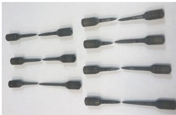
Рис. 3 – Образцы из стали ВКС-9 после испытаний на растяжение в диапазоне температур от 800 до 1180°C
