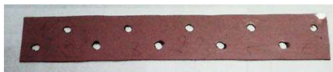
Рис. 5 – Вид образцов ленточного герметика после демонтажа
