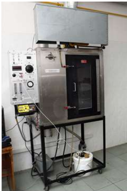
Рис. 3 – Внешний вид испытательного оборудования (дымовая камера) для определения дымообразующей способности полимерных материалов
