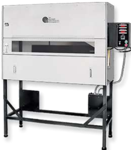
Рис. 2 – Внешний вид испытательной камеры для оценки воспламеняемости матов тепловой изоляции воздушного судна
