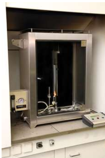
Рис. 1 – Внешний вид испытательного оборудования для оценки горючести материалов в соответствии с требованиями авиационных норм
