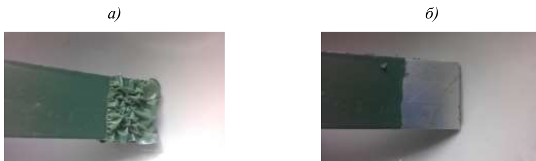
Рис. 2 – Результат нанесения смывки РС-204 на ингибирующий состав: а – образец из сплава Д16Т с нанесенным ингибирующим составом сразу после извлечения из емкости со смывкой; б – образец из сплава Д16Т после удаления отслоившегося ингибирующего состава смывкой РС-204
