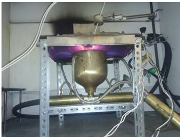
Рис. 4 – Внешний вид оборудования для оценки огнестойкости и огнестойкости
