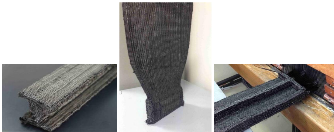
Рис. 4 – Фотографии объемных трехмерных структур, получаемых методом 3D-ткачества [1]
