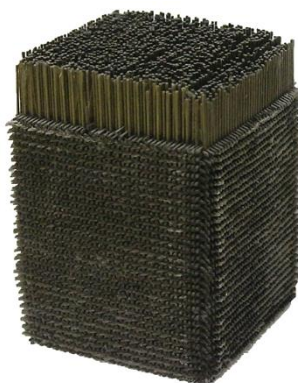
Рис. 5 – Многомерно-армированная углеродная преформа для углерод-углеродного композиционного материала [2]
