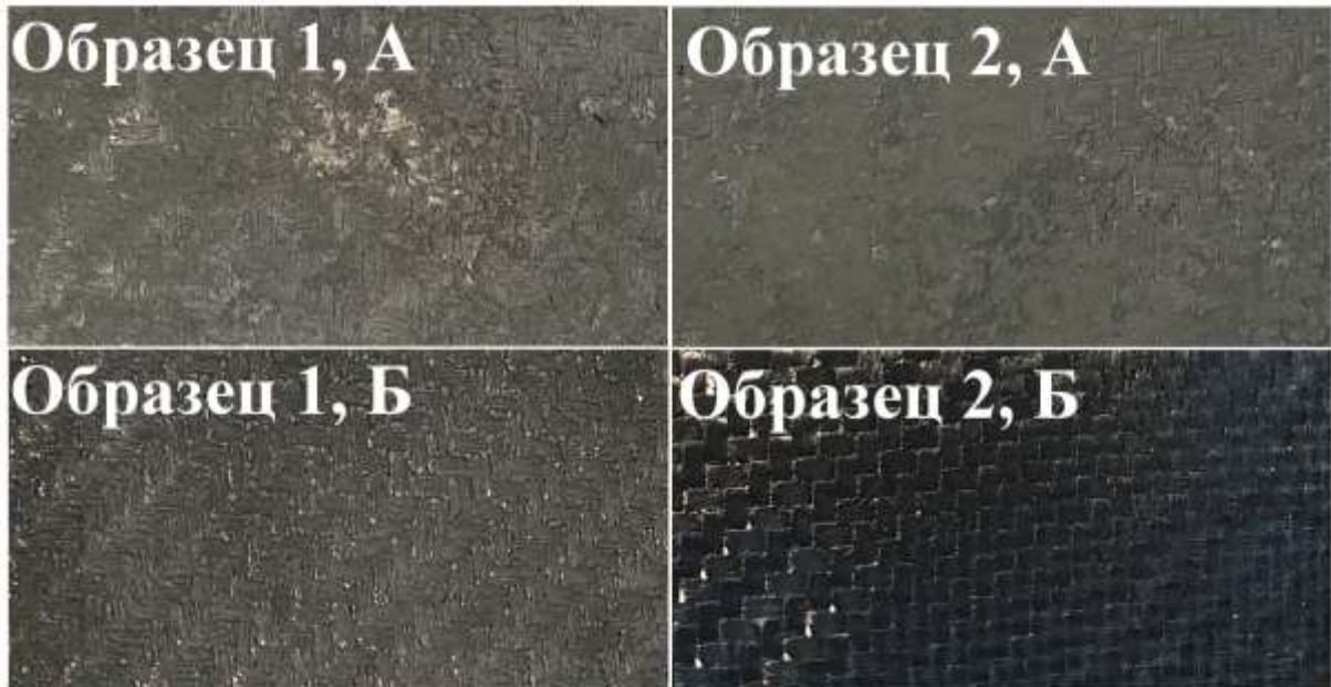
Рис. 1 – Фотографии ККМ, полученных на основе порообразующей композиции мКЭТ и волокон с интерфазой состава ПКСЗР (Образец 1) и без интерфазы (Образец 2).
