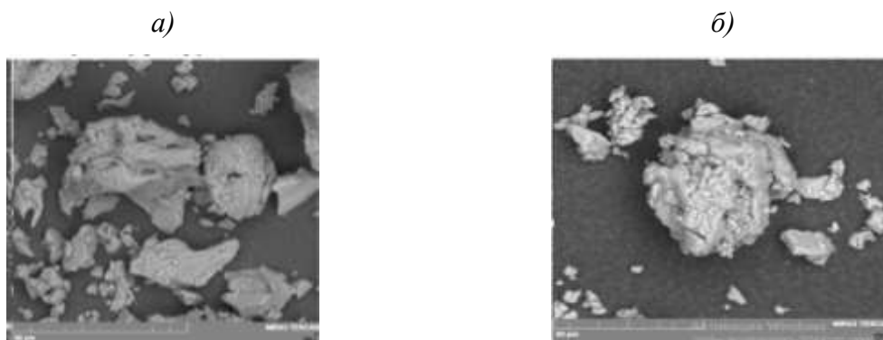
Рис. 2 – Фотографии микроструктуры порошка а) прекурсора, б) шпинели
