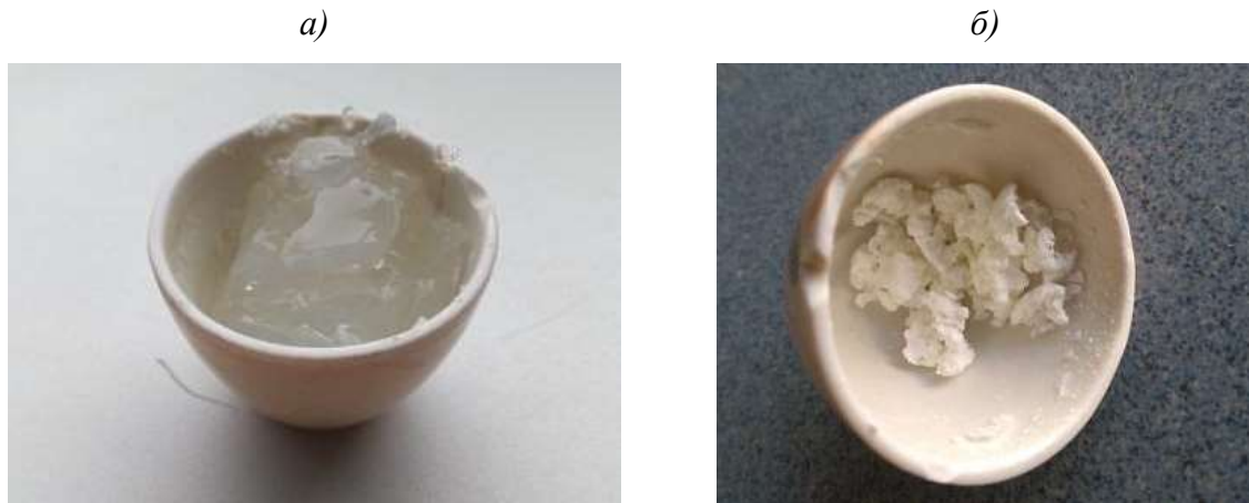
Рис. 4 – Фотография гелированного связующего до (а) и после (б) низкотемпературной обработки
