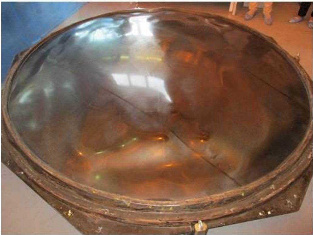
Композитная формообразующая оснастка Ø 2600 мм
