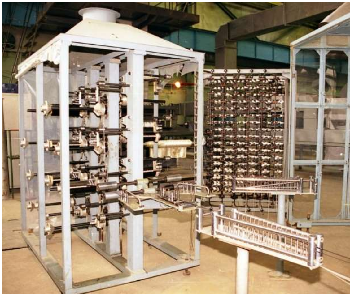
Рис. 5 - Процесс формирования однонаправленных стеклоуглелент для намотки
