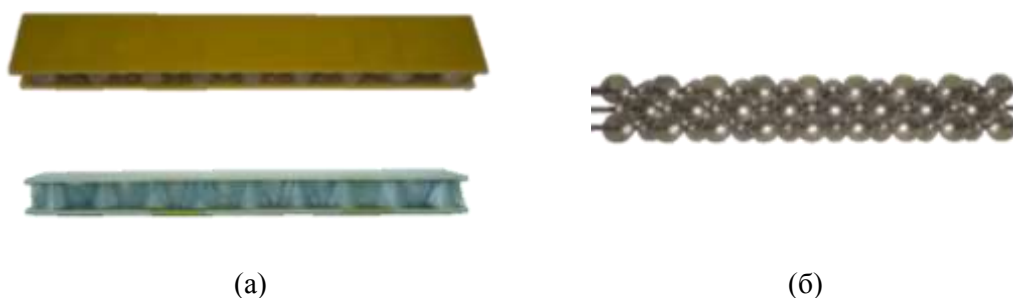
Рисунок 2 - Резонаторы конической формы для трехслойной панели (а) и готовый образец трехслойной панели для испытаний на изгиб (б)
