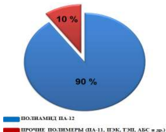
Рисунок 10 – Материалы, перерабатываемые по технологии селективного лазерного спекания
