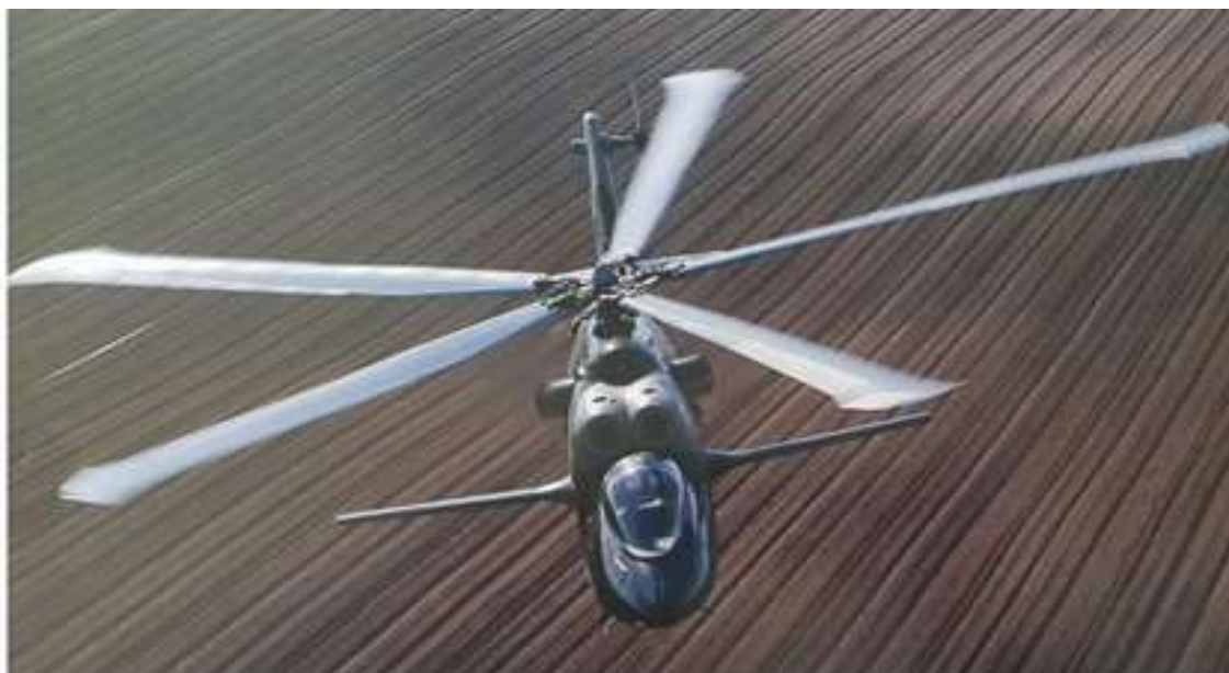
Рис. 13 - Летающая лаборатория ПСВ с лопастями несущего винта, изготовленными по технологии формования за один технологический переход
