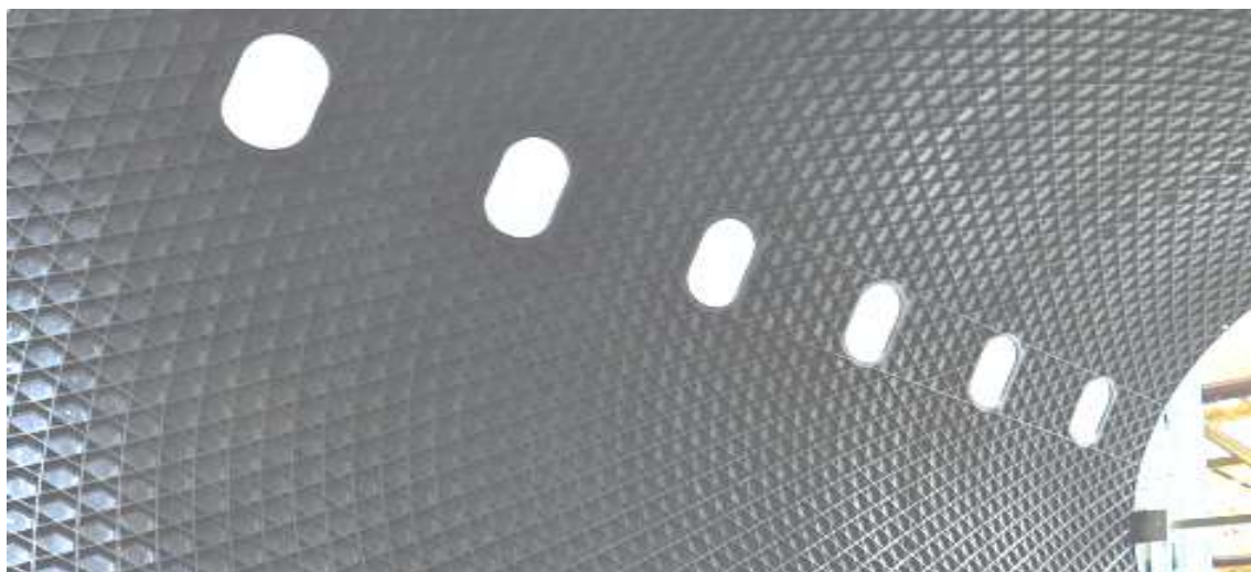
Рисунок 1 – Каркасная структура композитной конструкции перспективного фюзеляжа
