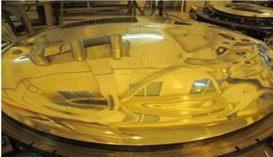
Инваровая формообразующая оснастка Ø 1900 мм
