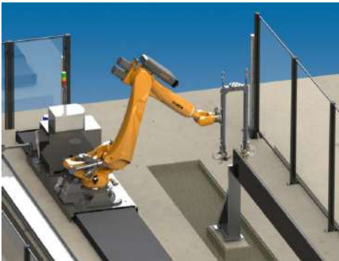
Рис. 14. Пример установки лазерного сканирования и дефектоскопии Робоскоп ВТМ - 3000/Ми, ООО НПК «ТЕХНОВОТУМ» (г. Зеленоград)
