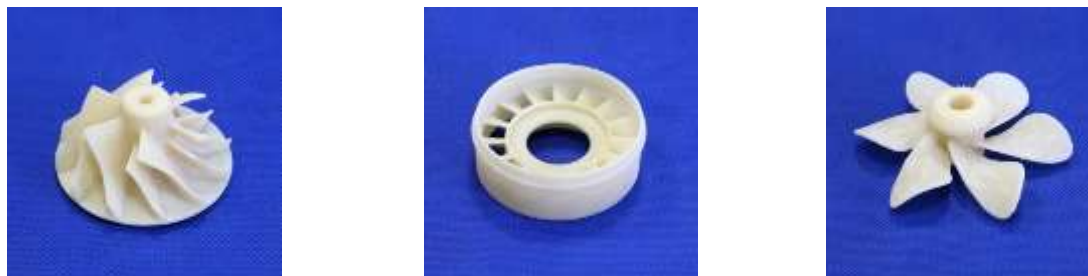
Рисунок 12 – Заготовки деталей, изготовленные методом SLS:
