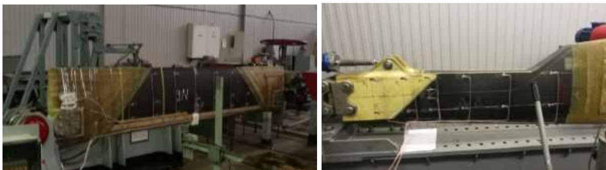
Рис. 12 - Стенды для усталостных испытаний комлевой части лопасти (слева) и средней части лопасти (справа)
