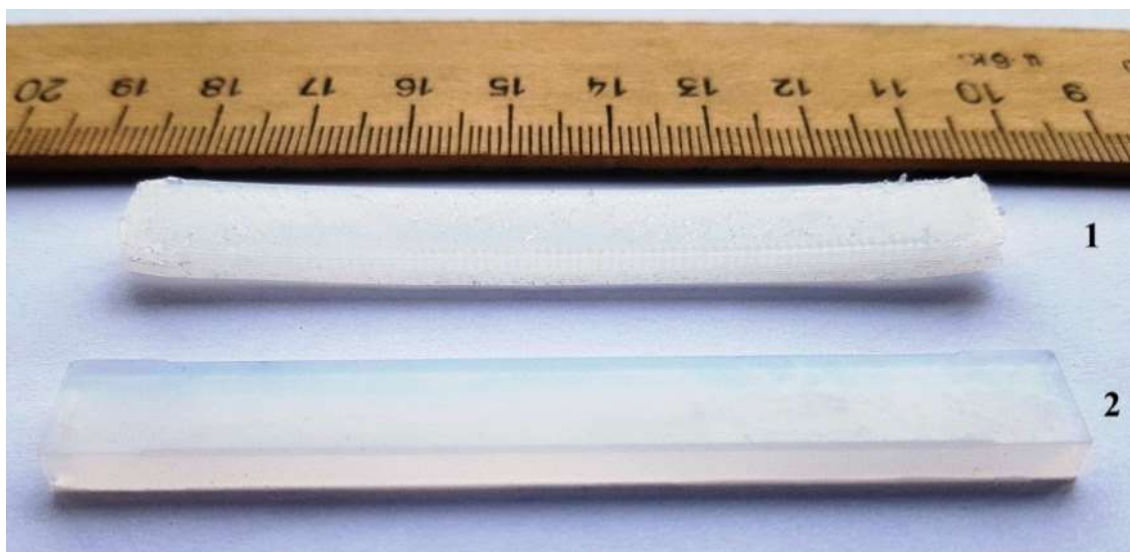
Рисунок 6 - Внешний вид прямоугольных образцов полиэтилена, полученных способами FDM печати (1) и литья под давлением (2)
