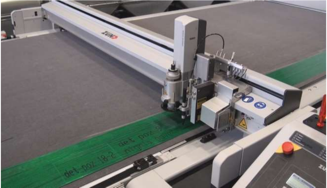
Рис. 8 - Раскрой и маркировка препрега на плоттере
