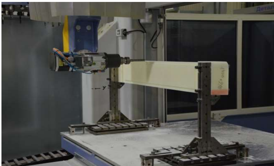
Рис. 7 - Обработка пенопластовых заготовок на станке с ЧПУ
