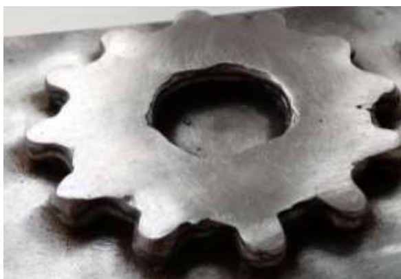
Рис. 7 – Наплавленная форма зубчатого колеса из стали 09Г2С. Режимы наплавки: v_{\text{под}} = 3 м/мин, U = 15 В, v_{\text{дв}} = 0,6 м/мин
