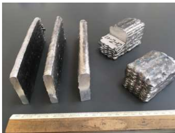
Рис. 1 – Стенки и кирпичи, полученные высокопроизводительным электродуговым выращиванием из алюминиевой проволоки AL-Mg-Mn системы легирования
