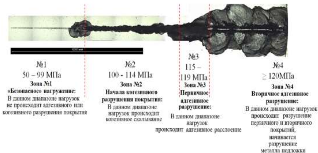
Рис. 4 – Характерный профиль «царапины», разграниченный по степени разрушения
