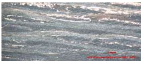
Рис. 2 – Визуализация структуры углепластиковых образцов, изготовленных методом вакуумной инфузии. Снимки получены методом оптической микроскопии с помощью прибора МЕТАМ ЛВ-31 на образцах 20×20×h мм (увеличение – ×25)
