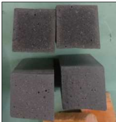
Рис. 1 – Сравнение между образцами, обработанными при температуре 150\text{ }^{\circ}\text{C} \pm 10\text{ }^{\circ}\text{C} на 3 –сутки (снизу) и 7 сутки (сверху)
