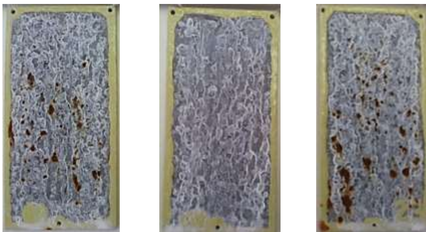
Рис. 6 – Внешний вид стальных образцов с четырехслойным гальванотермическим покрытием, прошедшим термообработку при 185 °С в течение 2 ч после ускоренных коррозионных испытаний в КСТ, коррозия стали через 500 ч
