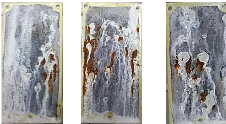
Рис. 3 – Внешний вид четырехслойного гальванотермического покрытия, сформированного при термической обработке 200 °С в течение 2 ч, после 400 ч ускоренных коррозионных испытаний в КСТ
