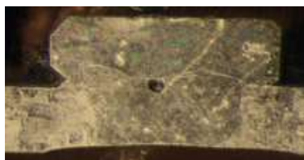
Поперечный шлиф, пора диаметром 0,1 мм
