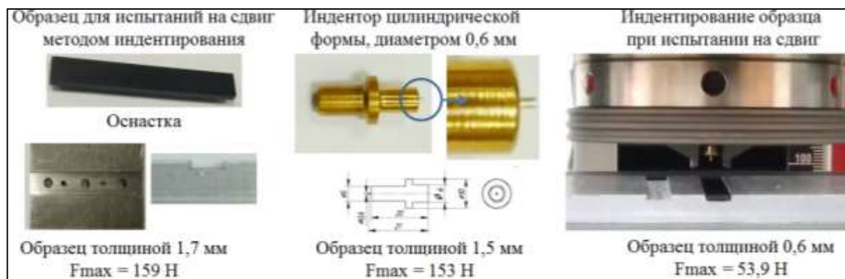
Рис. 2 – Оснастка для испытаний полимерных композиционных материалов на сдвиг
