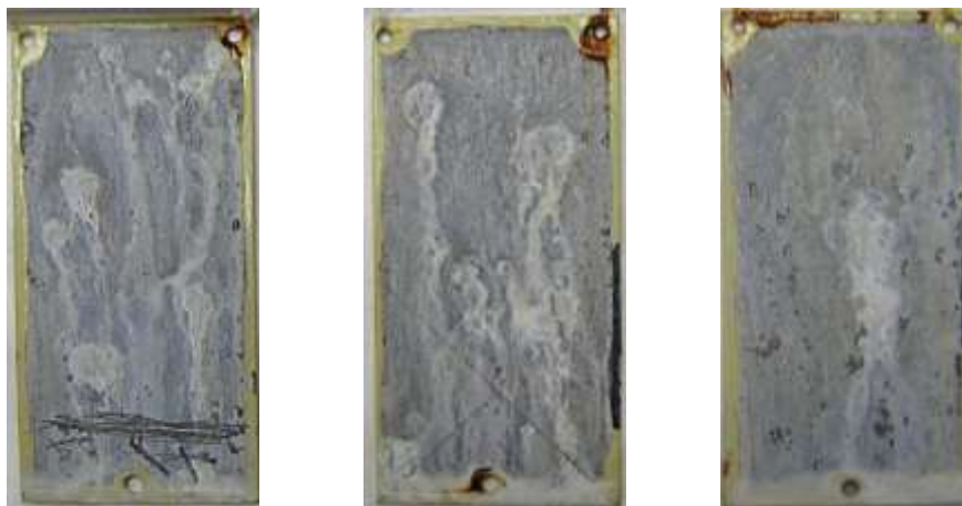
Термообработка при 150 °C в течение 3 ч. Коррозия стали через 10000 ч
