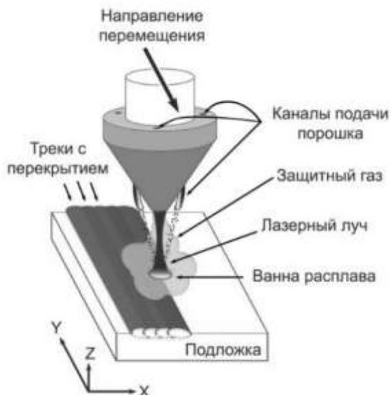
Рисунок 1 - Схема процесса выращивания образца методом лазерной наплавки
