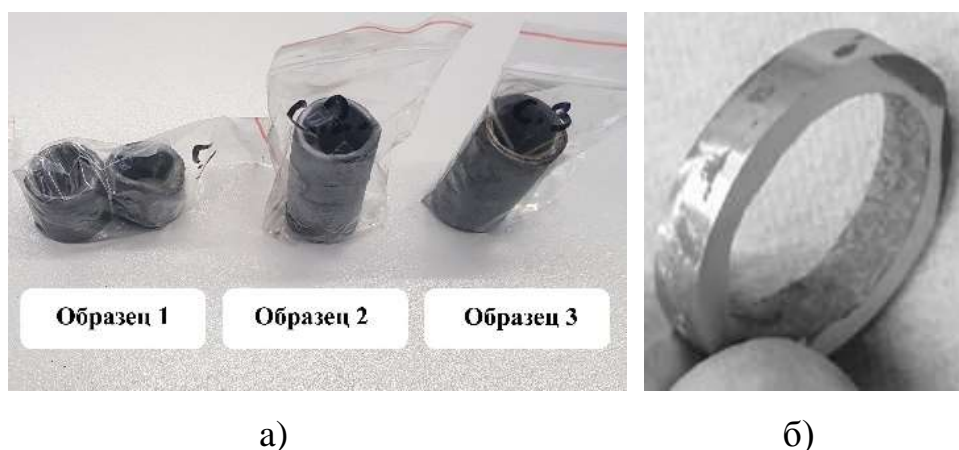
Рисунок 3 - Выращенные образцы NiTi из элементных порошков методом лазерной наплавки, где а – общий вид, б – образец в разрезе
