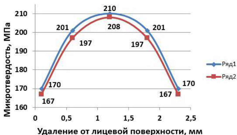
Рисунок 17 – Изменение микротвердости по толщине образцов (пресс)
