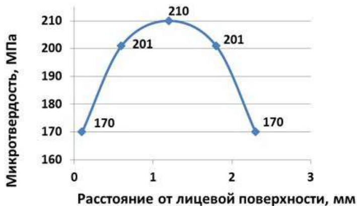
Рисунок 12 – Изменение микротвердости матрицы по толщине образца стеклопластика на основе клевого препрега КМКС-2.120.Т10.37 ( V = 0,19 )
