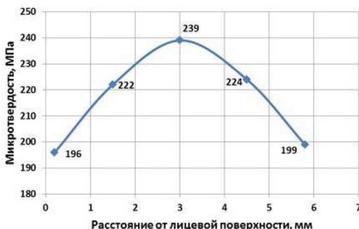
Рисунок 11 – Изменение микротвердости матрицы по толщине образца из углепластика (В = 0,18)
