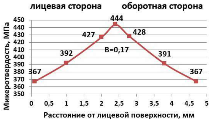
Рисунок 15 – Микротвердость по толщине образца в плоскостях, параллельных лицевой поверхности
