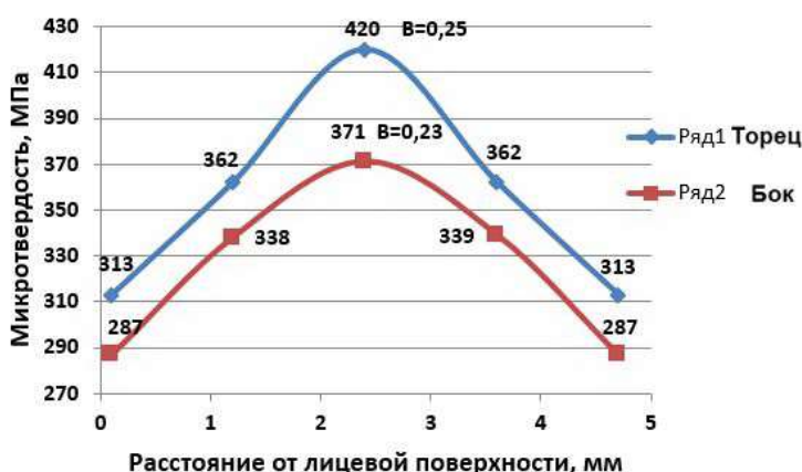
Рисунок 14 – Изменение микротвердости по толщине образца: \blacklozenge – торцевая плоскость, \blacksquare – боковая плоскость
