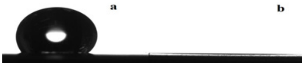
Рисунок 9 - Микрофотографии капли олигосилазана ОЭС -М на поверхности углеродного материала: а) -ОЭС-Zr; б)- ОЭС-Ta,Hf
