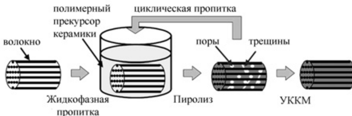
Рисунок 1 - Схема процесса получения КМК с керамической матрицей, полученной по жидкофазным РІР- технологиям
