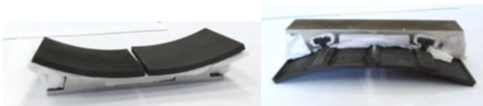
Рисунок 7 – Экспериментальный конструктивно-подобный образец жаровой трубы с теплоизоляционным материалом
