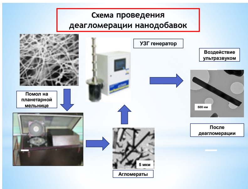
Рисунок 7 - Схема деагломерации нановолокон оксида алюминия «Neoker»
