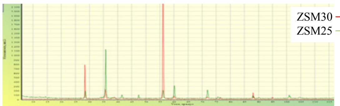
Рисунок 9 – Сравнительная картина 2\theta , Cu-ных рентгенограмм образцов с просилицированными покрытиями составов ZSM25 и ZSM30 после испытаний на жаростойкость
