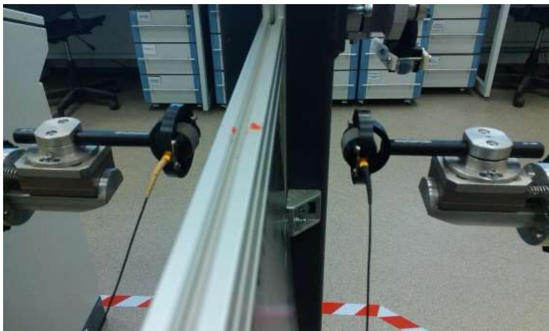
Рисунок 16 – Теневой контроль монолитной плиты с помощью роликовых катящихся преобразователей
