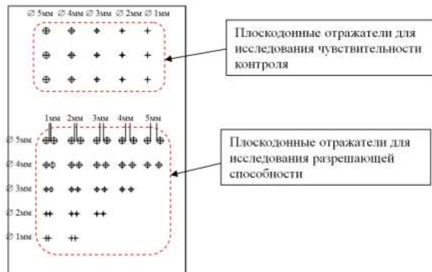
Рисунок 3 – Схема расположения плоскодонных отражателей в исследуемых образцах для образцов толщинами 4,5 и 11,5 мм
