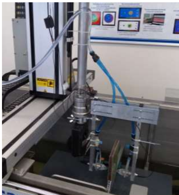
Рисунок 10 – Специализированная оправка для проведения теневого контроля со струйным контактом с быстросъемным креплением
