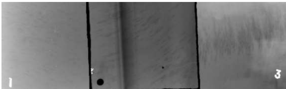
Рисунок 1 - Рентгенограмма эталонных образцов диапазоном 4-10 мм из сплава МЛ5пч с микрорыхлотами слабой, средней и сильной степени
