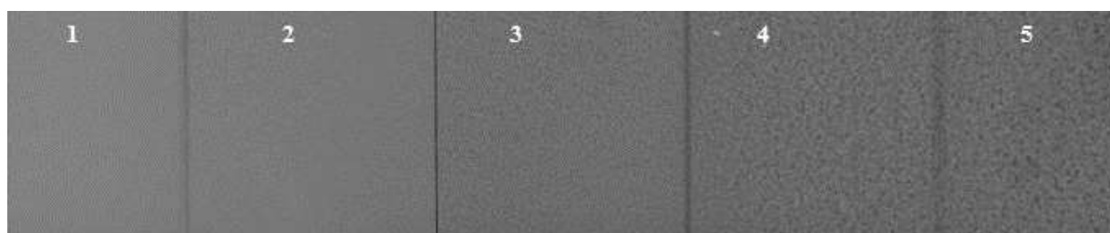
Рисунок 2 - Рентгенограмма эталонных образцов толщиной 5 мм из алюминиевых литейных сплавов типа «силумин» с газовой пористостью 1–5 баллов
