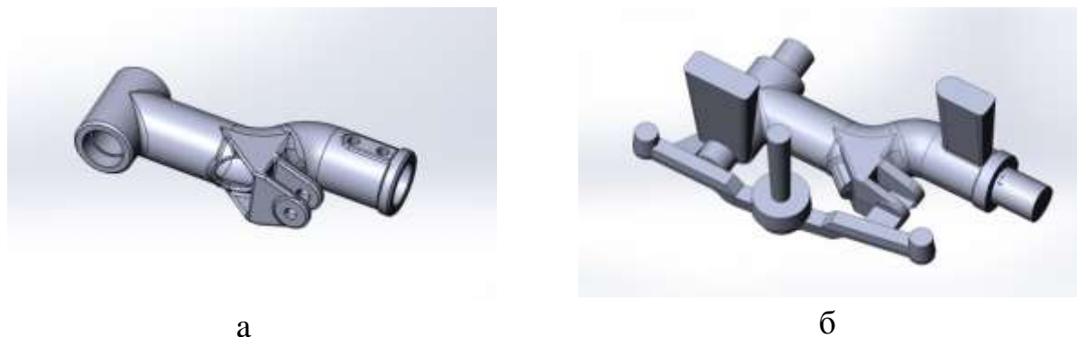
Рисунок 10 - «Рычаг» для сплавов МЛ5пч и ВМЛ18: а - модель детали, б - модель отливки
