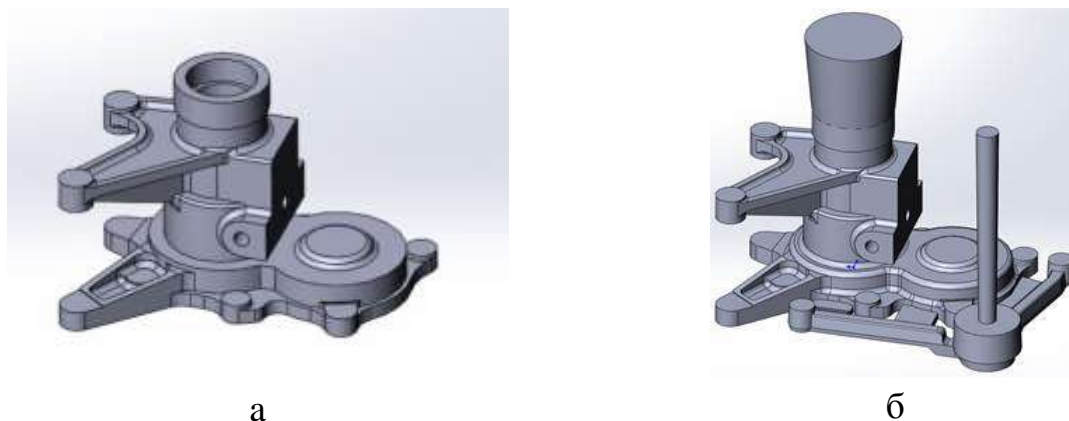
Рисунок 9 - «Корпус» для сплавов МЛ5пч и ВМЛ18: а - модель детали, б - модель отливки
