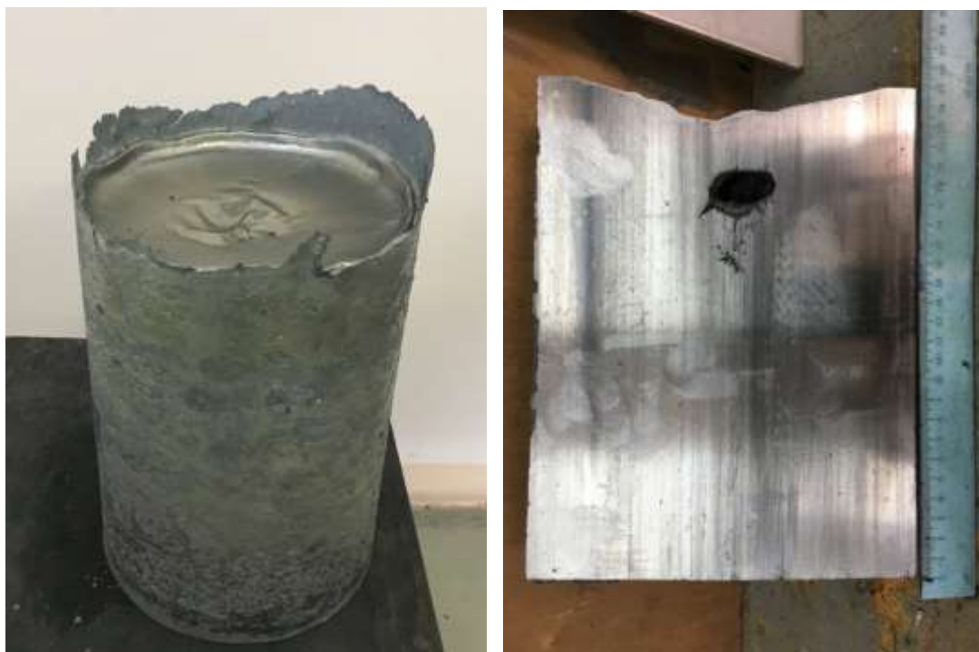
Рисунок 1 – Внешний вид слитка гамма-сплава после тройного переплава (а), усадочная раковина и рассеянная пористость (б)
