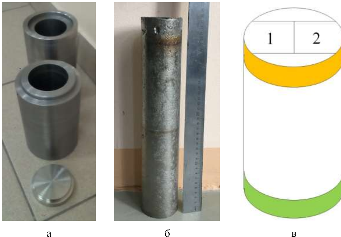
Рисунок 4 – Оснастка для изготовления цилиндрического образца (а) и цилиндрический образец (б), схема вырезки образцов (в)
