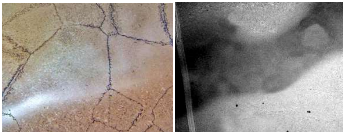
Рисунок 5 - Качественные распределения (а) Nb и (б) Al вблизи трещины. Чем светлее изображение, тем выше концентрация. Ширина снимка 3,45 мм
