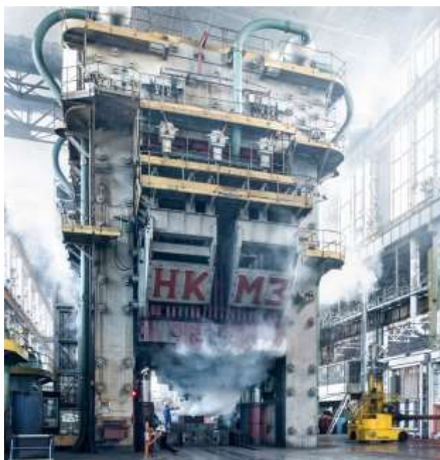
Рисунок 3 – Гидравлический пресс усилием 75000тс на заводе Арконик СМЗ
