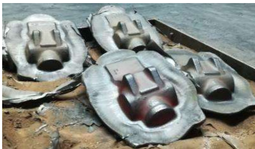
Рисунок 2 – Изготовленные штамповки с заключительной деформацией в (\alpha + \beta) - и \beta -области
