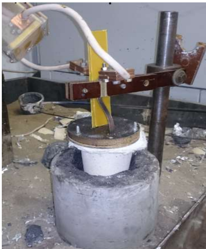
Рисунок 2 – Технологическая оснастка для МИО расплава
