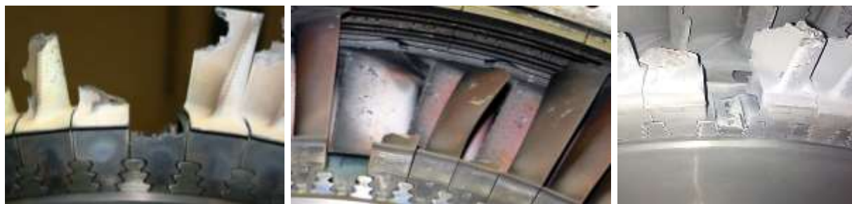
Рисунок 1 - Вид повреждений РЛ 1 ст. ТВД
