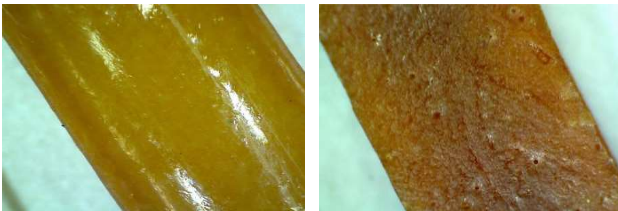
Рисунок 4 – Текстуры поверхности хромато-десорбционных систем до (слева) и после (справа) проведения испытаний
