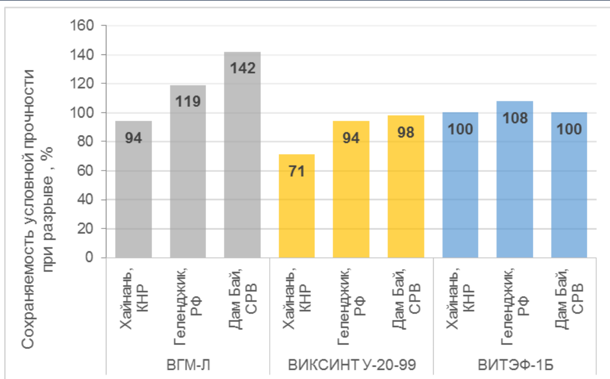
Рисунок 4 - Сохраняемость условной прочности при разрыве ( T_{исп.} = 20^{\circ}\text{C} ) герметизирующих материалов после 1 год экспозиции
