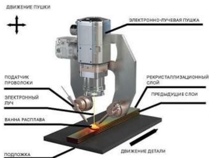
Рис. 1 – Вид процесса электронно-лучевой наплавки
