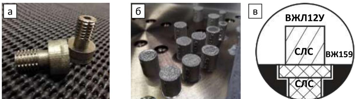
Рис. 2 – Внешний вид резьбовых закладных элементов, изготовленных методом СЛС из сплава ВЖ159 (а), синтезированных образцов из сплава ВЖЛ12У (б) и схема процесса (в)
