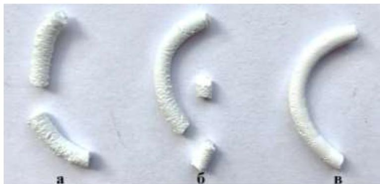
Рис. 5 – Образцы стренги с 55 % содержанием  $\text{Al}_2\text{O}_3$  после керамизации при  $1500\text{ }^\circ\text{C}$ , полученные после одного (а), двух (б) и трёх (в) циклов смешения в экструдере
