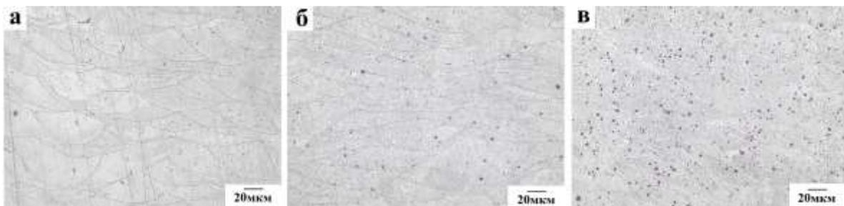
Рис. 6 – Оптические микрофотографии, показывающие микроструктуры (а) чистой стали; (б) сталь+1 % TiC; и (в) Сталь+3 % TiC
