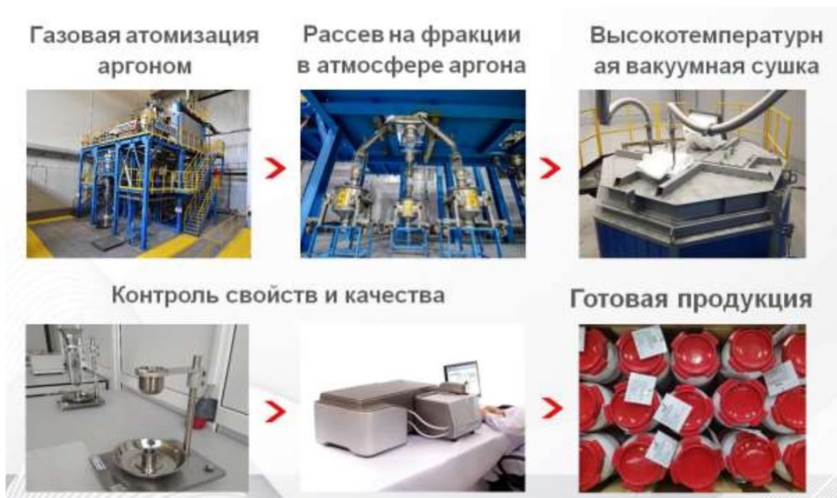
Рис. 1 – Технологическая схема производства порошка для 3D-печати в ООО «Гранком»
