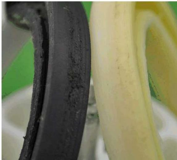
Рис. 7 – Износ рабочей кромки 5D-печатной манжеты
