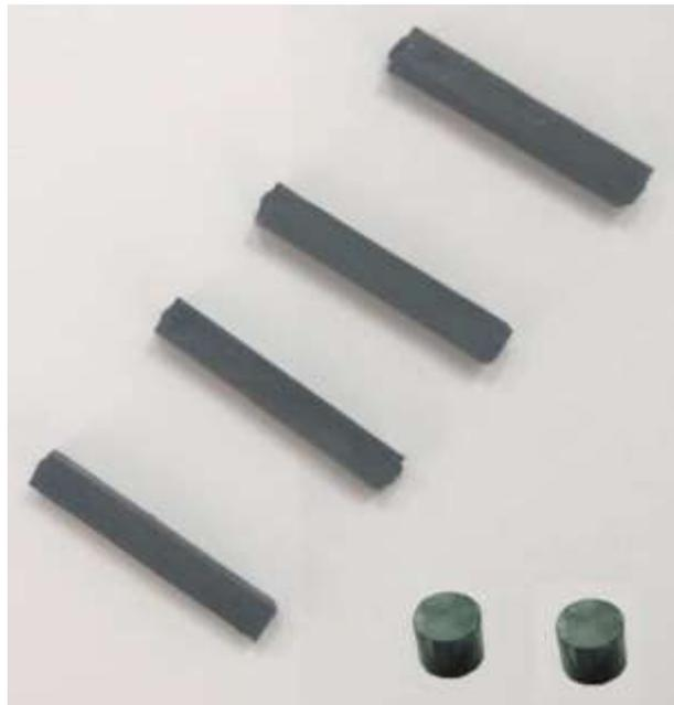
Рис. 2 – Образцы для механических испытаний
