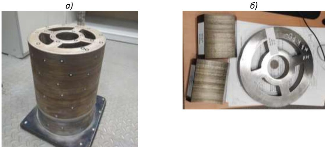
Рис. 3 – Общий вид изделия из сплава ВЖ-159
