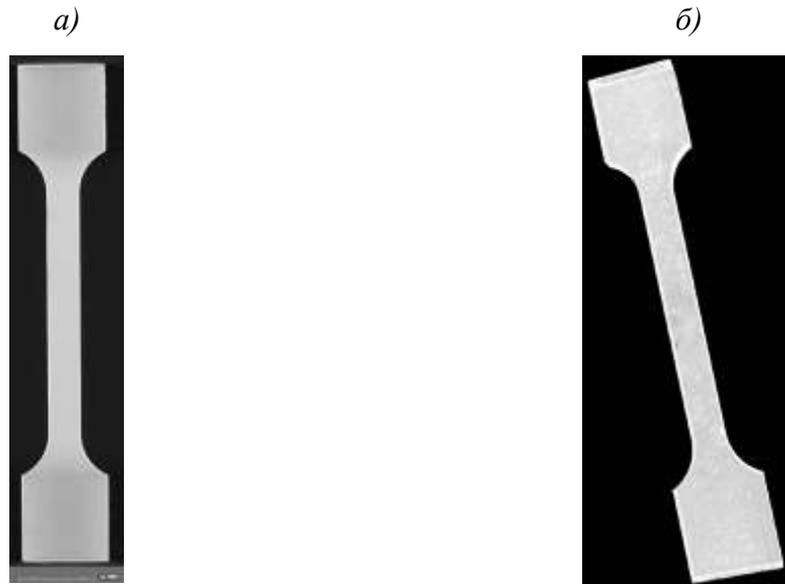
Рис.. 7 – Томограммы образцов на растяжение: а) чистой стали б) с добавлением 3 % TiC (карбиды титана выглядят как более светлые точки на изображении)
