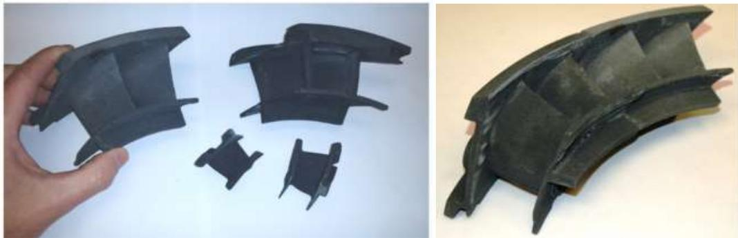
Рис. 1 – Сопловые лопатки и сектор соплового аппарата газотурбинного двигателя из карбида кремния с упрочняющими волокнами SiC, полученные с помощью технологии струйного нанесения связующего
