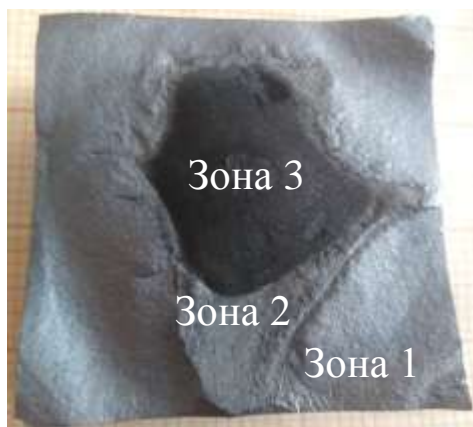
Рис. 1 – Поверхность разрушения образца из РСКК с характерными областями: 1– Зона 1 серого цвета, 2 – Зона 2 серо-зеленого цвета, 3 – Зона 3 черного цвета
