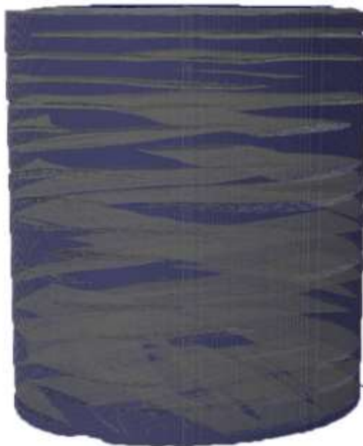
Рис. 2 – Рентгеновская компьютерная томография композитов Ti_3Al(Si)C_2 с упрочняющими волокнами SiC
