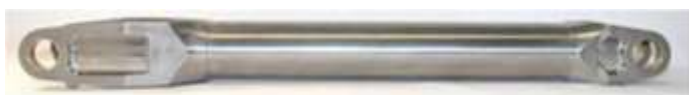
Рис. 3 – Поршневые штоки гидропривода и боковые стойки для Airbus A320 (а, б), сосуды высокого давления (в) [7]
