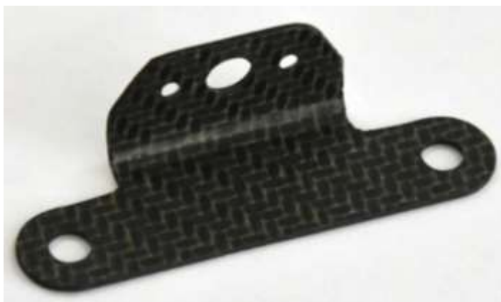
Рис. 3 – КПО элемента мотогондолы – кронштейн из листового углепластика ВКУ-65
