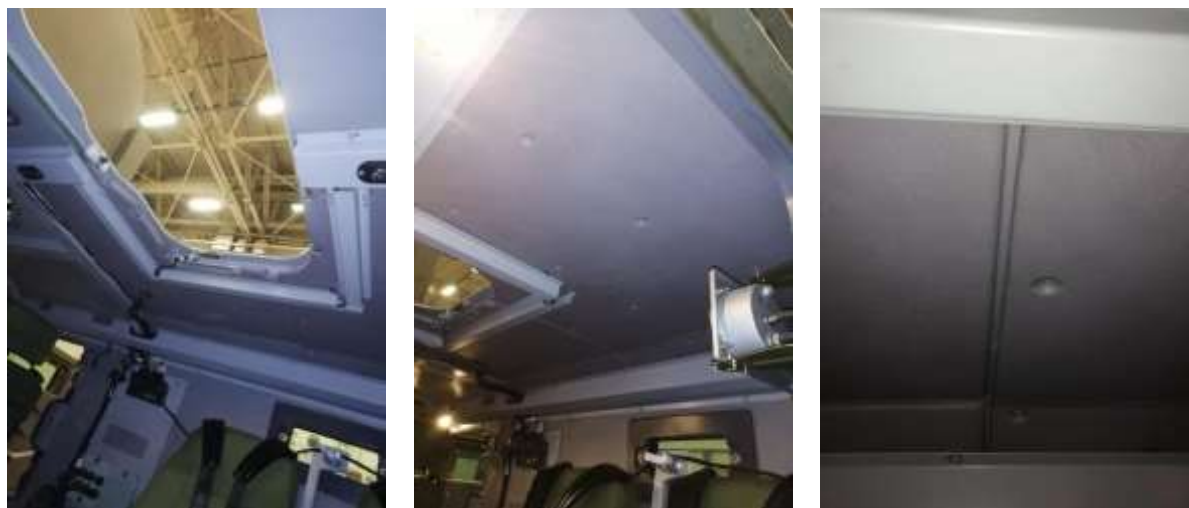
Рис. 2 – Детали интерьера автомобиля специального назначения изготовленные из ППУ с терморасширяющимся графитом
