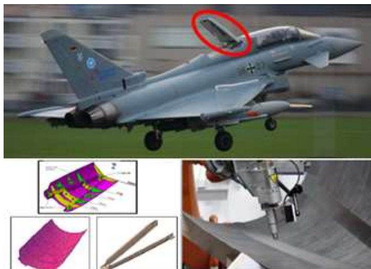
Рис. 2 – Применение ПАД при изготовлении воздушного тормоза самолета Eurofighter Typhoon
