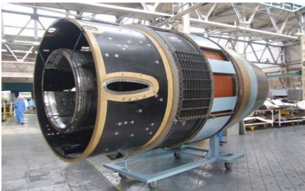
Рис. 1 – Мотогондола двигателя ПС-90А в процессе сборки
