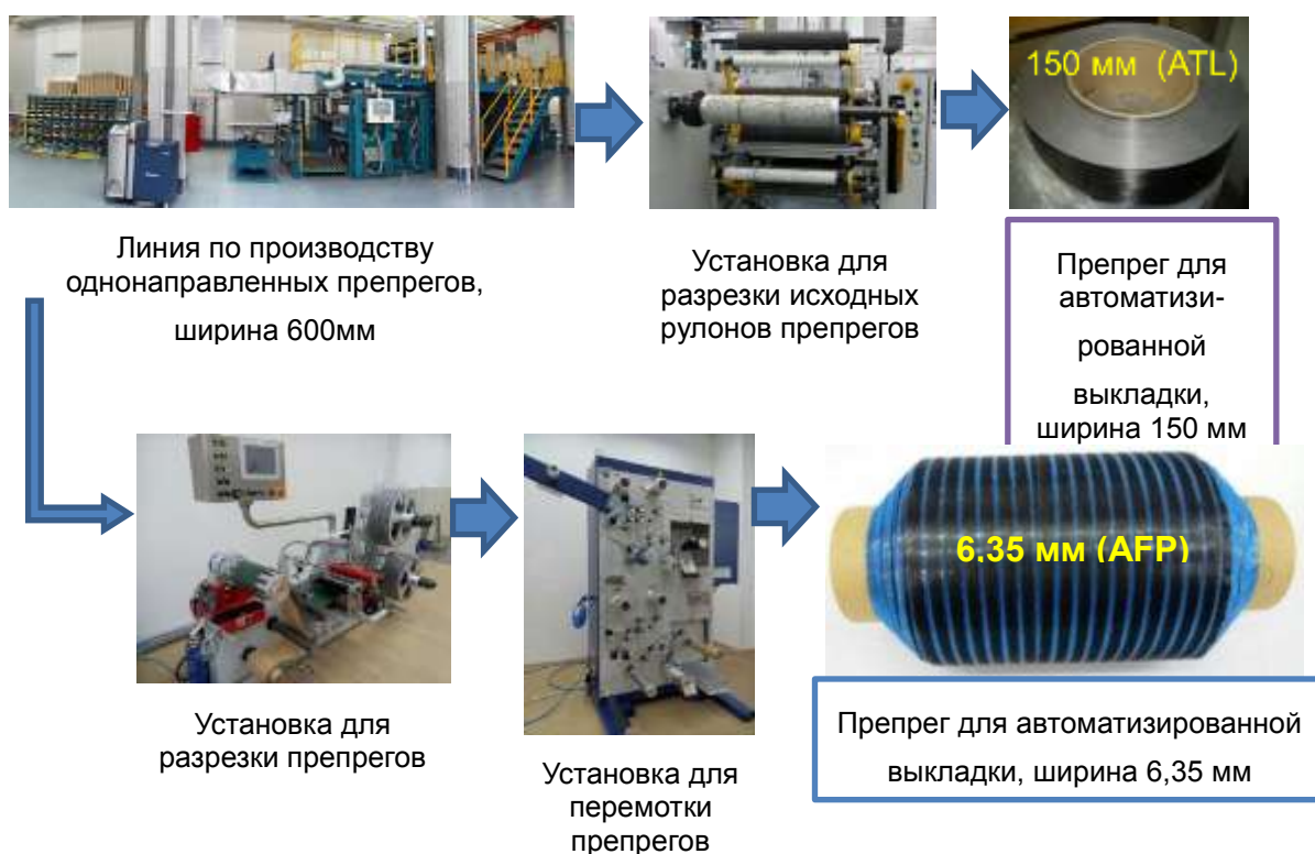
Рис. 5 – Схема процесса производства препрегов углепластиков ВКУ-25 и ВКУ-28
