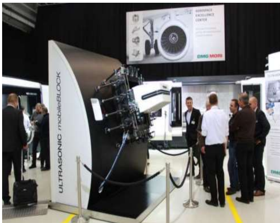
Рис. 4 – Применение ПАД при проведении ремонта конструкций из ПКМ
