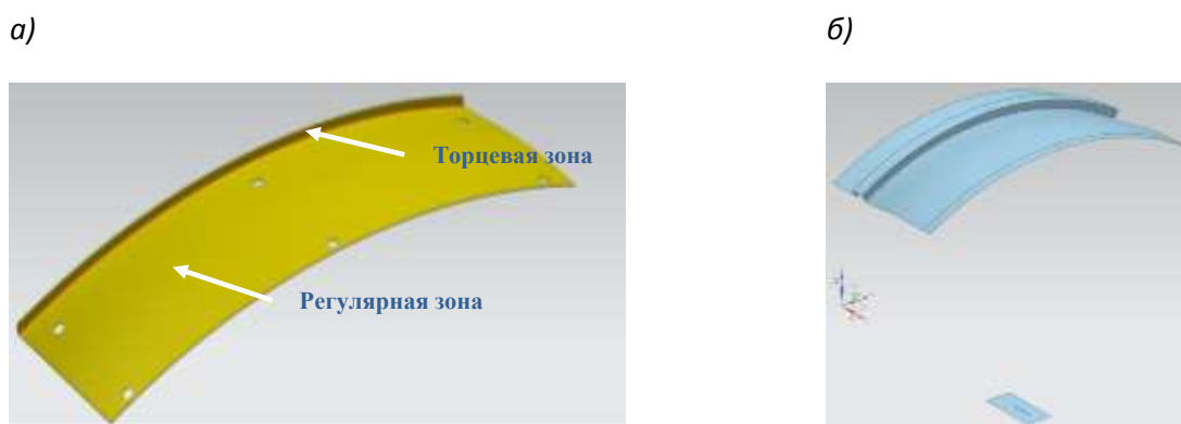
Рис. 1 – Твердотельная (а) и технологическая (б) модель нижней обшивки панели с системой координат «Rosette»
