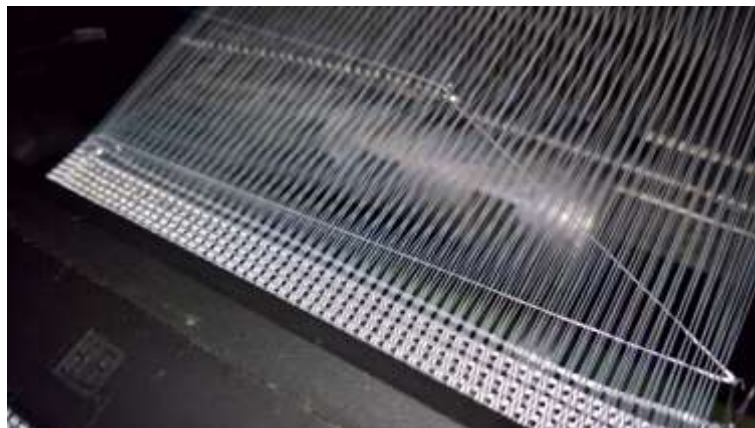
Рис. 2 – Зона формирования ленты на бесчелночном лентоткацком станке
