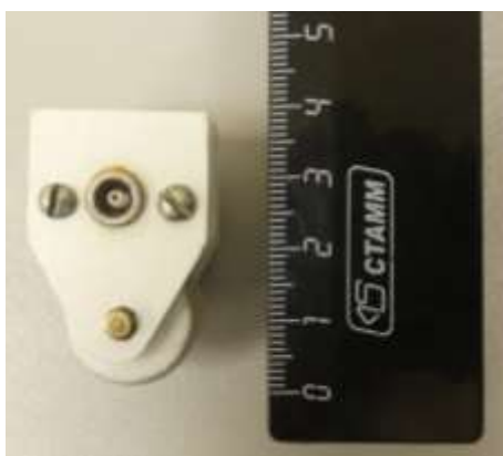
Рис. 5 – Общий вид прототипа малогабаритного катящегося ПЭП
