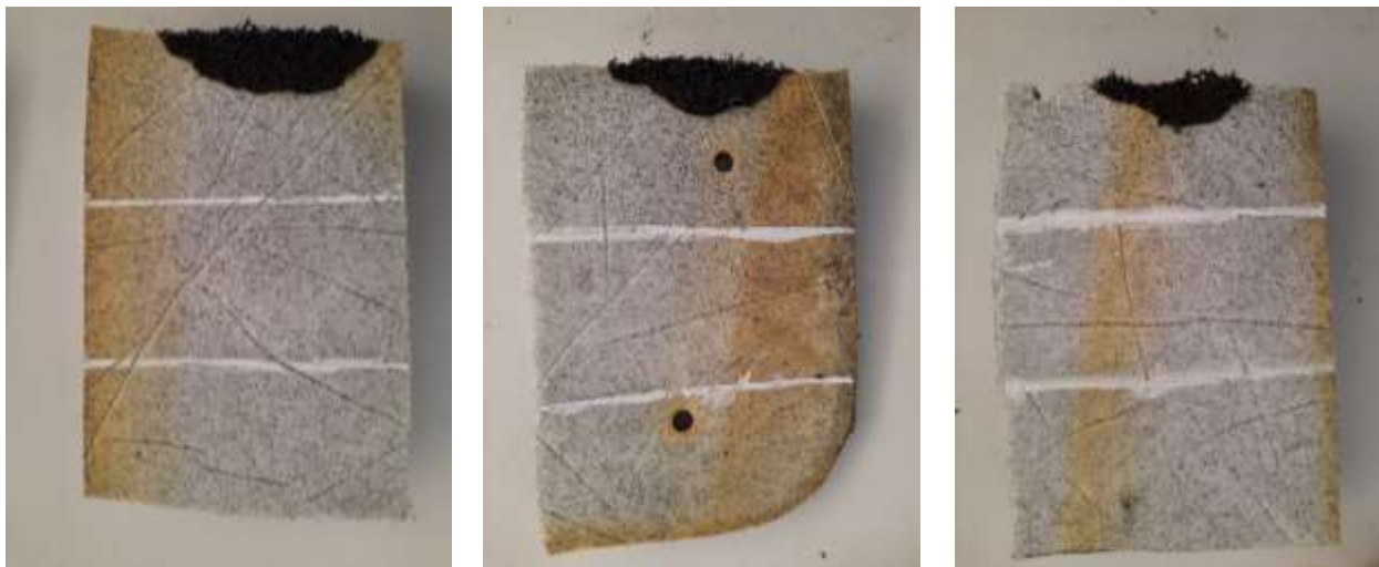
Рис. 1 – Внешний вид образцов ППУ с терморасширяющимся графитом после испытаний на огнеопасность
