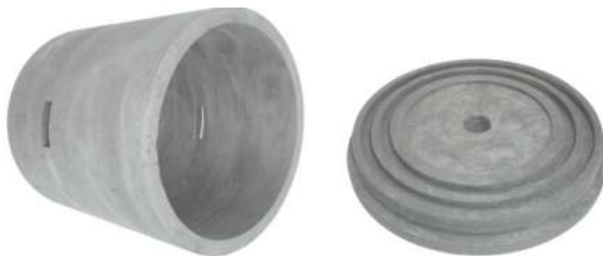
Боковая теплоизоляция и крышка из жёсткого войлока для установки роста монокристалла сапфира по методу Степанова
