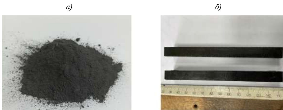
Рис. 1 – Пресс-волокнит после экструзии (а), образцы ПКМ после прессования (б)
