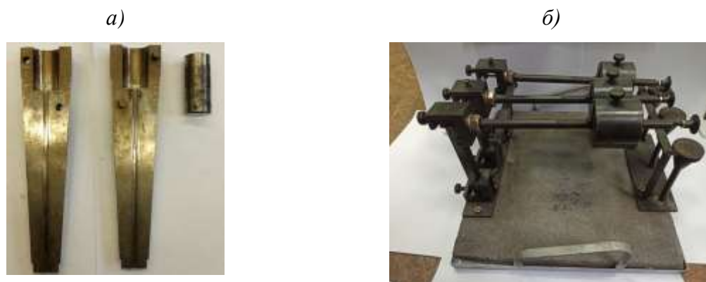
Рис. 2 – Пресс-форма Рашига для определения текучести пресс-волоконитов (а); установка для определения теплостойкости ПКМ по Мартенсу (б)
