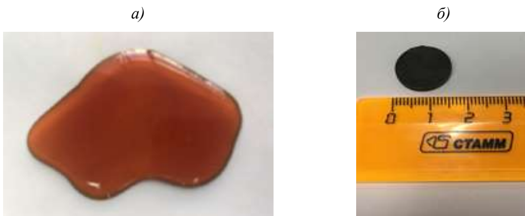
Рис. 3 – Внешний вид связующего а) до отверждения, б) после отверждения (образец для исследований)
