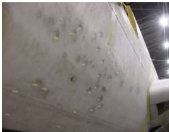
Рис. 1 – Наличие различных вмятин на фюзеляже самолетах фирмы Boeing: а) общий вид, б) схема анализа 28 ЛА [7]
