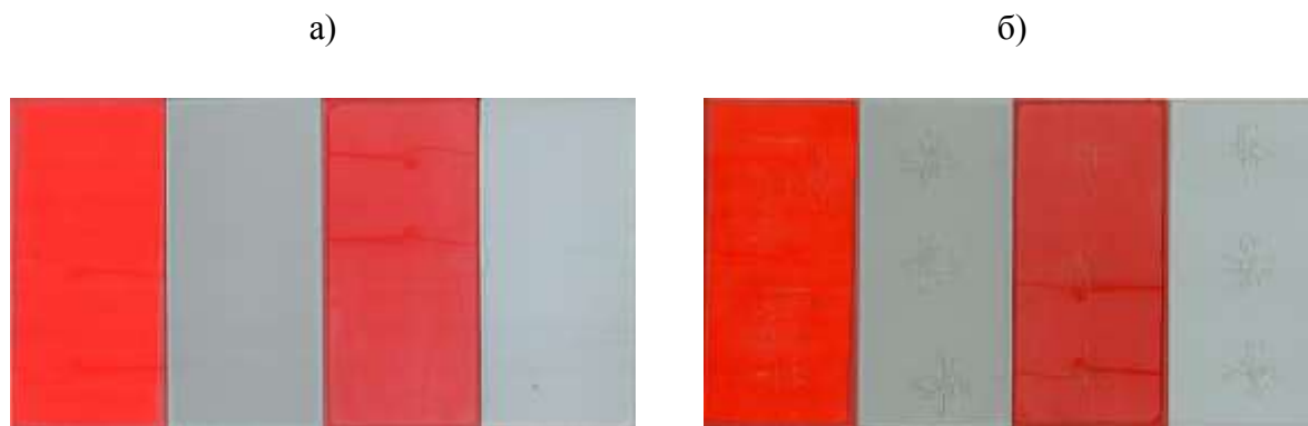
Рис. 4 – Внешний вид лицевой стороны образцов ЛКП а – после испытаний, б – после определения адгезии
