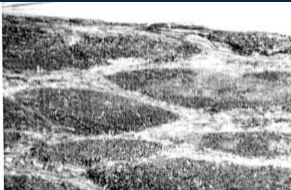
Рис. 6 - Углеродный композит на срезе после прессования с предварительной модификацией волокнистого наполнителя (x100)
