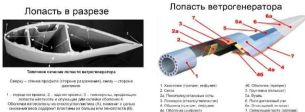
Рис. 1 – Конструкция лопасти ветрогенератора
