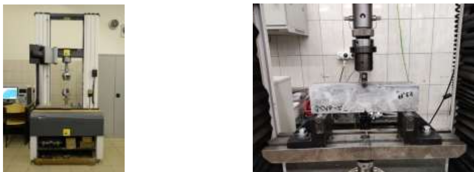
Рис. 1 – Испытательная машина Instron 3382 (слева) вместе с испытательным образцом (справа)
