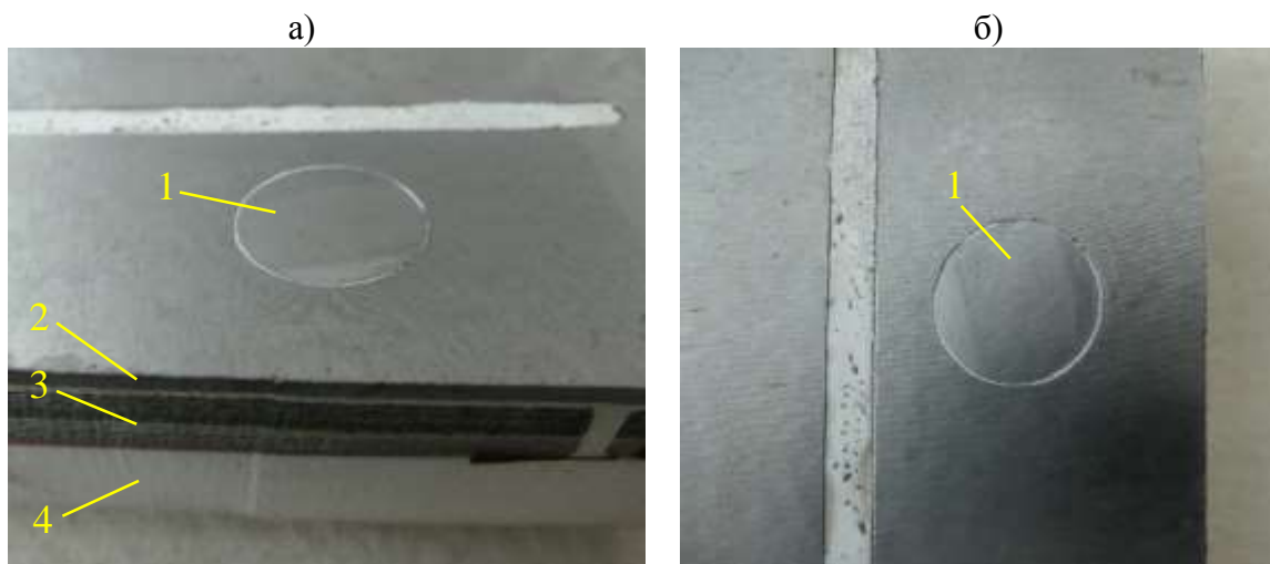
Рис. 8 – Фотографии вклеенной заглушки: вид с боку (а) и сверху (б). 1 – заглушка с искусственным непрочлеем, 2 – шпангоут, 3 – теплозащитный экран, 4 – керамическая оболочка
