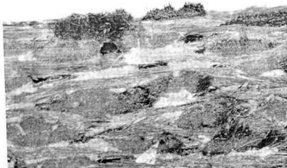
Рис. 5 - Углепластиковый композит на срезе после прессования по штатной технологии (x100)
