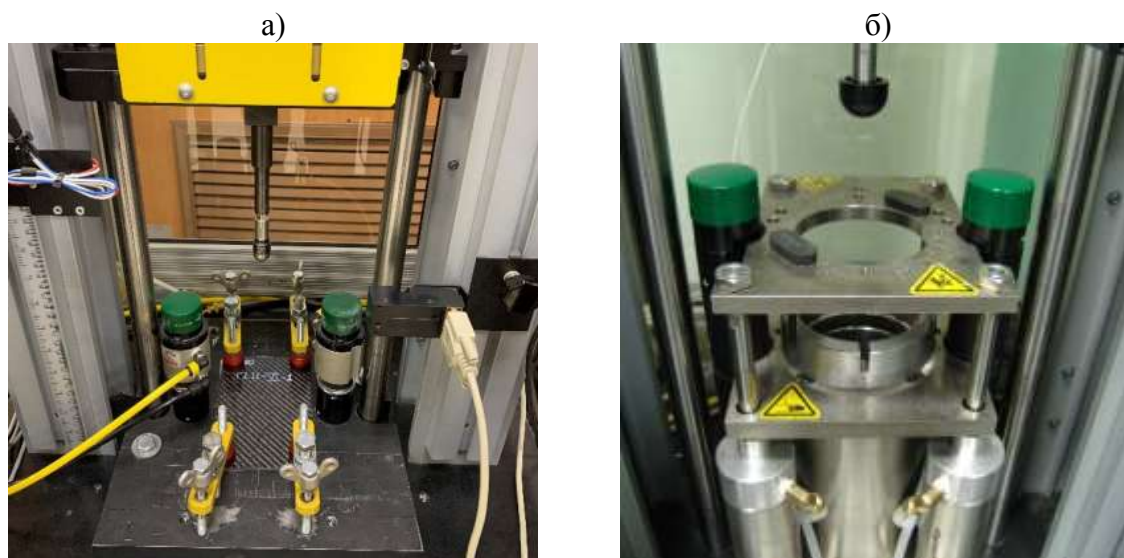
Рис. 3 – Общий вид испытательного стенда с оснасткой для испытаний стандартных образцов (а) и интегральных панелей (б)
