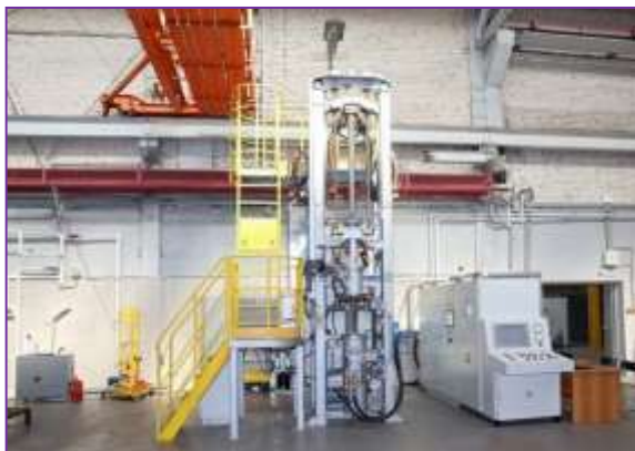
Рис. 1 – Установки НИЦ «Курчатовский институт» - ВИАМ для проведения электрошлакового переплава под давлением ДЭШП-0,1 (а) и вакуумной химико-термической и термической обработки MonoTherm НК.446.VC.10.gr (б) [13, 19]
