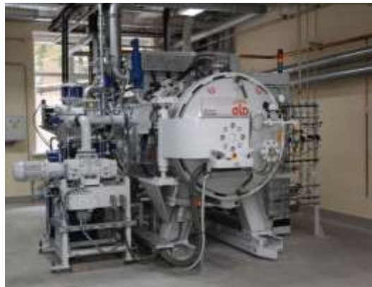
Рис. 1 – Установки НИЦ «Курчатовский институт» - ВИАМ для проведения электрошлакового переплава под давлением ДЭШП-0,1 (а) и вакуумной химико-термической и термической обработки MonoTherm НК.446.VC.10.gr (б) [13, 19]
