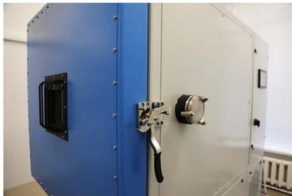
Рис. 7 – Камера пониженного атмосферного давления
