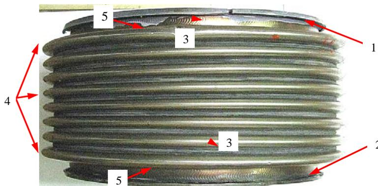
Рис. 1 – Внешний вид компенсатора. Стрелками показаны: 1, 2 – кольца фланцев, 3 – сварные швы, 4 – гофры сильфона, 5 – изгибы гофра. Уменьшено
