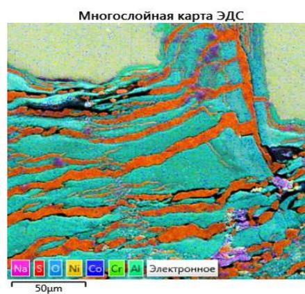
Рис. 9 – Вид микроструктуры (продуктов коррозии) образцов после испытания в смеси солей
