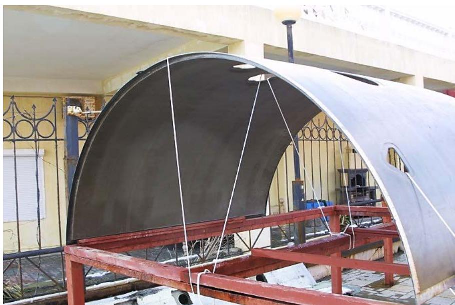
Рис. 11 – Испытания створки мотогондолы самолета Ту-204СМ в открытых климатических условиях
