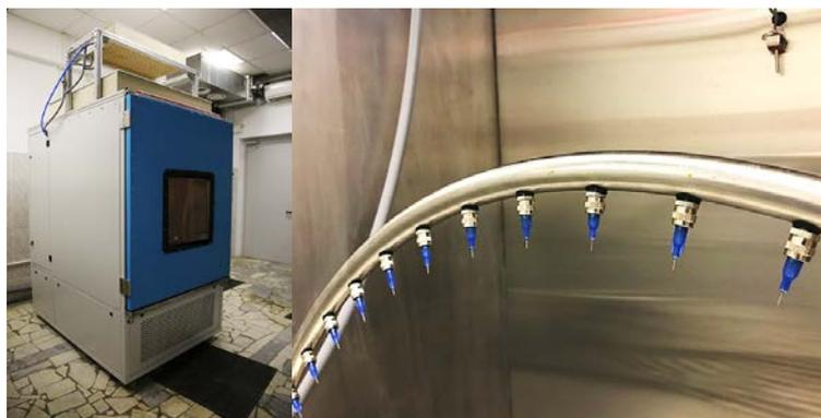
Рис. 5 – Камера дождя
