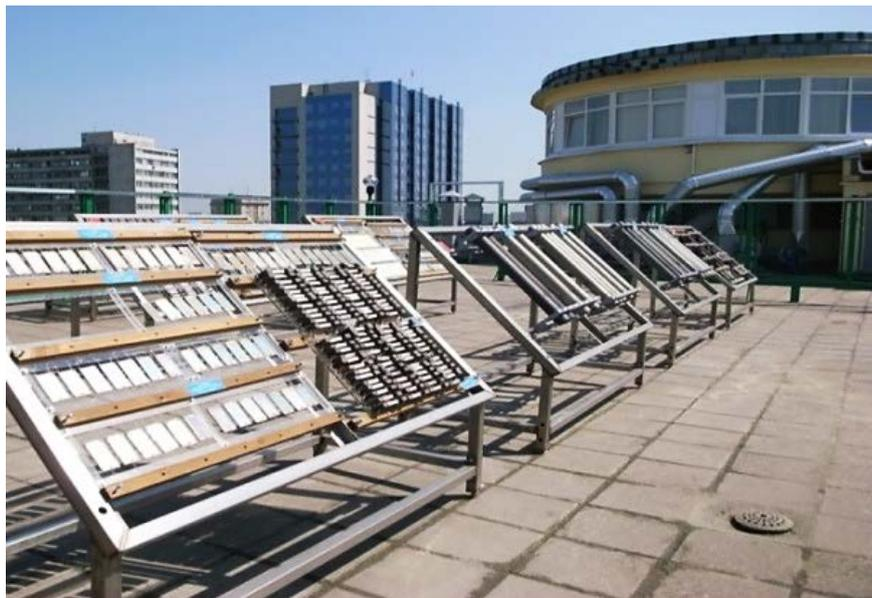
Рис. 15 – Внешний вид атмосферной испытательной площадки МЦКИ. Атмосферная площадка МЦКИ ВИАМ оснащена 27 атмосферными стендами для экспонирования образцов под углом 45 градусов к горизонту, 6 горизонтальными стендами для испытаний элементов конструкций, стендом слежения за солнцем, камерой под органическим стеклом для испытаний материалов интерьера, жалюзийным хранилищем и навесом, что позволяет испытывать одновременно до 2000 образцов
