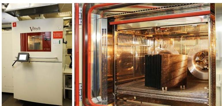
Рис. 4 – Камера термоудара
