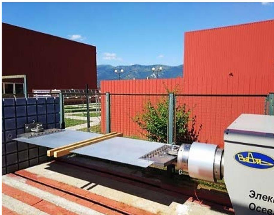
Рис. 14 – Горизонтальный стенд для испытаний листов и крупногабаритных элементов. Допустимые размеры образцов до 15000×4500×800 мм; максимальная нагрузка ±1000 кН; ход поршня составляет ±600 мм; диапазон скоростей испытания от 0,001 до 300 мм/мин
