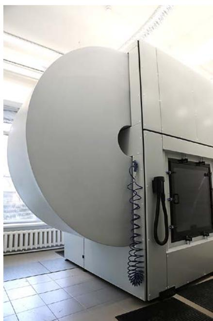
Рис. 6 – Камера для испытаний статической и динамической пылью
