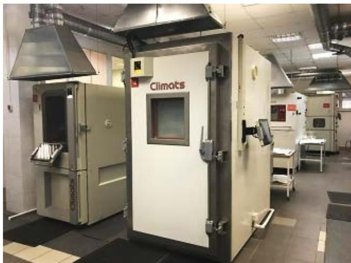
Рис. 1 – Камера для термовлажностных испытаний
