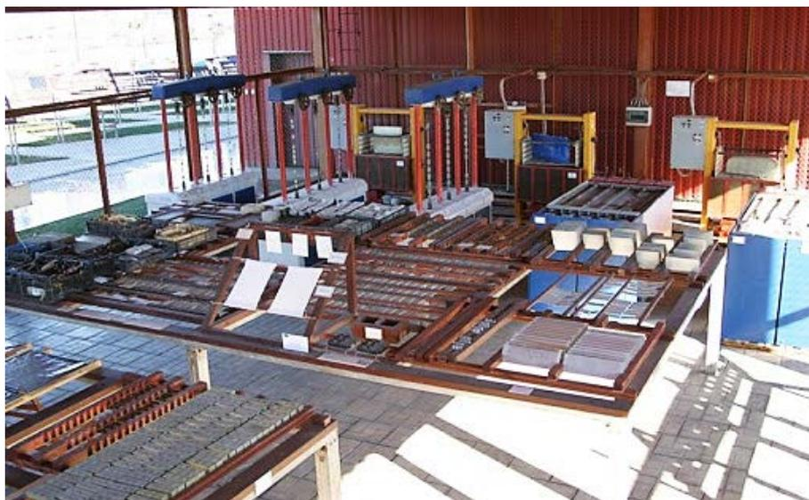
Рис. 10 – Экспонирование материалов и конструктивных элементов под навесом
