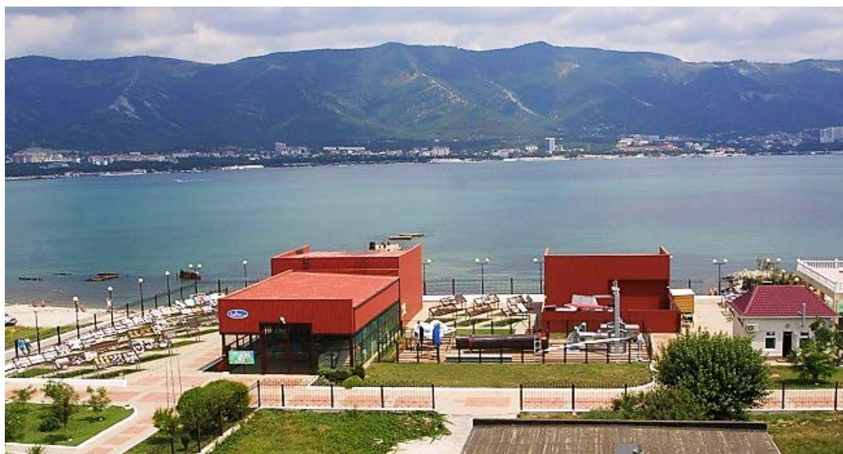
Рис. 8 – Общий вид климатической испытательной площадки ГЦКИ. На атмосферной площадке расположено 29 атмосферных стендов для экспозиции образцов под углом 45 градусов к горизонту, 7 горизонтальных стендов для испытаний элементов конструкций, жалюзийное хранилище, навес и неотапливаемый склад для имитации хранения, что позволяет испытывать до 10 000 образцов одновременно.
