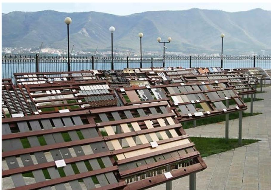
Рис. 9 – Испытательные стенды для экспонирования ПКМ на открытой площадке
