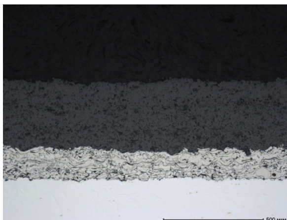
Рис. 5в – Теплозащитное покрытие (Me-Cr-Al-Y) + ZrO_2 - Y_2O_3
