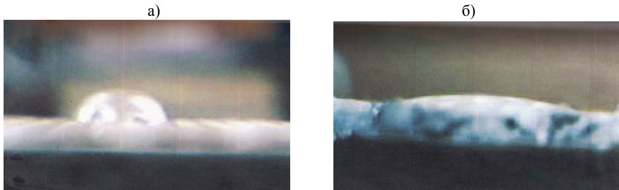
Рис. 1 – Растекание капли по СВМПЭ поверхности до (а) и после (б) обработки в потоке низкоэнергетических ионов [4]
