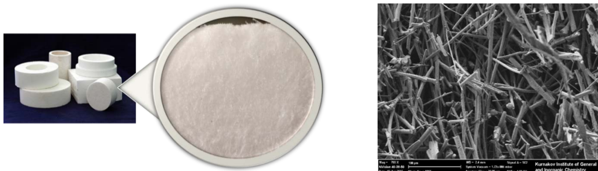
Рис. 1 – Изображения образцов ТЗМК и их строения по данным растровой электронной микроскопии
