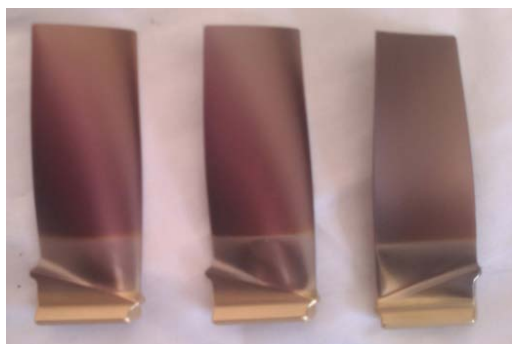
Рис. 1в – Внешний вид лопаток 1 ступени вертолетного двигателя с покрытиями TiN/CrN (перо) и Ti+TiN (замок лопатки)
