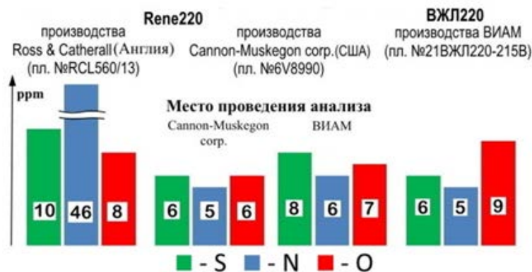
Рис. 7 – Содержание примесей серы, кислорода и азота в сплаве ВЖЛ220 производства ВИАМ и его зарубежном сплаве-аналоге Rene220 производства Cannon-Muskegon corp. (США)
