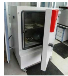
Климатическая камера для микробиологических испытаний образцов материалов и изделий
