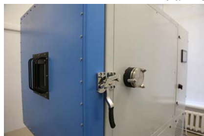
Климатическая камера для имитации годового цикла с системой излучения с металлогалогеновой лампой
