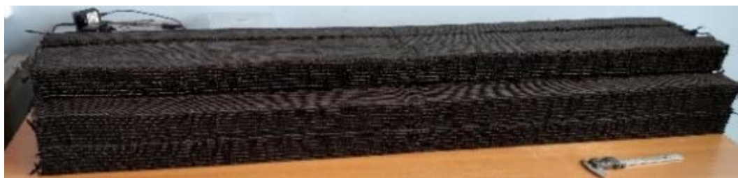
Рис. 1 – Заготовка, изготовленная методом вакуумной инфузии
