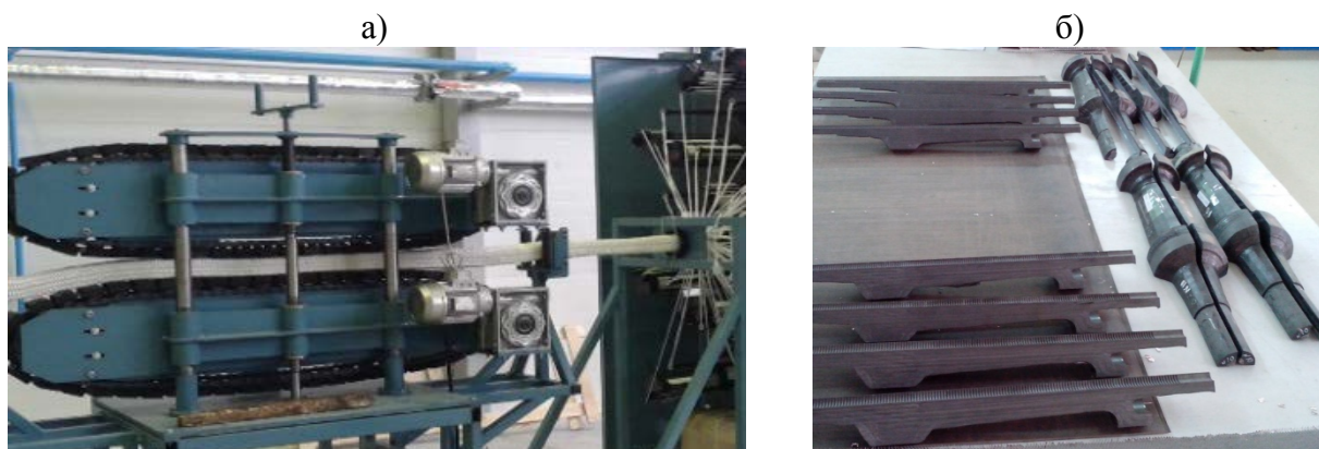
Рис. 5 – Технология объемного плетения: а) установка объемного плетения заготовок наполнителя из углеродных волокон (2015 г., ОНПП "Технология"); б) углепластиковые конструкции сверхвысокой прочности на основе трехмерно армированных заготовок
