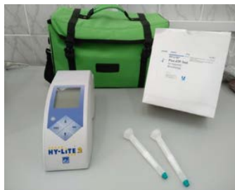
Система экспресс- определения микробиологического поражения топлива HY-LITE
