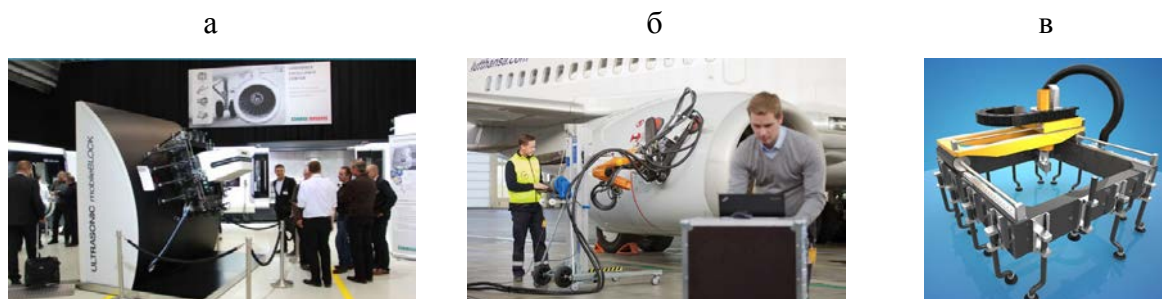
Рис. 3 – Автоматизированные и роботизированные устройства для подготовки зоны ремонта а – ULTRASONIC mobileBLOCK DMG; б – CAIRE; в – AGFM's (PS/CRS)
