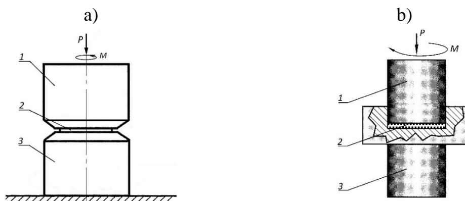
Рис. 1 – Схема кручения диска под давлением: а) в открытых бойках; б) в закрытых бойках; 1, 3 – бойки, 2 – диск
