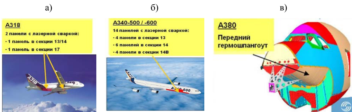
Рис. 1 – Применение панелей, выполненных лазерной сваркой, в конструкциях современных воздушных судов компании Airbus: (а) А318, (б) А340, (в) А380
