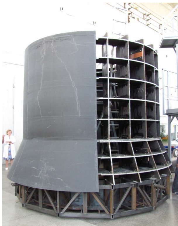
Рис. 2 – Углепластиковый каркас с сегментом оболочки
