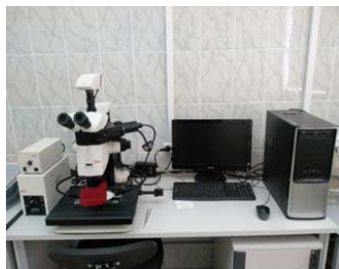
Стереомикроскоп Leica M165FC с флуоресцентным блоком
