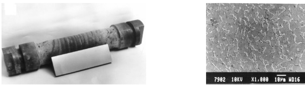
Рис. 4 – Образец из жаропрочного сплава ВТ9, подвергнутый растяжению с кручением на стане для раскатки дисков и его макротемплет с однородной ультрамелкозернистой структурой
