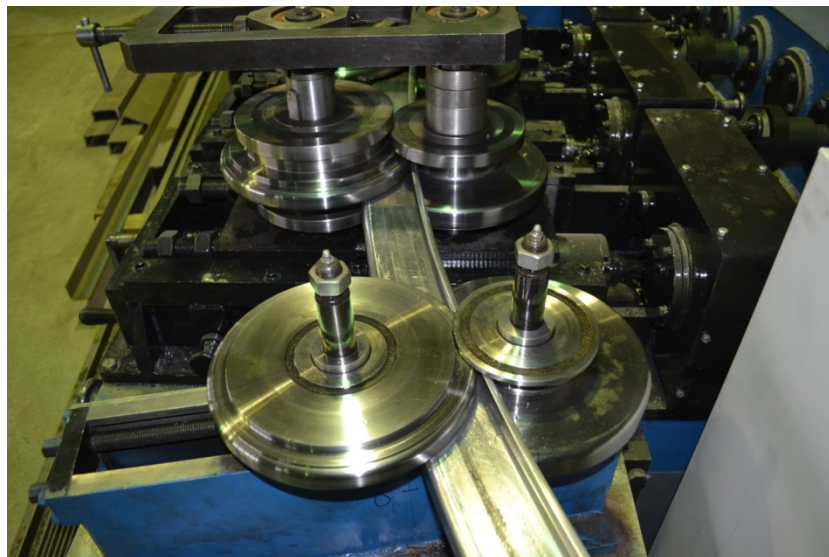
Рис. 5 – Фотографии процесса профилирования детали «Шпангоут»
