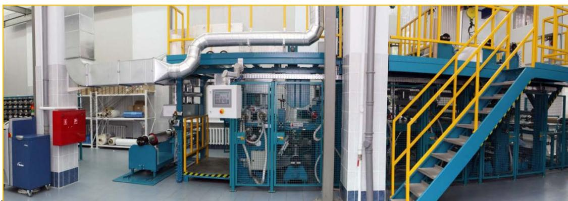
Рис. 1 – Установка, предназначенная для изготовления препрега
