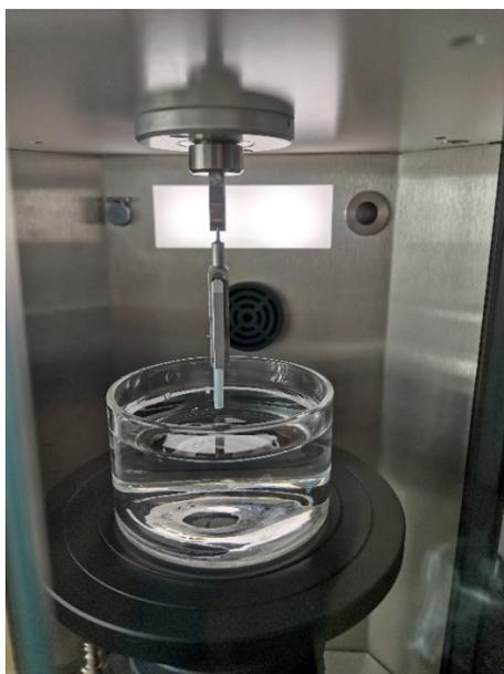
Рис. 7 – Измерения методом Вашбурна на тензиометре К-100
