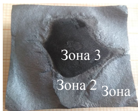
Рис. 1 – Поверхность разрушения образца из РСКК с характерными областями:
