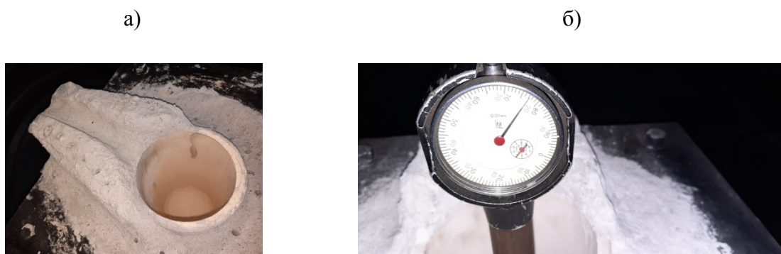
Рис. 3 – Вставной тигель в составе плавильного узла (а) и замер рабочей поверхности нутромером (б)
