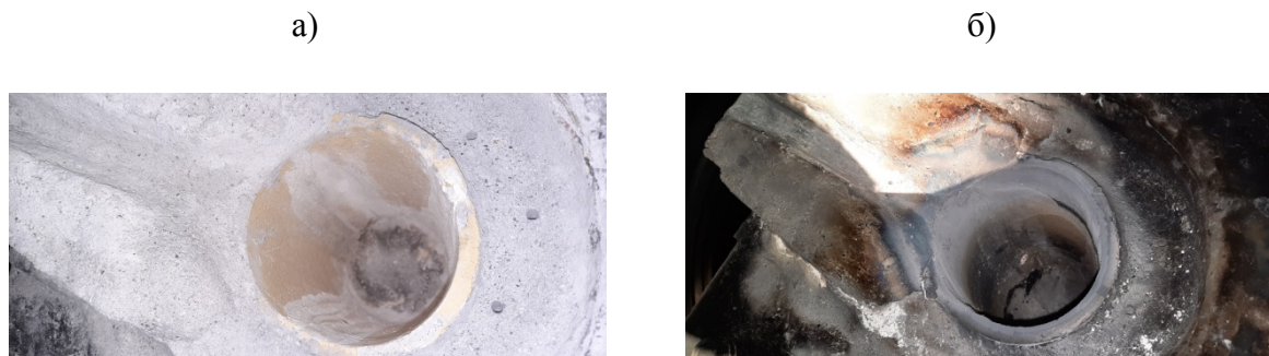
Рис. 10 – Вставной плавильный тигель после набивки в составе плавильного узла (а) и после проведения промывной плавки сплавом на основе железа
