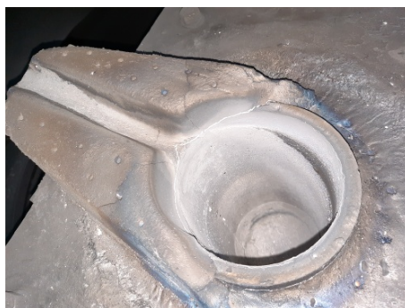
Рис. 4 – Вставной плавильный тигель после промывной плавки
