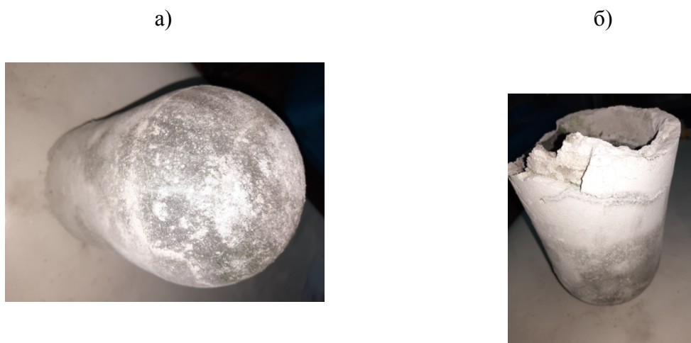
Рис. 9 – Плавильный тигель после проведения 17 плавок: (а) – донная часть тигля, (б) – верхняя часть тигля
