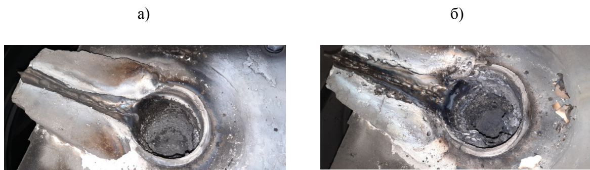
Рис. 11 – Плавильный тигель после выплавки сплавов лигатуры системы РЗМ-Zr (плавки № 2 (а) и № 11 (б) от набивки), соответственно
