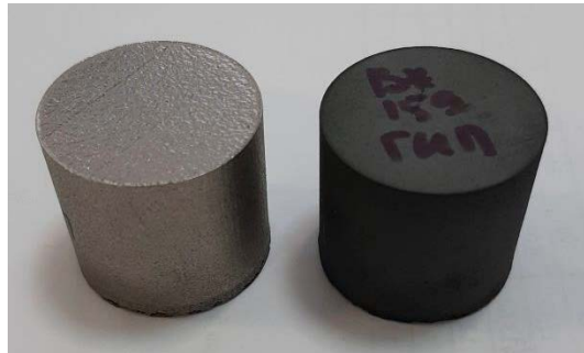
Рис. 6 – Фото образцов-свидетелей полученных из МПК сплава ВЖ159 после СЛС и после СЛС+ГИП+ТО
