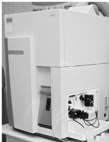
Рис. 3 – Масс-спектрометр с индуктивно связанной плазмой «iCAP Qc»
