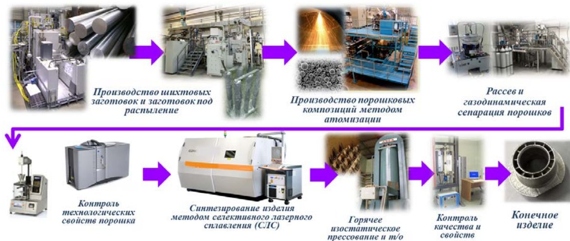
Рис. 1 – Схема изготовления изделий с использованием аддитивных технологий
