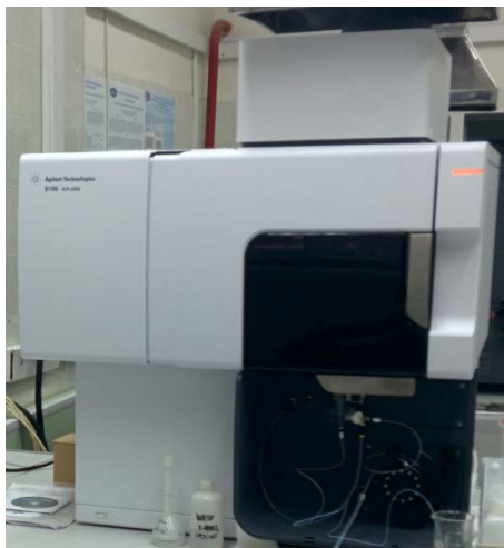
Рис. 2 – Спектрометр Agilent 5100 (ИСП-АЭС).
