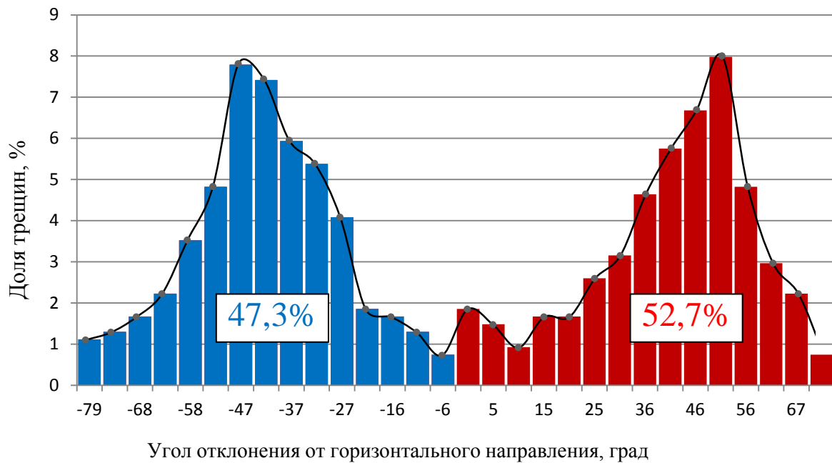
Рис. 8 – Распределение трещин по их ориентации в плоскости шлифа.
