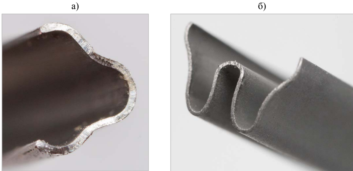
Рис. 3 – Поперечный профиль уплотнений: а – «U»-образный; б – «W»-образный
