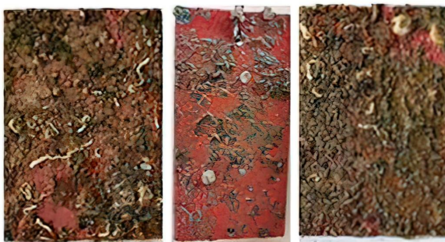
Рис. 2 – Неравномерное оседание обрастателей, связанное с неоднородным химическим составом поверхностного слоя антиадгезионных составов
