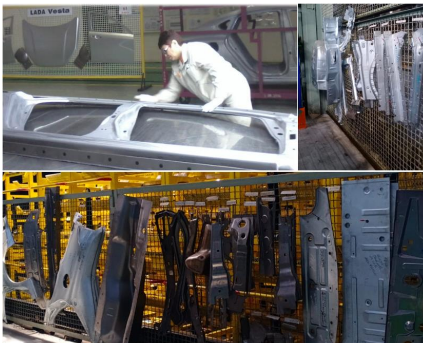
Рис.10 – Анализ состояния деталей после полной разборки кузова автомобиля
