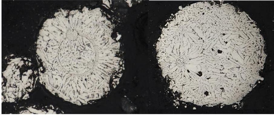
Рис. 1 – Металлографическая структура ГРП фракции (+120, –240) мкм тройного сплава стехиометрии Fe 78 Nd 15 B 7
