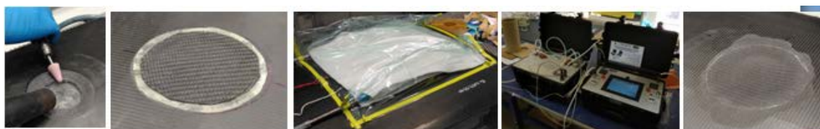
Рис. 6 – Ремонт конструкции из ПКМ вертолетной техники
