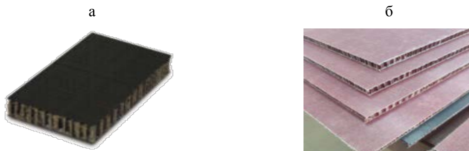
Рис. 7 – Заготовки панелей пола самолета Ил-114-300: а – заготовка панели пола в подкресельной зоне; б – заготовка панели пола в зоне проходов/выходов сервисной зоны
