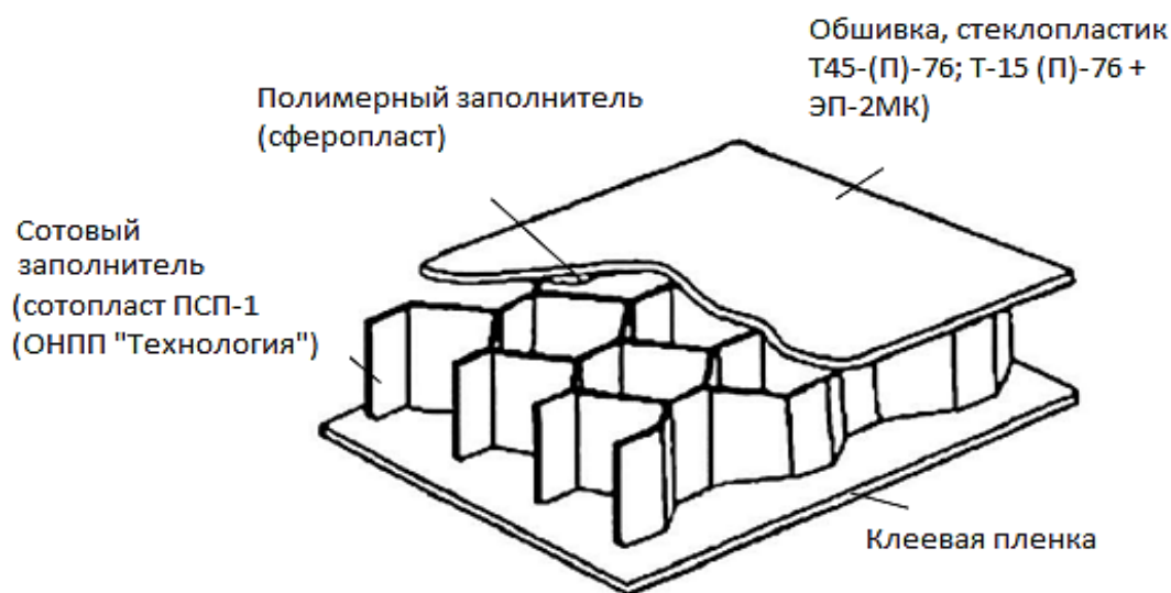
Рис. 1 – Трехслойные сотовые панели с обшивками из ПКМ на основе ЭП-2МК
