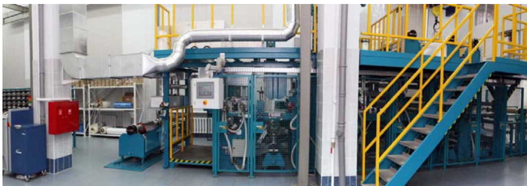
Рис. 2 – Установка, предназначенная для изготовления препрегов/семипрегов
