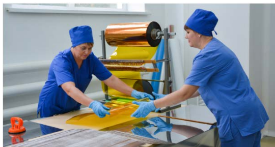
Рис. 13 – Участок раскроя, выкладки и сборки технологических пакетов «чистая комната»
