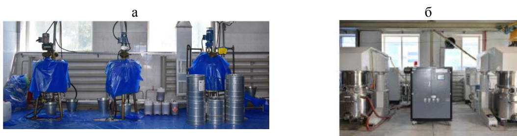
Рис. 11 – Участки изготовления связующих: а – растворных связующих; б – расплавных связующих
