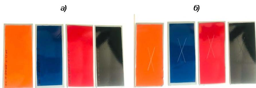
Рис. 12 – Внешний вид образцов ЛКП: а) в исходном состоянии; б) после экспозиции в камере солевого тумана с постоянным распылением 5%-го раствора NaCl при температуре 35 °С в течение 30 суток
