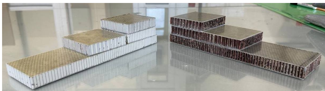
Рис. 4 – Трехслойные сотовые панели на основе экспериментальной композиции связующего
