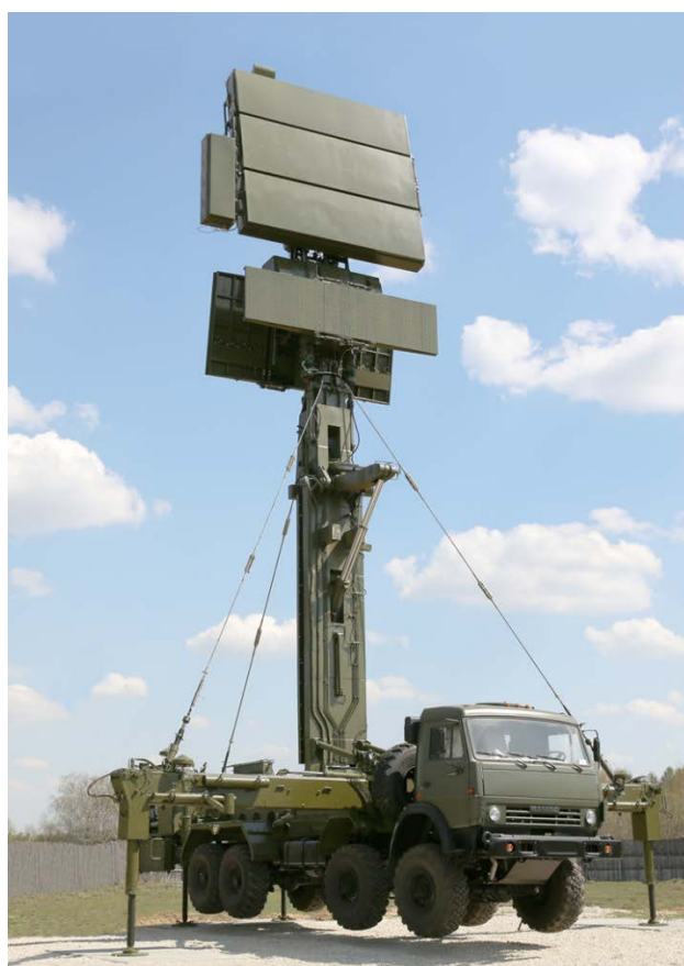
Рис. 2 – Мобильная радиолокационная станция «Подлёт-К1»
