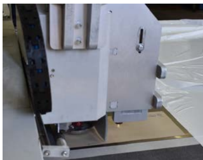
Рис. 10 – Обработка листового стеклопластика плазмой атмосферного давления
