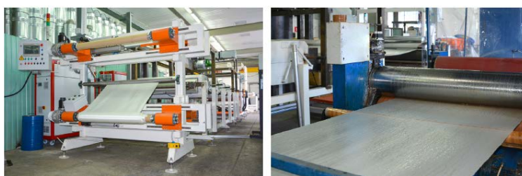
Рис. 12 – Участок изготовления препрегов на основе растворных связующих
