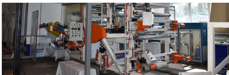
Рис. 17 – Линия по изготовлению препрегов марок КМКС
