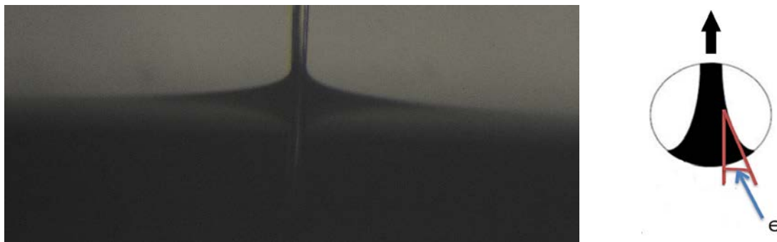
Рис. 3 – Смачивание стеклянного моноволокна, погруженного в смолу L
