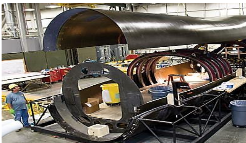
Рис. 1 – Изготовление с использованием семипрега для элемента фюзеляжа грузового транспортного самолета
