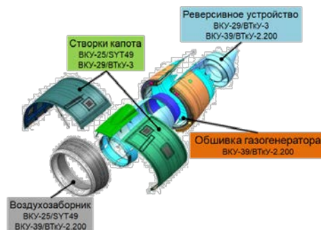
Рис. 5 – Элементы конструкции мотогондолы ПД-14
