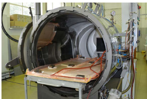
Рис. 15 – Участок вакуум-автоклавного формования
