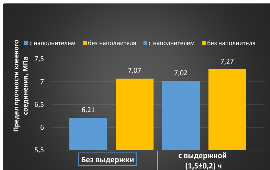
Рис. 5 – Зависимость прочности клеевого соединения от состава клеевой композиции
