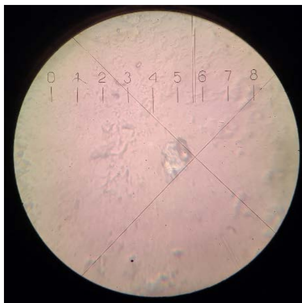
Рис. 3 – Отпечаток от четырехгранной пирамиды на контрольном образце.
