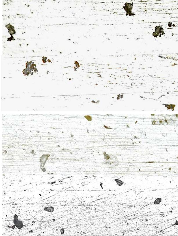
Рис. 3. Примеры загрязнения стали трубы (аналог РФ 10Г2) оксисиликатами недеформированными – включениями 5-го балла шкалы «СН» ГОСТ 1778
