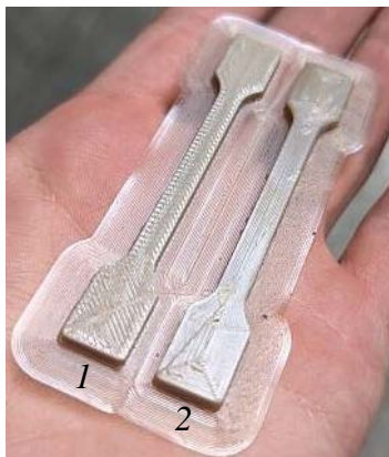
Рис. 11. Лопатки 1 и 2, полученные 3D-печатью из чистого ПЭЭК
