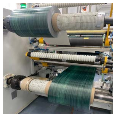
Рисунок 2 – Фотографии основных этапов изготовления препрега углепластика марки ВКУ-73: а – изготовление пленки связующего, б – совмещение связующего с наполнителем, в – разрезка препрега на ленты
