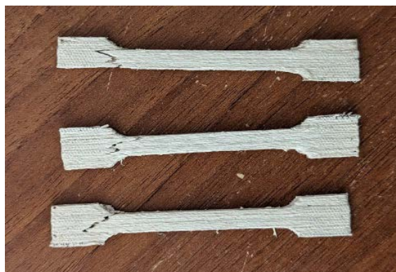
Рис. 18. Результат печати «ребром» образцов лопаток филаментом состава ПЭЭК60/ЖКП40 (лопатки сфотографированы после проведения испытаний на растяжение)
