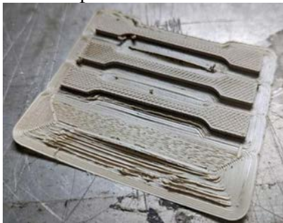
Рис. 15. Результат печати образцов лопаток филаментом состава ПЭЭК80/ЖКП20
