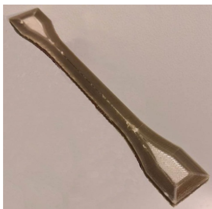
Рис. 9. Аморфные края и расслоения лопатки из чистого ПЭЭК
