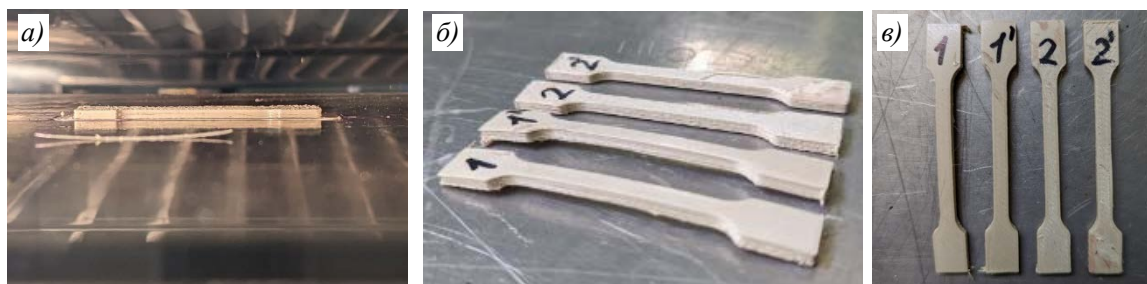
Рис. 13. Результат печати образцов лопаток филаментом состава ПЭЭК60/ЖКП40
