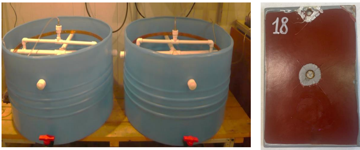
Рис. 3. Установка гальваностатическая катодная (УГК) и образец для оценки совместимости покрытия с катодной защитой.
