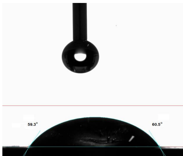
Рисунок 6 – Измерение краевого угла смачивания на поверхности стеклопластика после натуральных испытаний в МЦКИ (а) и ГЦКИ (б) в течение 12 месяцев.
