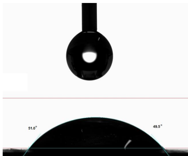
Рисунок 6 – Измерение краевого угла смачивания на поверхности стеклопластика после натуральных испытаний в МЦКИ (а) и ГЦКИ (б) в течение 12 месяцев.
