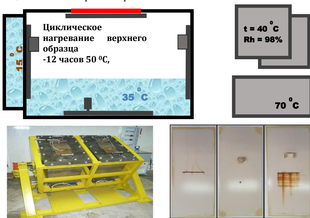
Рис. 5. Испытательный стенд «качающийся танк» и образцы после испытаний.
