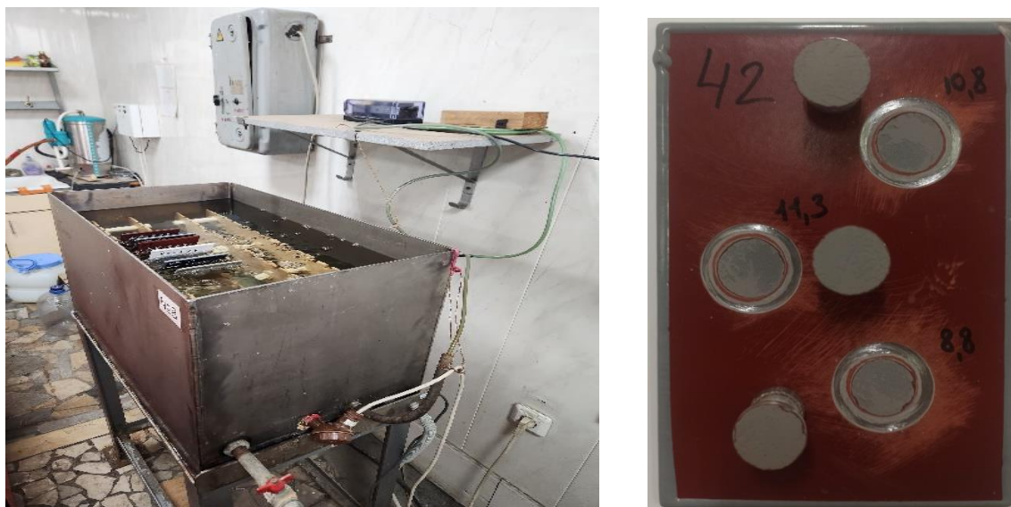
Рис. 2. Установка гидроаэрационная УИП и образец для оценки адгезионной прочности после испытаний.
