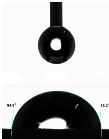
Рисунок 5 – Измерение краевого угла смачивания на поверхности стеклопластика в исходном состоянии
