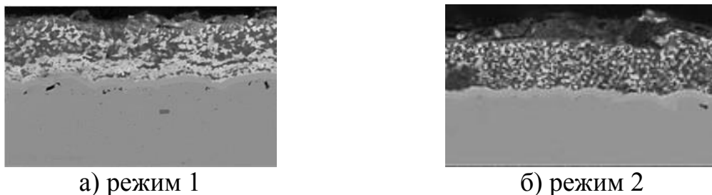
Рисунок 2 – Микроструктура покрытия сплавом олово-цинк О-Ц(80)9, полученного при различных режимах осаждения
