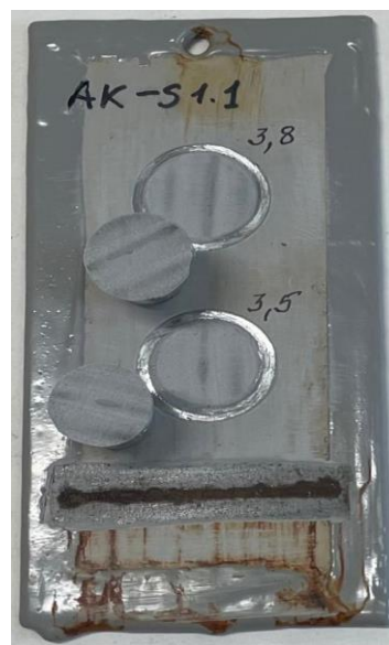
Рис. 1. Камера соляного тумана и образец после испытаний на распространение коррозии от надреза.
