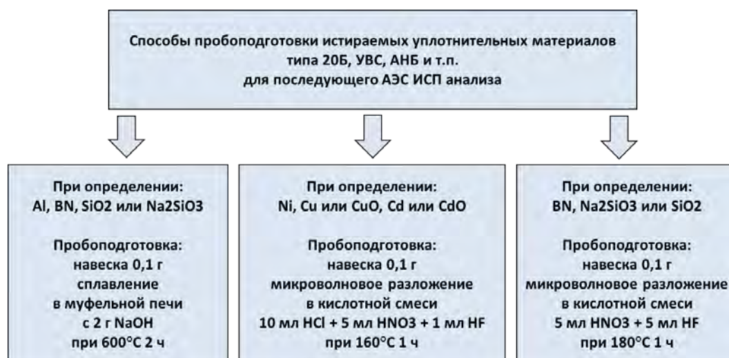
Рисунок 2. Способы пробоподготовки истираемых уплотнительных материалов типа 20Б, УВС, АНБ и т.п. для последующего АЭС ИСП анализа
