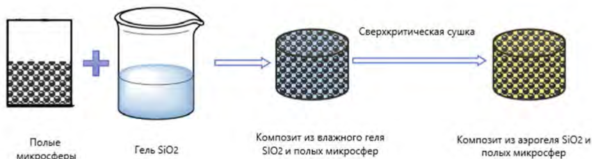
Рисунок 1 – Схема получения композита из аэрогеля SiO 2 и полых микросфер
