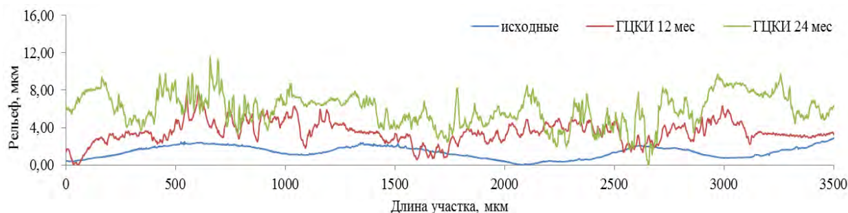
Рис.2 – изменение рельефа поверхности после натурального старения в ГЦКИ.
