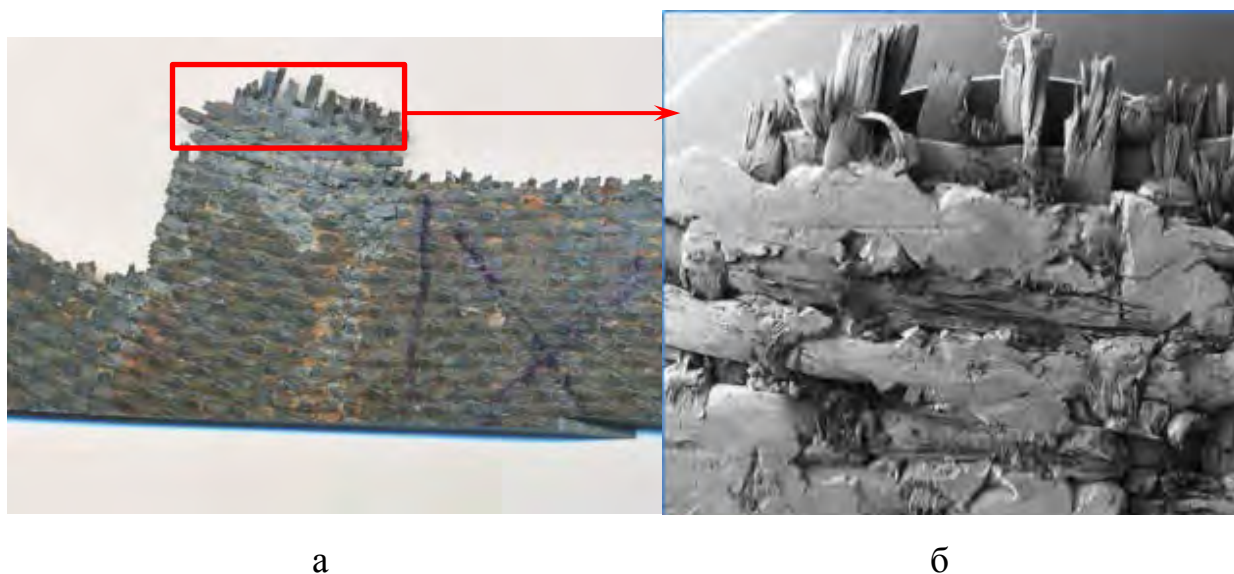
Рисунок 12 – Исследование разрушения широкохордных лопаток из ПКМ: а – общий вид места разрушения; б – разрушение матрицы и волокна
