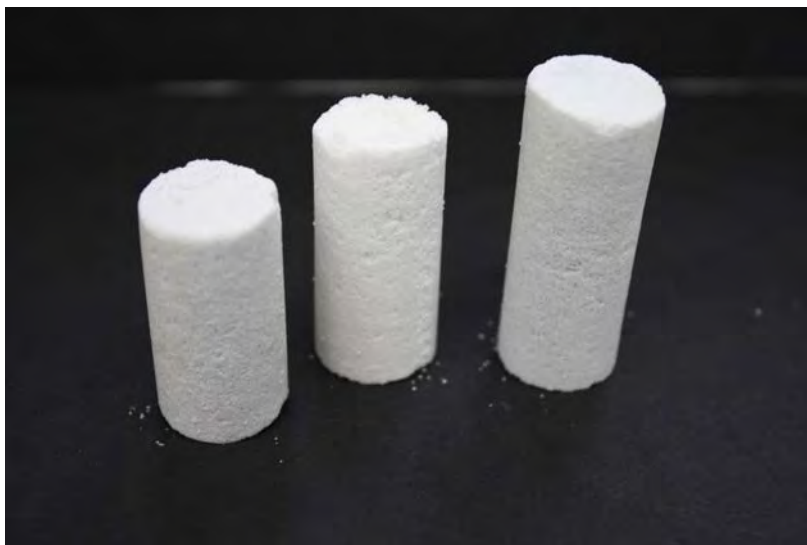
Рисунок 2 - Теплоизоляционный материал на основе аэрогеля SiO 2 и микросфер из вулканического стекла
