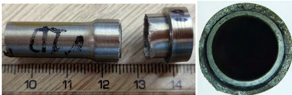
Рис. 2 – Общий вид разрушенного трубопровода
