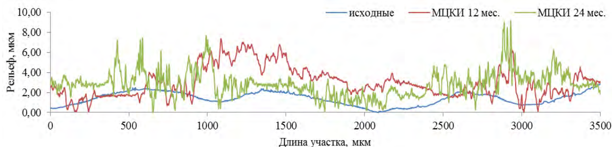
Рис.1 – изменение рельефа поверхности после натурального старения в МЦКИ.
